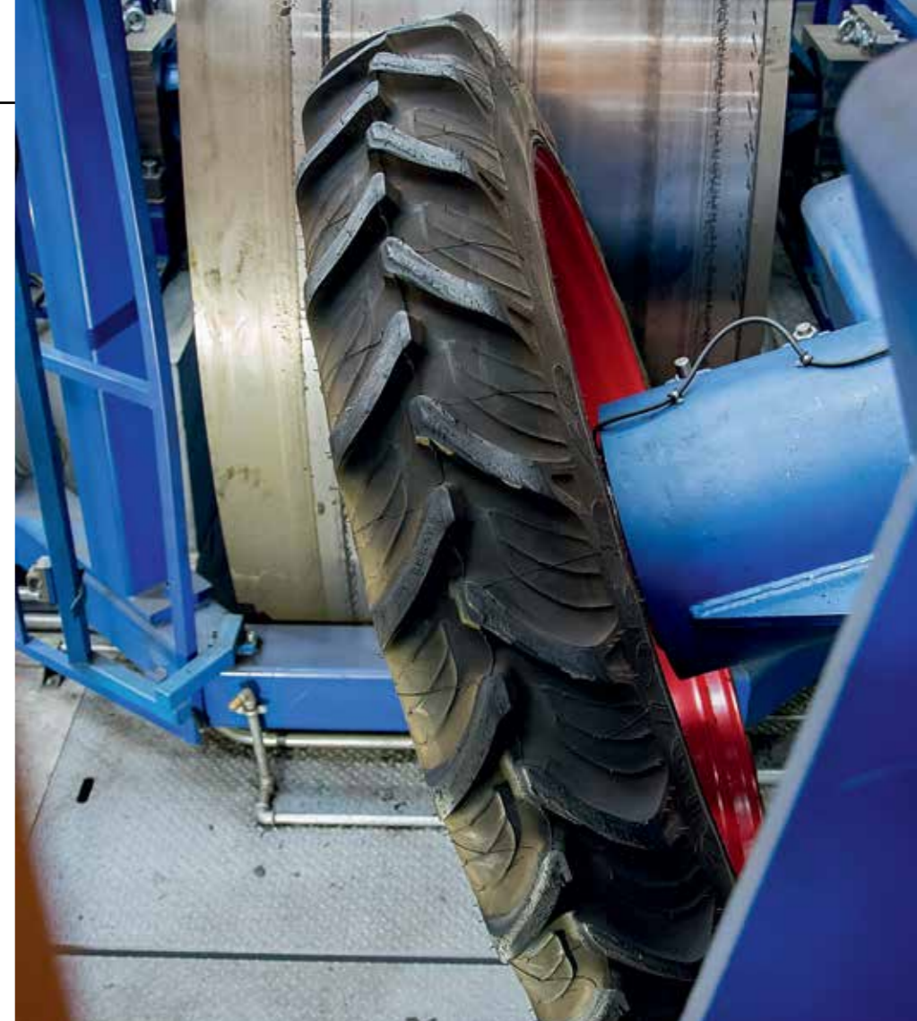
↑ Badanie wytrzymałości zmęczeniowej koła na obciążenia promieniowe
