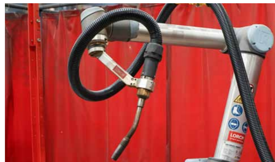
↑ Specjalny palnik spawalniczy z bardzo efektywnym systemem chłodzenia
