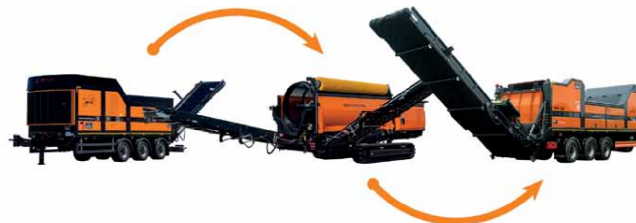
↑ Mobilną linię technologiczną tworzą trzy maszyny: rozdrabniacz przystosowany do wstępnego rozdrabniania, przesiewacz oraz rozdrabniacz końcowy z zamontowanym wałem o specjalnej konstrukcji do produkcji RDF-u
