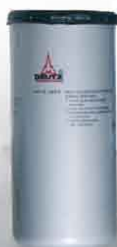
Filtr paliwa stosowany w ciągnikach PRONAR 7150 i 8140
