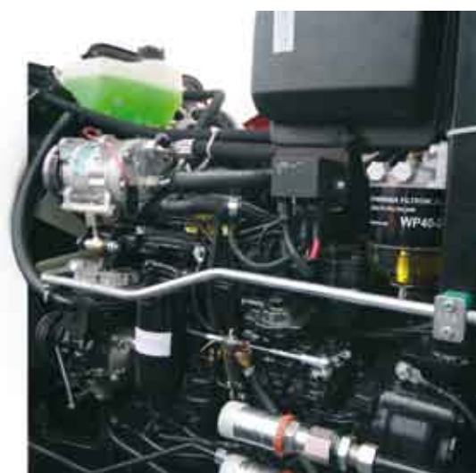
Filtry paliwowe wstępnego i dokładnego oczyszczania paliwa w ciągniku PRONAR 5135
