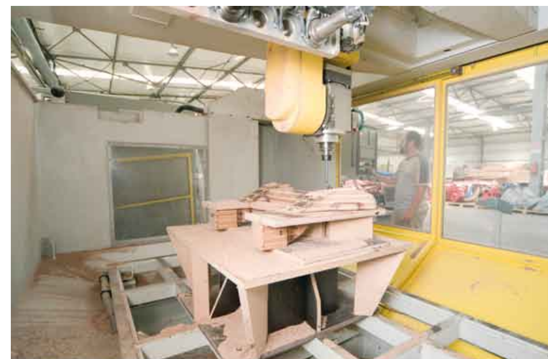
Wykonanie modelu odlewniczego na frezarce CNC 5-osiowej z wykorzystaniem systemu CAD firmy Unigraphics
