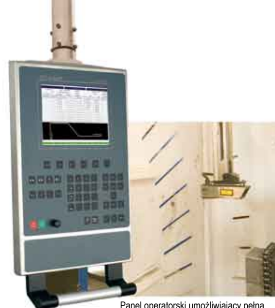
Panel operatorski umożliwiający pełną komunikację operatora z maszyną
