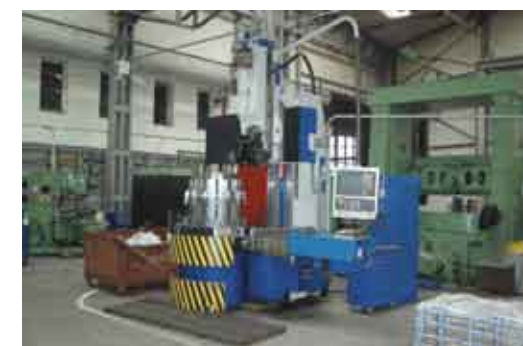
Sterowana numerycznie (dwukanałowo) tokarka pionowa z napędami zwracającymi prąd do sieci podczas hamowania
