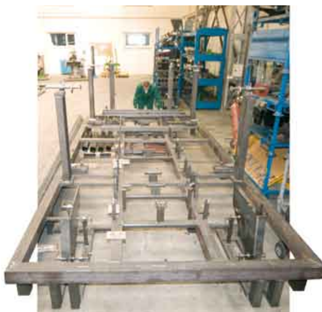
Wykonanie przyrządu spawalniczego
