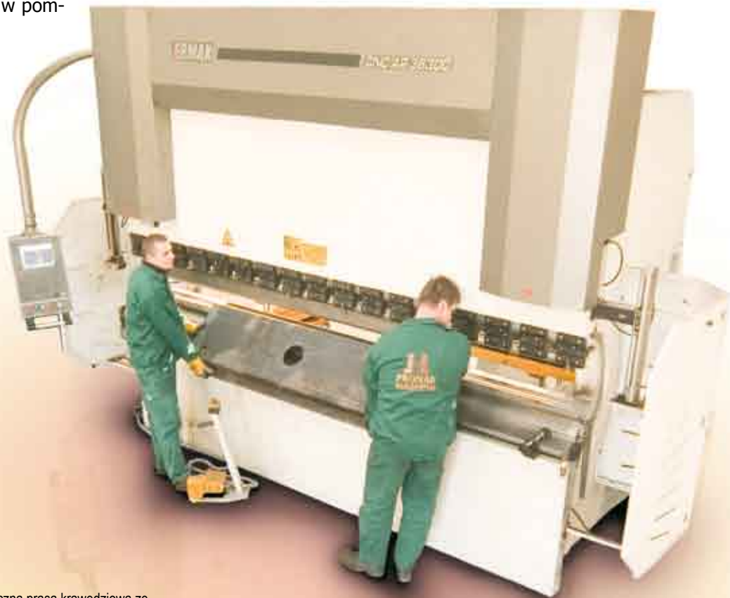
Hydrauliczna prasa krawędziowa ze sterowaniem CNC. Urządzenie służy do krawędziowania blach pod różnym kątem wzdłuż linii narzędzi kształtujących
