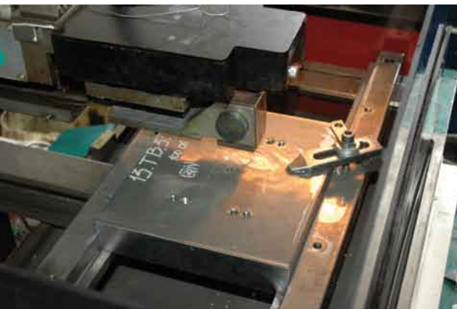
Zabieg wycinania otworu na konwencjonalnej drutowej elektrodrażarce sterowanej komputerem PC
