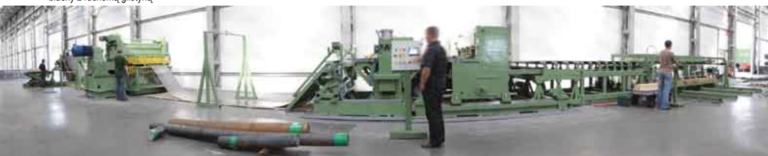
Automatyczna linia do cięcia blachy z ruchomą gilotyną
