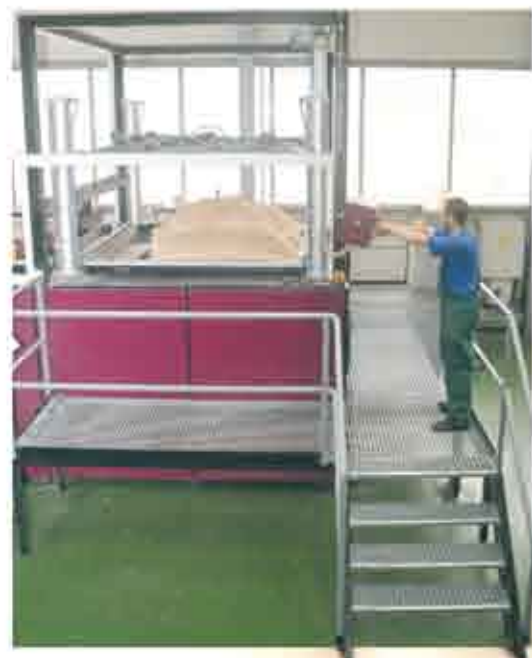
Ustawianie parametrów procesu termoformowania odbywa się za pomocą pulpitu
