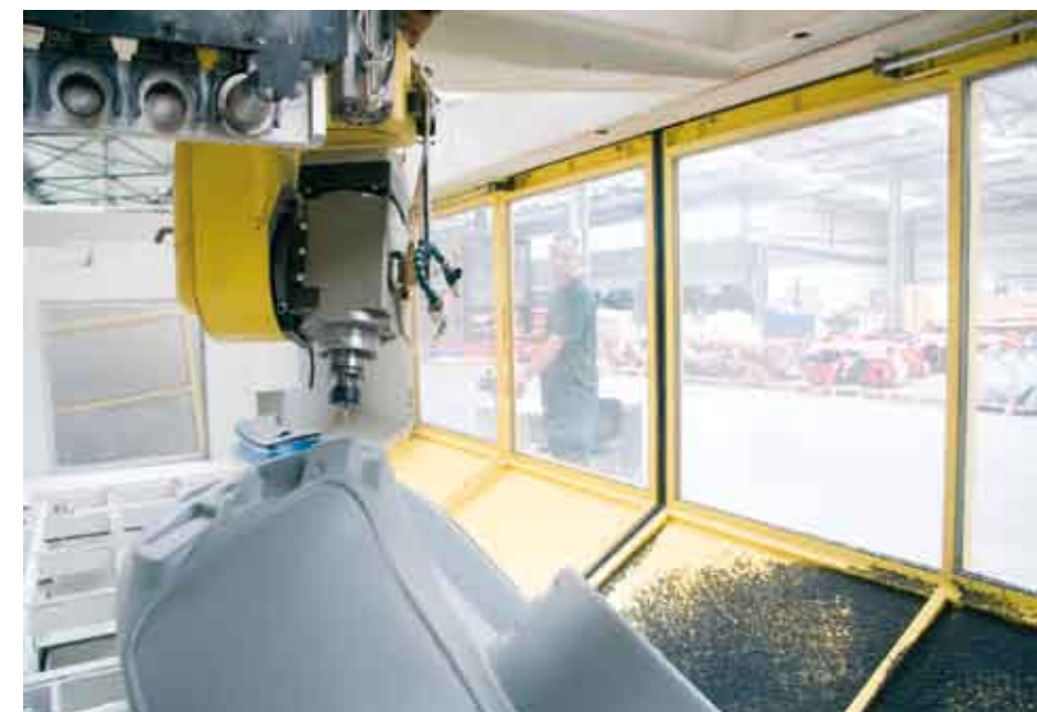
Wycinanie po termoformowaniu na frezarkach CNC zapewnia estetykę i powtarzalność detalu
