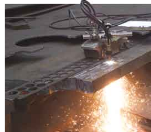
Cięcie stali samojezdnym urządzeniem firmy KOJKE
