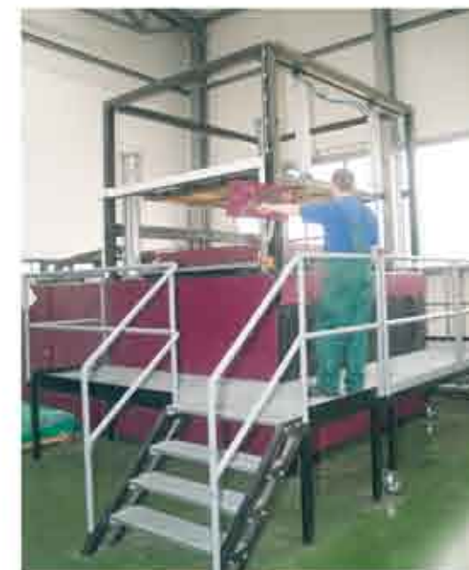
Procesy grzania, formowania i chłodzenia odbywają się automatycznie
