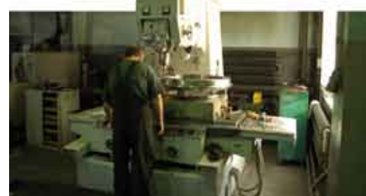
Duży dociskacz tłoczniaka na klasycznej wiertarce współrzędnościowej
