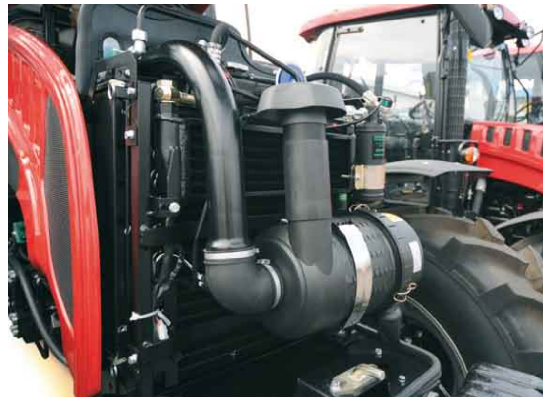
Filtr powietrza w ciągniku PRONAR 5135
