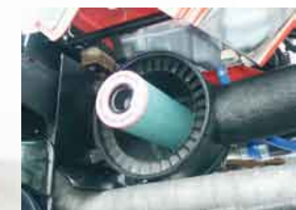
Wkłady filtra powietrza w ciągniku PRONAR 8140
