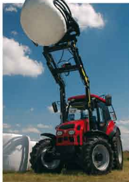
Ciągnik serii P5 z ładowaczem czołowym LC 3
