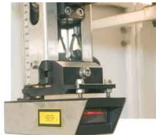
Laserowa bariera świetlna zapewniająca bezpieczeństwo na najwyższym poziomie
