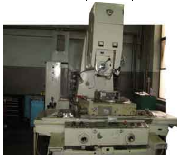
Bardzo dokładna ale powolna wiertarka współrzędnościowa
