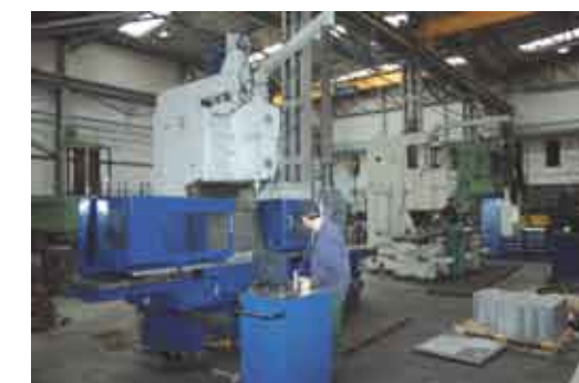
Duże frezarki ze stołami krzyżowymi i liniałami pomiarowymi
