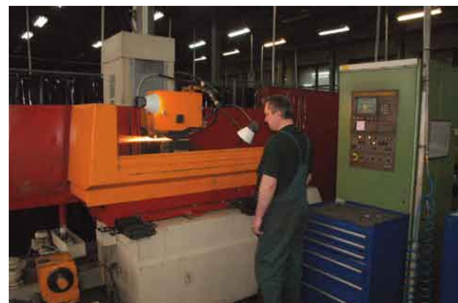
Pracująca nieprzerwanie od 2000 roku (wtedy pierwsza w Polsce) sterowana numerycznie eksperymentalna szlifierka do płaszczyzn
