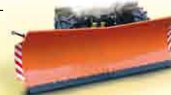
Pług PU-3300 z metalowymi lemieszami na ślizgach
