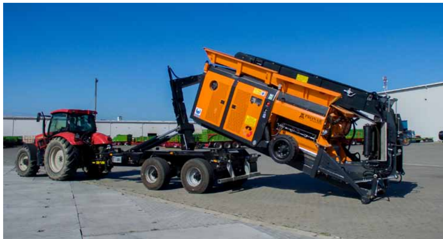
↑ Mechanizm hakowy przyczepy T286 umożliwia osadzenie na niej mobilnego rozdrabniacza wolnoobrotowego MRW 2.75h, który został specjalnie do tego przystosowany
