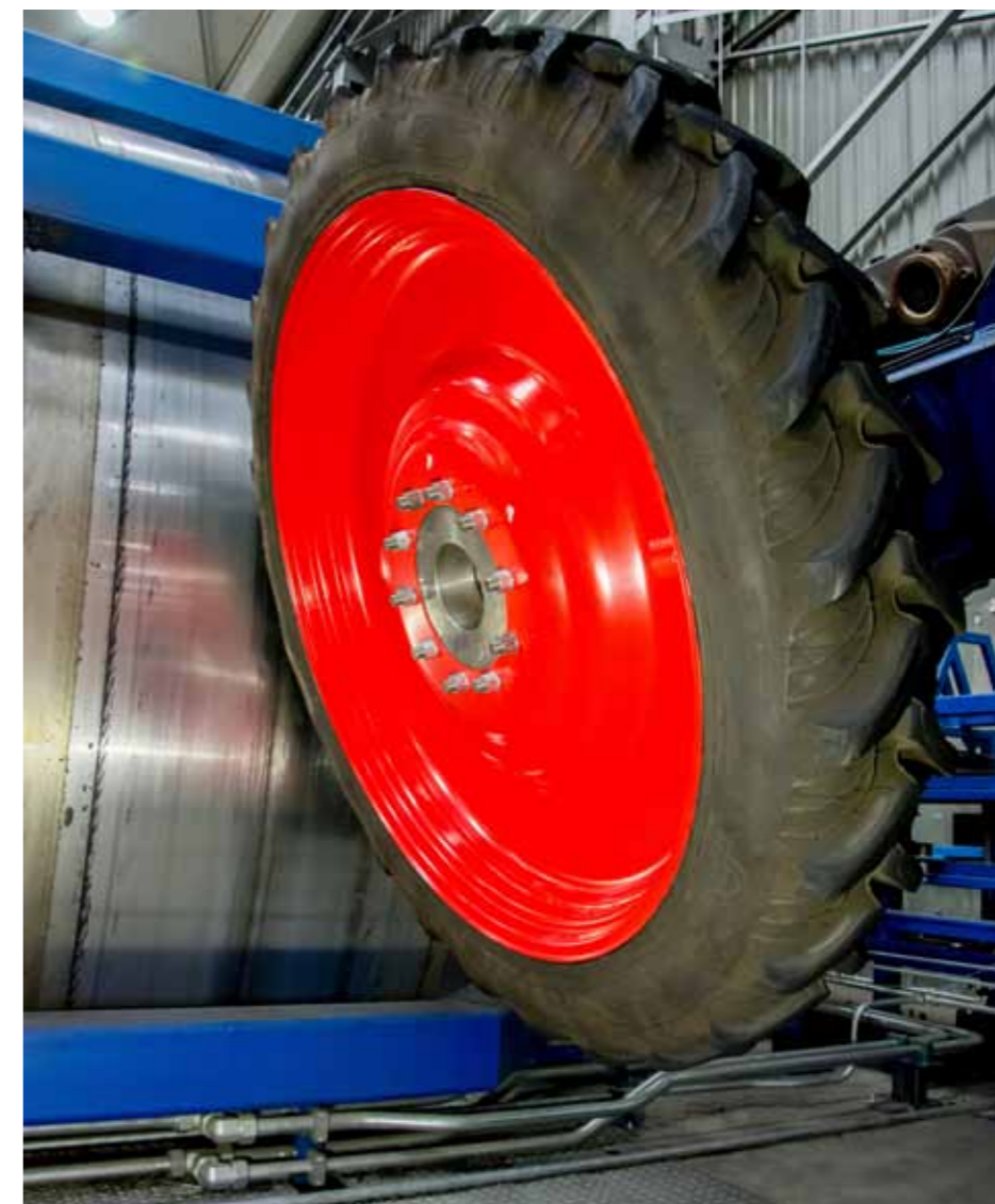
↑ Badanie wytrzymałości zmęczeniowej koła na obciążenia promieniowe
