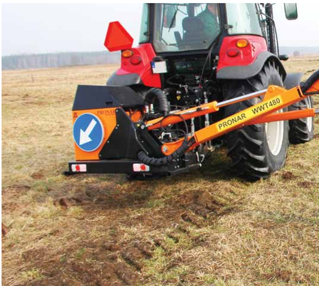
↑ Wysięgnik PRONAR WWT480 z głowicą PRONAR GK80L
