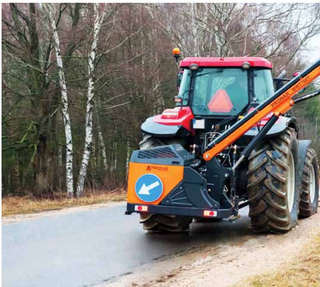
↑ Wysięgnik PRONAR WWT480 z głowicą PRONAR GK80L
