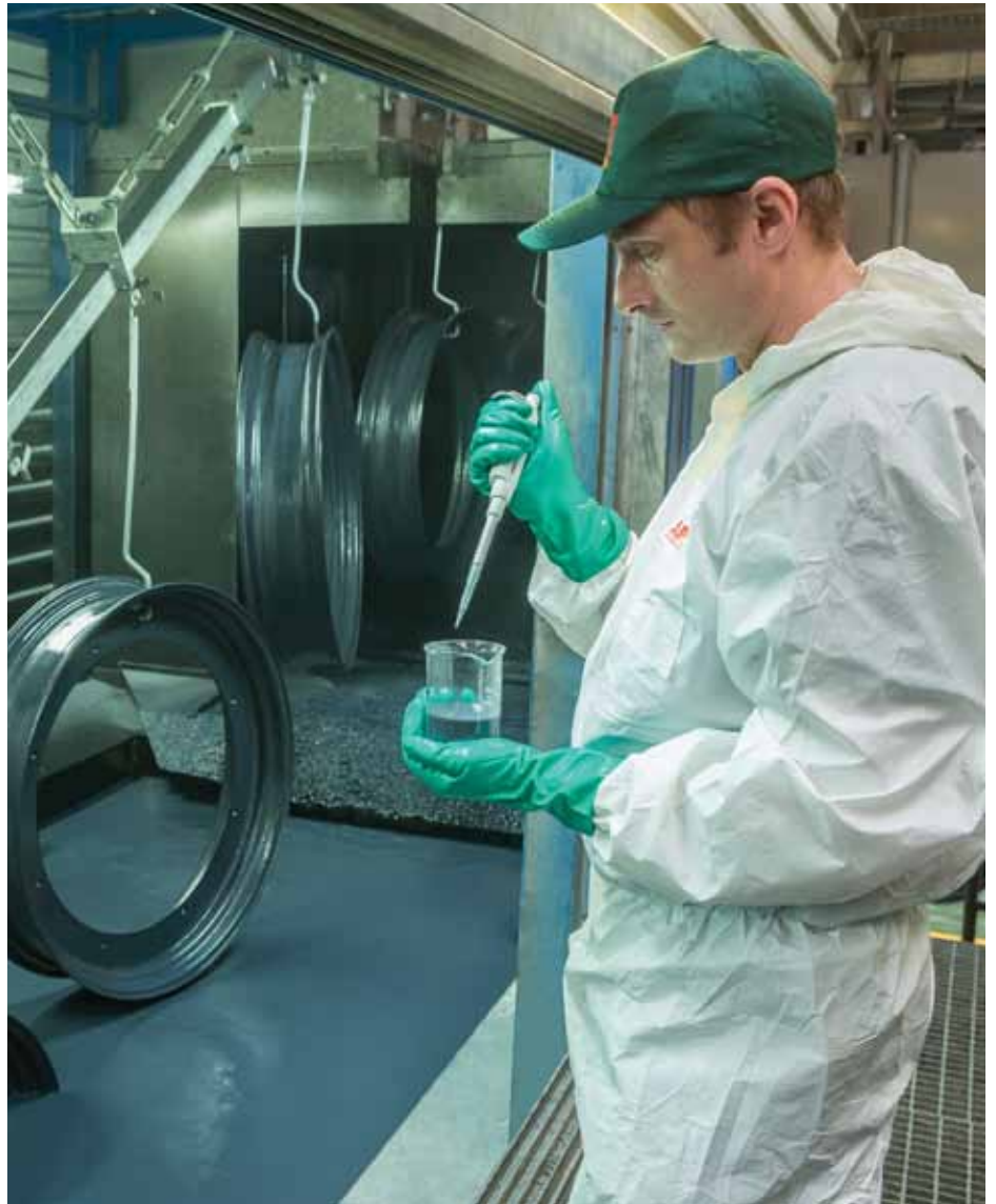
↑ Proces kontroli kąpeli kataloforetycznej - pracownik pobiera próbkę w celu zbadania składu żywicy
