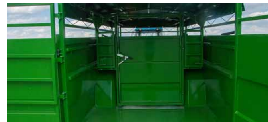
↑ Przegroda wewnętrzna na prowadnicach (pzesuwana) oddzielająca przewożone zwierzęta
