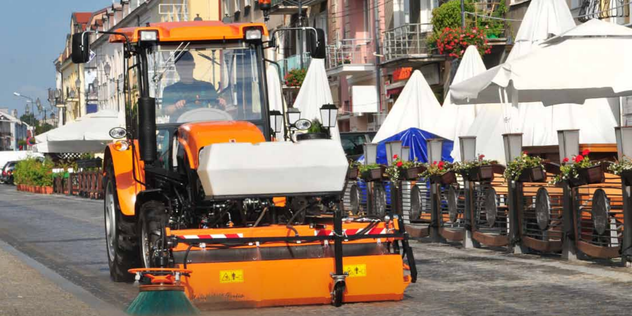
↑ System zawieszenia zamiatarki Agata ZM-2000 umożliwia jej agregowanie nie tylko z ciągnikami, ale również z wózkami widłowymi i innymi pojazdami
