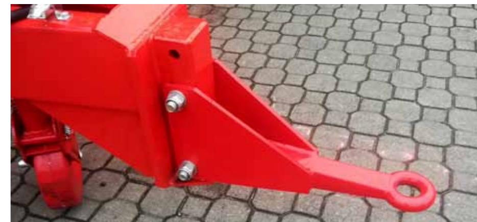
↑ Sztywny zaczep dyszla przyczepy T671 z okiem \varnothing 50 mm - dzięki regulowanej wysokości mocowania - jest przystosowany do łączenia z dolnymi zaczepami wielu ciągników
