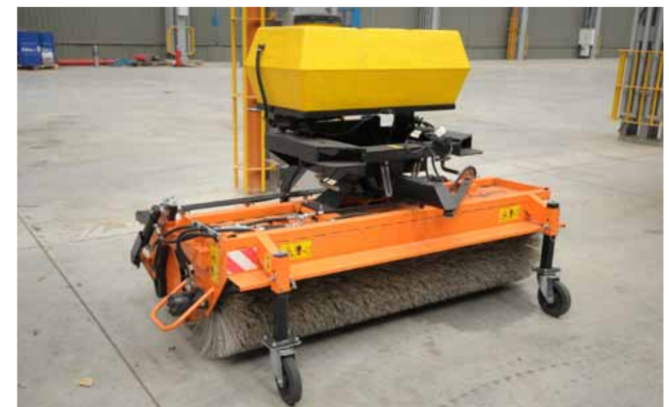
↑ System zawieszenia zamiatarki Agata ZM-2000 umożliwia jej agregowanie nie tylko z ciągnikami, ale również z wózkami widłowymi i innymi pojazdami
