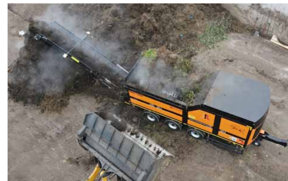
↑ MRW 1.300 jest wykorzystywany do przygotowywania frakcji kompostowej
