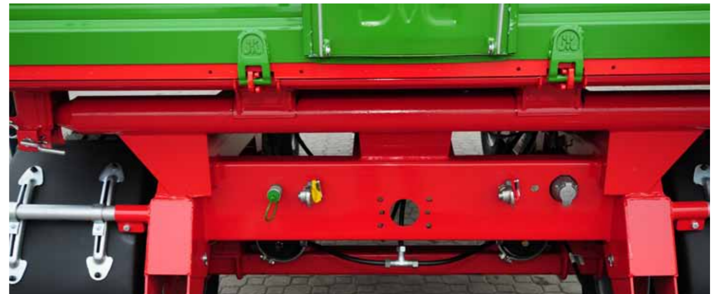
↑ Systemy: hydrauliczny, pneumatyczny i elektryczny są w przyczepach dwuosiowych Pronaru montowane standardowo. Ich gniazda są umiejscawiane z tyłu przyczep
