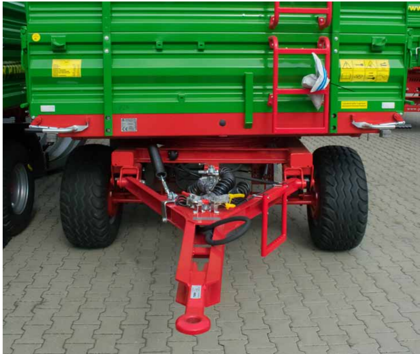
↑ W przyczepach Pronaru mogą być zamontowane różnego typu dyszle, m.in. dyszel typu Y
