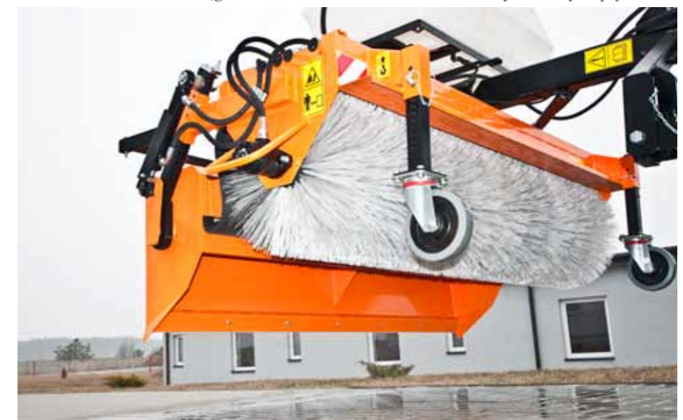
↑ ZM-2000 jest wyposażona w mechanizm hydraulicznego wywrotu kosza. Na zdjęciu: pozycja kosza w trakcie wysypywania śmieci
