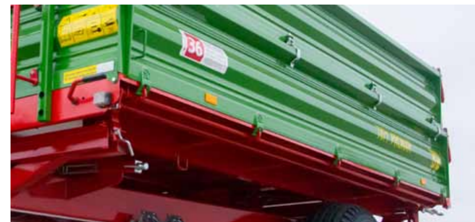
↑ Pięć kutych zawiasów zapewnia dolnej burcie przyczepy T671 pewną blokadę
