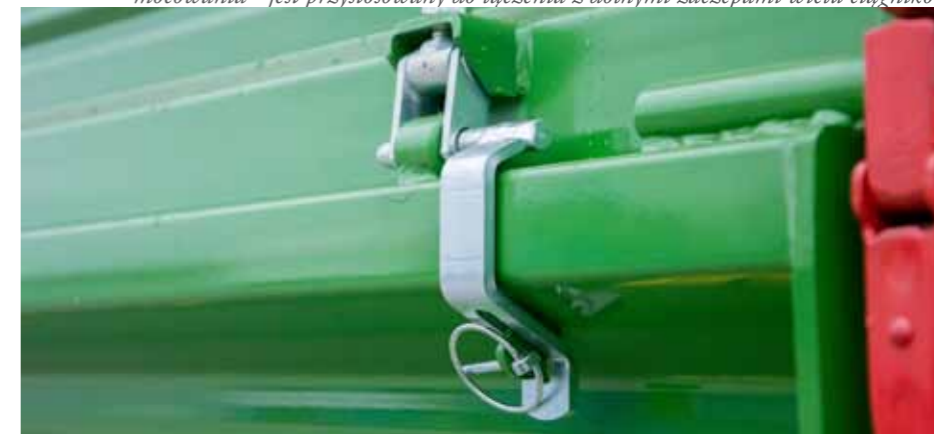
↑ Zawias nadstawy umożliwiający różne konfiguracje otwierania burty
