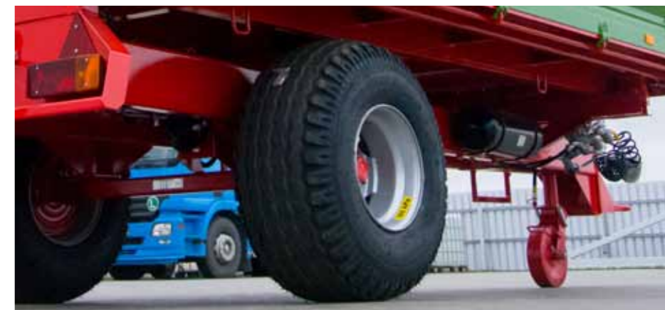
↑ W PRONAR T671 standardowo montowane jest szerokie ogumienie o rozmiarze 400/60-15,5
