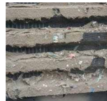
↑ Przykłady zanieczyszczenia chłodnicy powodującego przegrzewanie się maszyny
