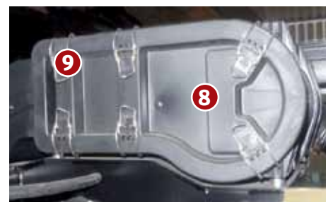
↑ Kontrola stopnia zanieczyszczenia filtrów ssawno-powrotnych
