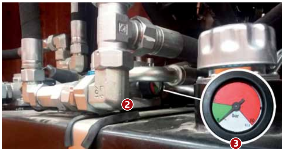
↑ Kontrola stopnia zanieczyszczenia filtrów ssawno-powrotnych
