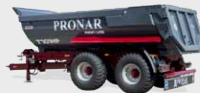
↑ T701HP (skrzynia typu half-pipe - ładowność 16,1 t)
