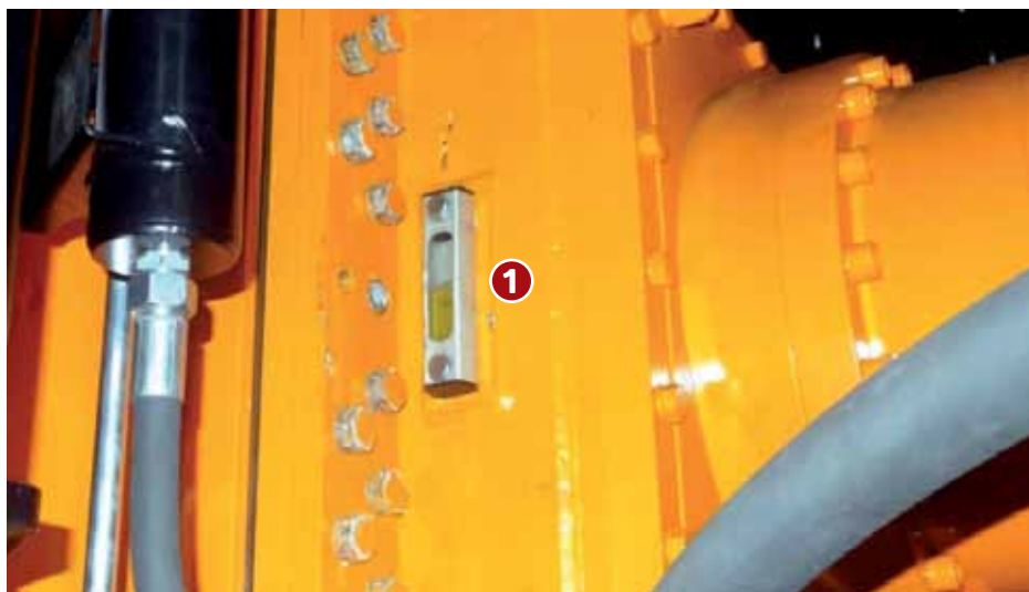
↑ Kontrola poziomu oleju przekładni planetarnej
