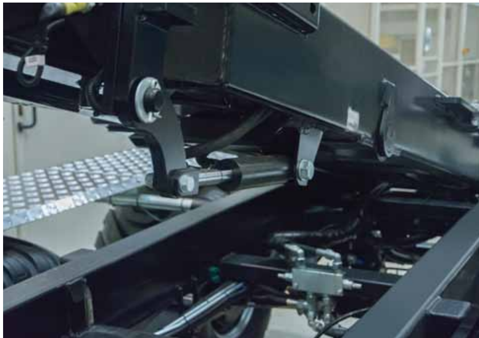
↑ System hydraulicznego przełączania pomiędzy funkcjami „hakowiec” a „wywrotka”
