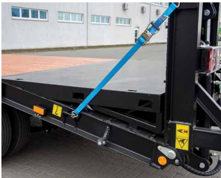
↑ Wkładka przedłużająca płaską część podłogi przyczepy RC2100/2
