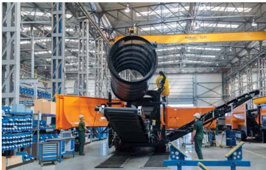
↑ Końcowym etapem produkcji przesiewacza bębnowego jest montaż sita
