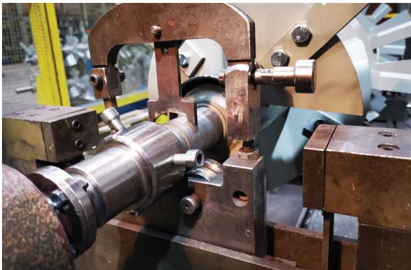
↑ Wał umieszczony na podporze
