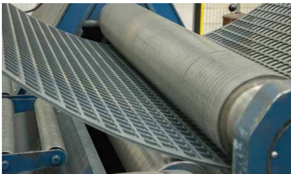
↑ Konstrukcja walcarki umożliwia wykonanie odpowiednio zaokrąglonego sita
