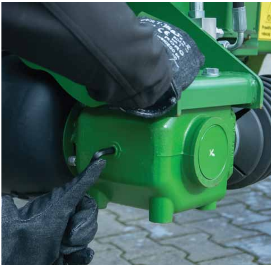
↑ Sprawdzanie poziomu oleju smarnego w przekładni kątowej
