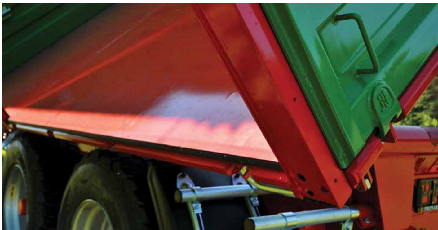
↑ Uszczelnione ranty podłogi przyczepy PRONAR T683U pozwalają na przewożenie drobnego ziarna
