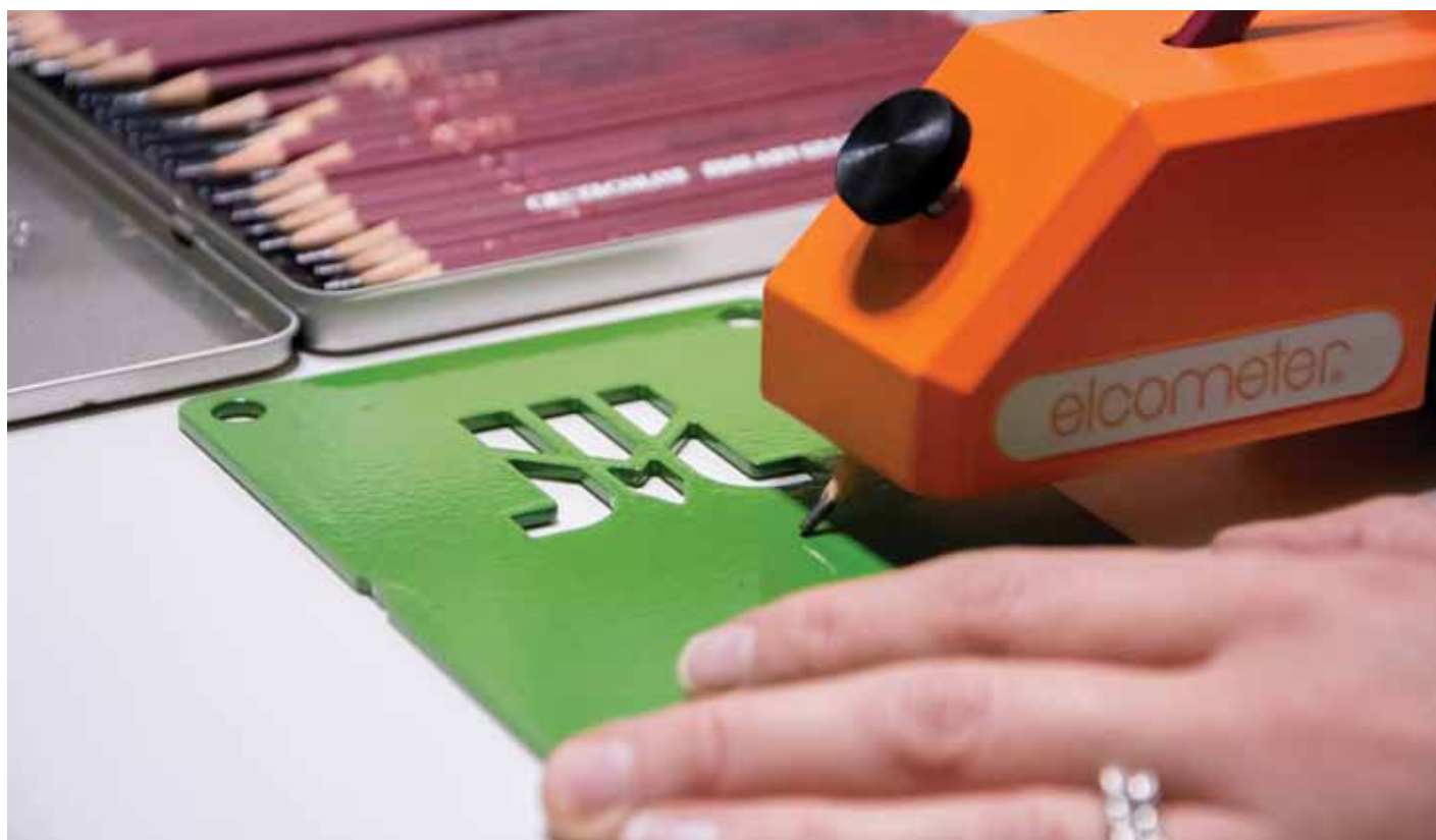
↑ Pomiar twardości powłoki metodą ołówkową
