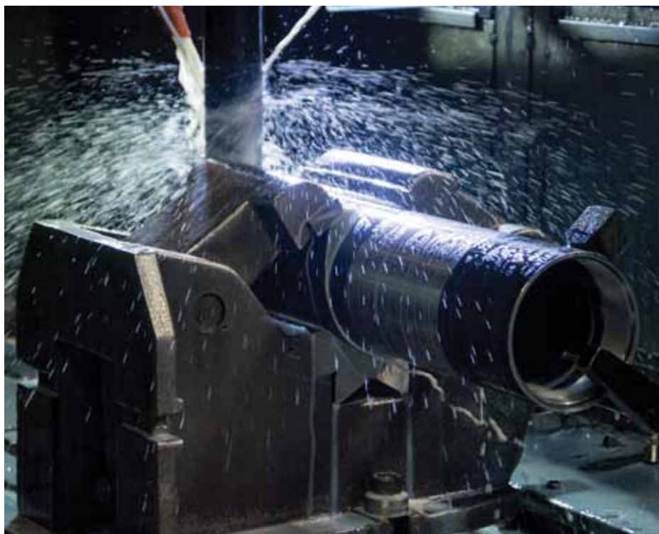
↑ Obróbka zespołu tulei cylindra
