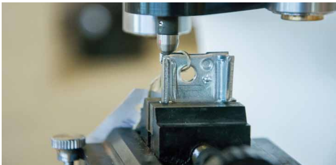
↑ Pomiar twardości elementu metodą Vickersa
