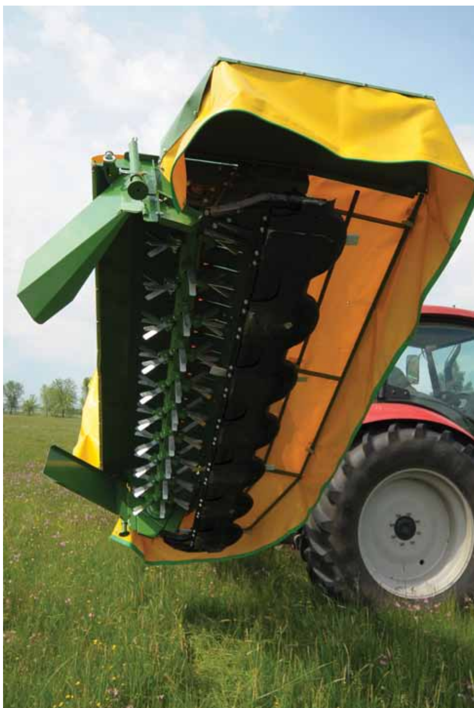
↑ Kosiarka PRONAR PDT 300C jest wyposażona m.in. w zamocowane do spulchniacza, zgarzniacze pokosu
