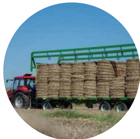
↑ Przyczepa PRONAR T028KM z hydraulicznym systemem unoszenia ścian
