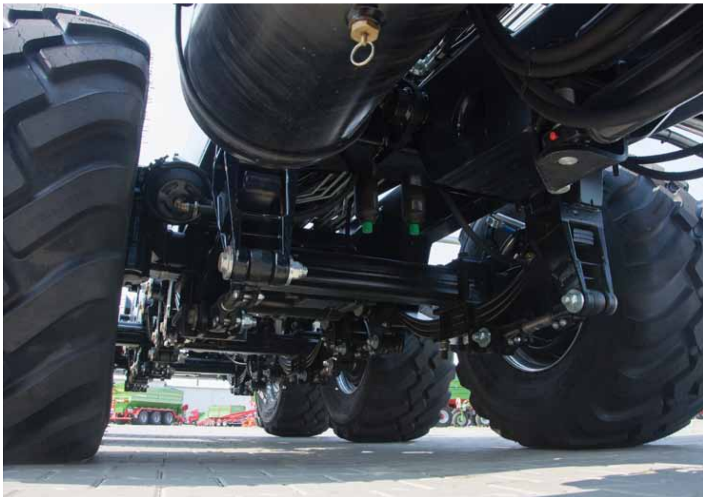
↑ Układ trzech resorów parabolicznych przyczepy PRONAR T386
