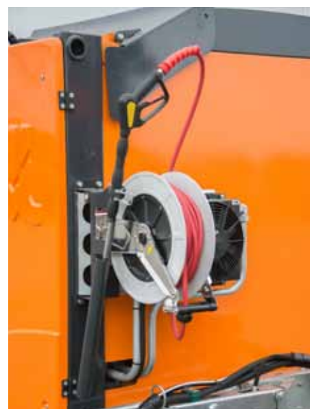
↑ Myjka ze zwijadłem umieszczona w przedniej części maszyny
