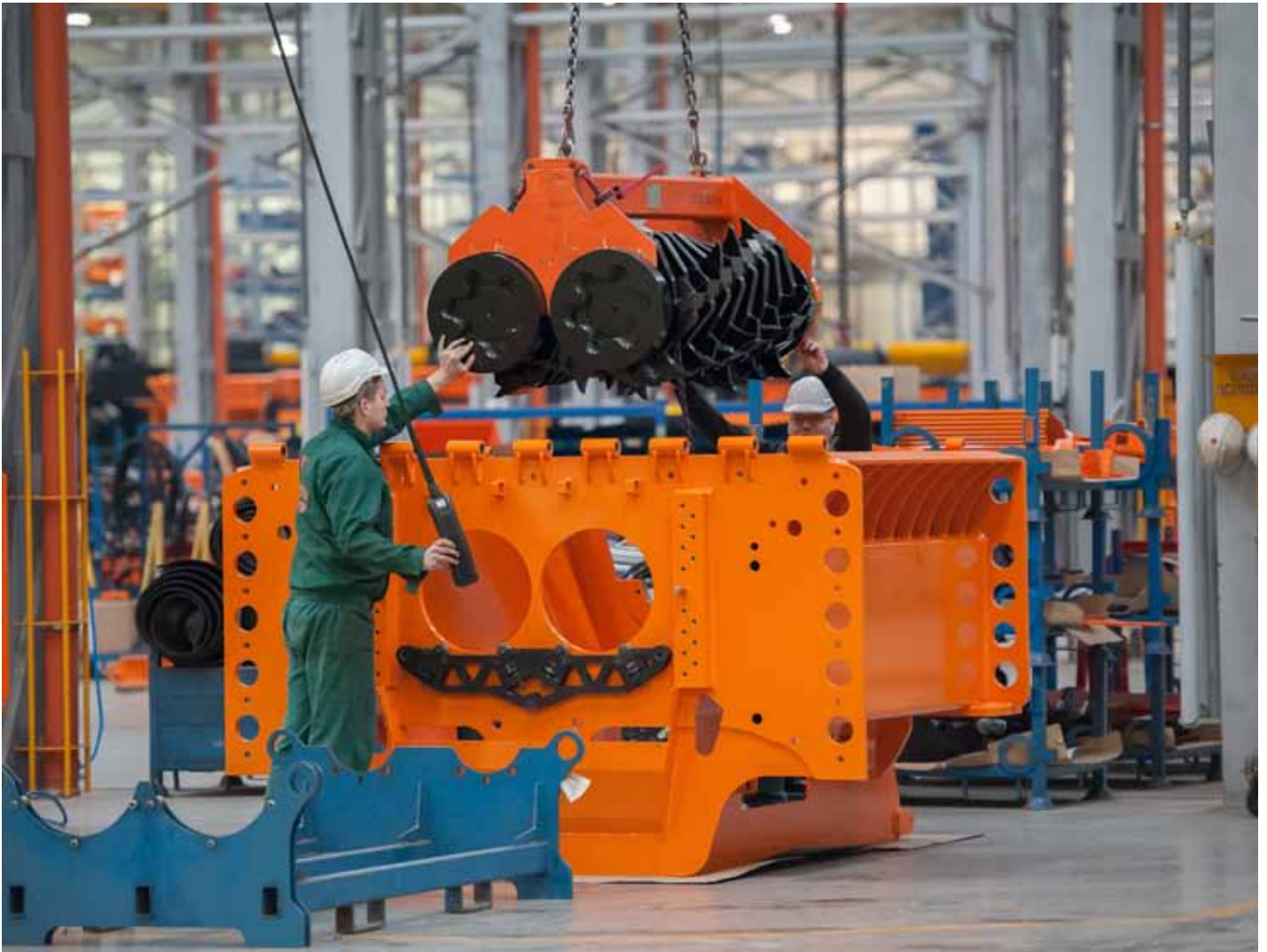
↑ Montaż wałów rozdrabniających jest jednym z ważniejszych procesów produkcji rozdrabniacza
