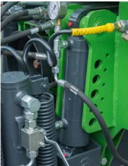
↑ Regulowany hydraulicznie dyszel doskonale amortyzuje maszynę
