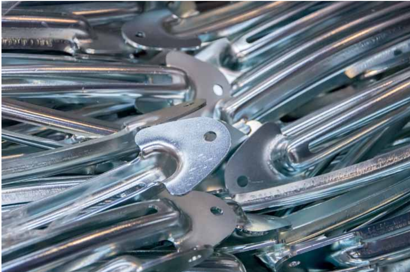
↑ Elementy maszyn z powłoką cynkową naniesioną w procesie galwanizacji
