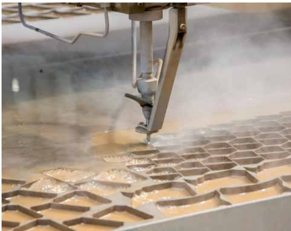
↑ Wycinarka wodna gwarantuje dokładne cięcie i zachowanie wszystkich istotnych właściwości materiału
