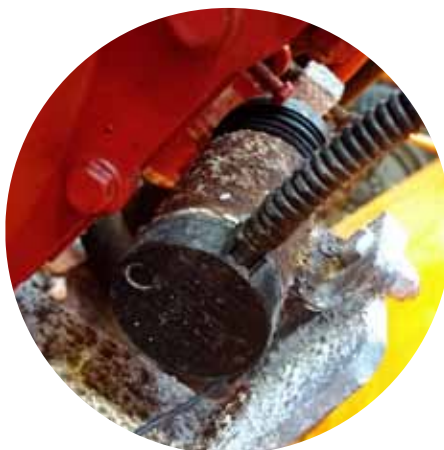
↑ Skorodowana cewka regulacji obrotów
