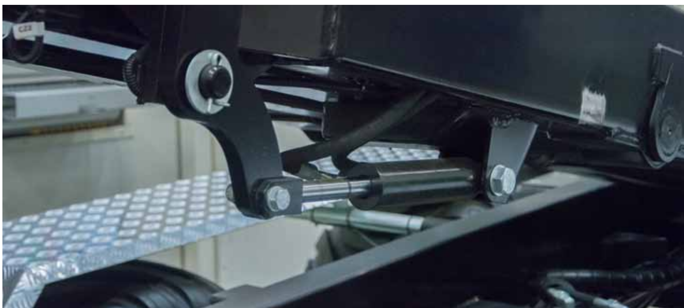
↑ Operator z kabiny ciągnika przy użyciu hydraulicznego układu przełączającego dostosowuje T185/1 do trybu pracy jako przyczepy hakowej lub wywrotki
