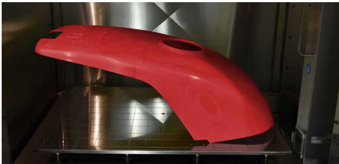
↑ Wydruk 3D w technologii FDM prototypu obudowy samojezdnego robota do pielęgnacji ogrodów o dużej powierzchni (obudowa wydrukowana z materiału ABS-M30, może być malowana w dowolnym kolorze z palety RAL)
