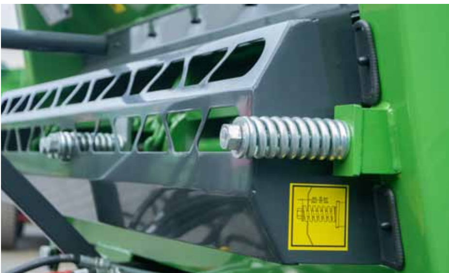
↑ Perforowana osłona zapewnia dobrą widoczność mechanizmu przenośnika
