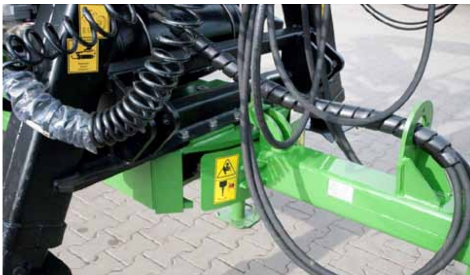
↑ Hydraulicznie sterowany dyszel
