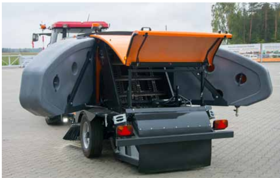
↑ Odchylane zbiorniki ułatwiają dostęp podczas obsługi przenośnika i szczotki walcowej
