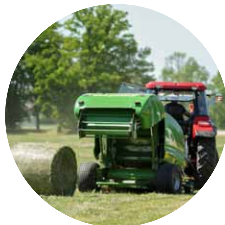
↑ Wyladunek balotu z komory prasowania
