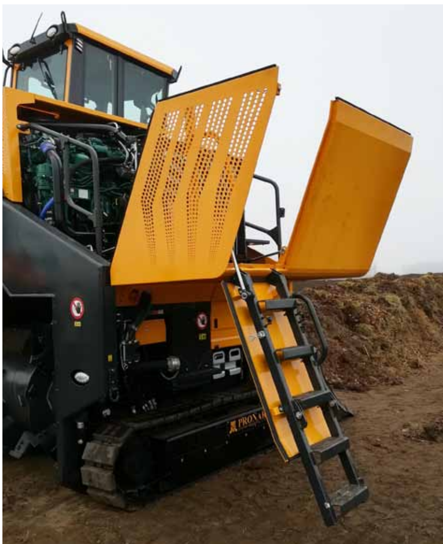
↑ Hydraulicznie otwierane osłony silnika ułatwiają serwisowanie przerzucarki
