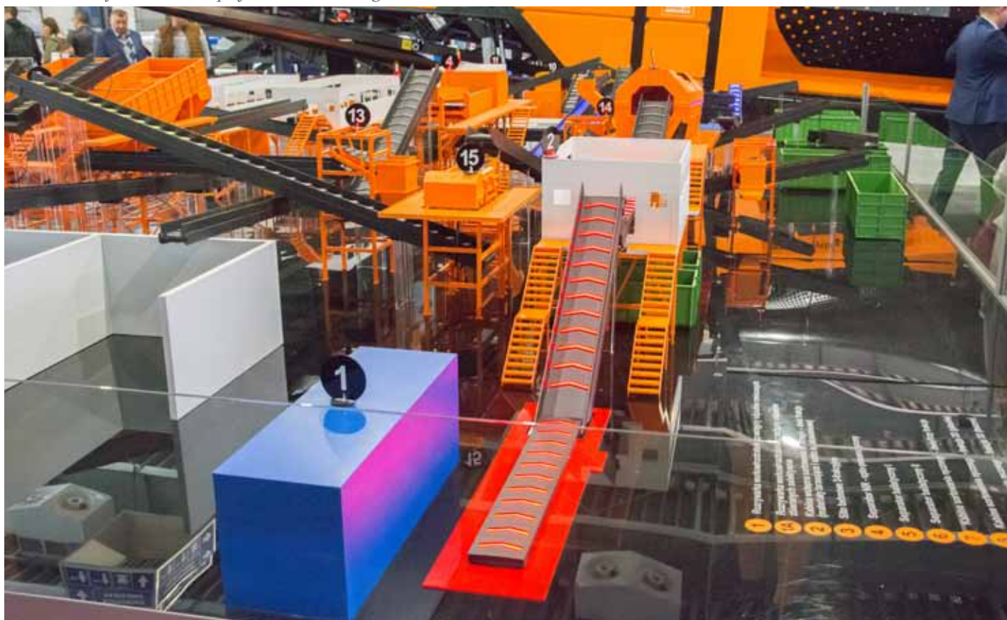
↑ Makieta instalacji sortowniczej do zagospodarowania odpadów komunalnych zmieszanych i pochodzących z selektywnej zbiórki
