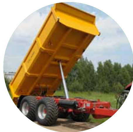
↑ Przyczepa T679/2 z podniesioną skrzynią ładunkową
