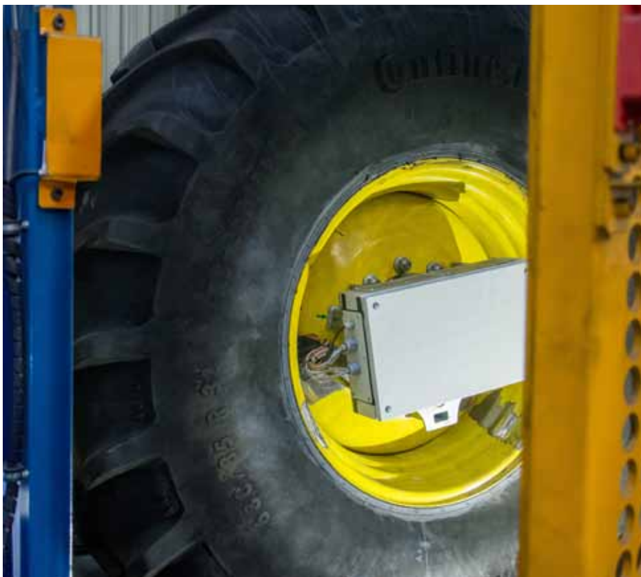
↑ Tensometryczny układ pomiarowy przeznaczony do badań polowych koła PRONAR
