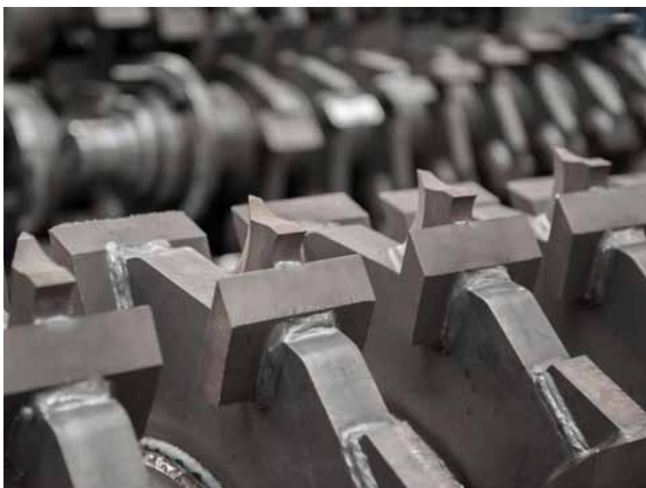
↑ Noże wału rozdrabniacza wykonane ze stali o wysokiej wytrzymałości
