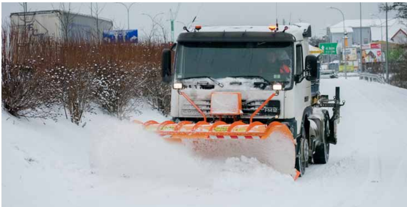
↑ Pług odsnieżający PRONAR PU-S25H, o szerokości roboczej 2500 mm, zagregowany z samochodem ciężarowym
