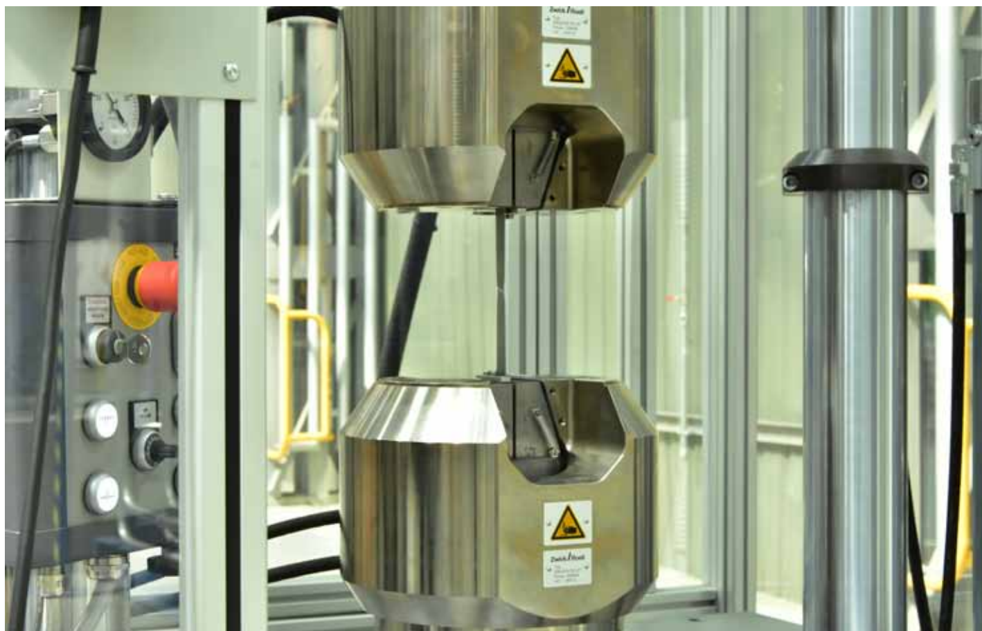
↑ Test granicy plastyczności stali w CBR PRONAR
