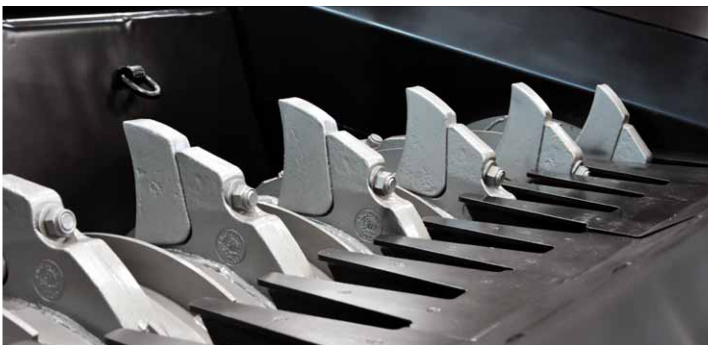
↑ Noże wału rozdrabniacza są wykonane ze stali o wysokiej wytrzymałości
