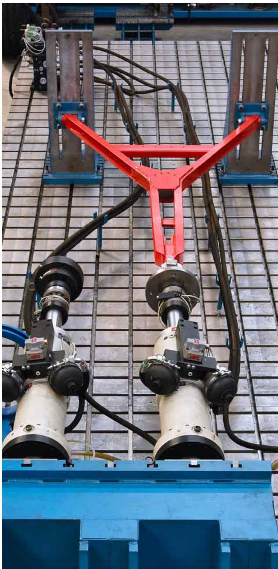
↑ Stanowisko do badania wytrzymałości zmęczeniowej dyszla
