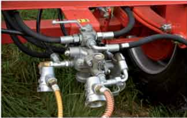
INSTALACJA HAMULCOWA dwuprzewodowa, pneumatyczna z ręcznym regulatorem siły hamowania
