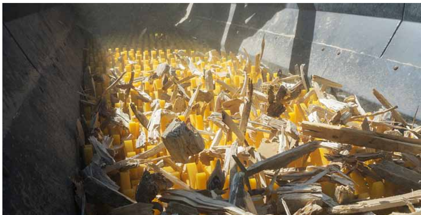
↑ Pokład gwiazdzisty może być używany zamiennie zamiast sita bębnowego
