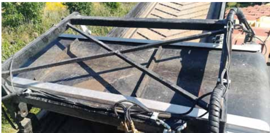
↑ Ramka stabilizująca separator magnetyczny w rozdrabniaczu PRONAR MRW 2.85
