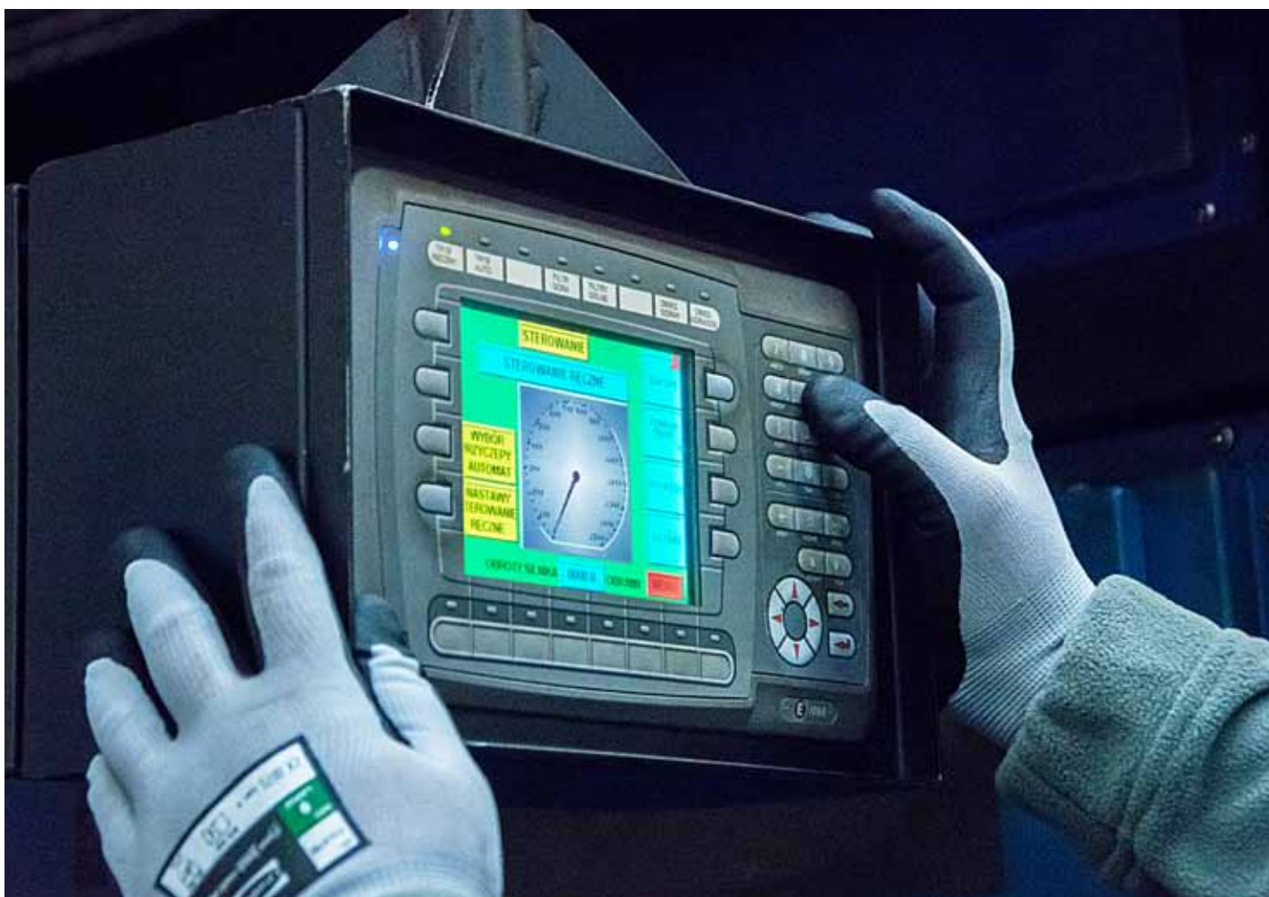
↑ Zobrazowany wynik badania instalacji hydraulicznej przyczepty
