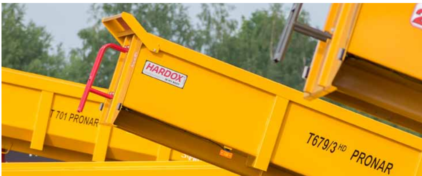
↑ Przyczepa PRONAR wykonana z blachy trudnościeralnej Hardox
