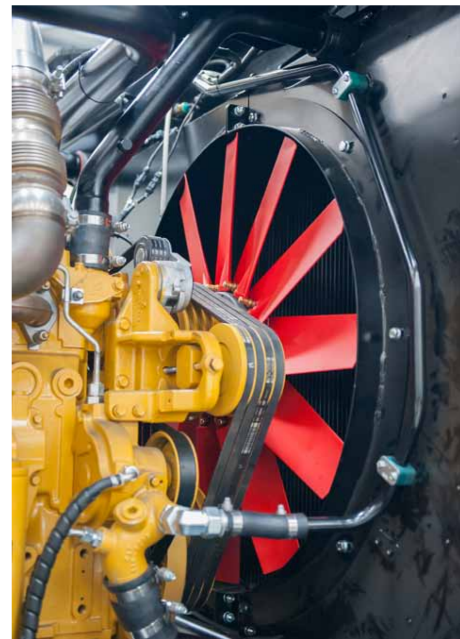
↑ Wentylator chłodnicy Cleanfix ze zmienną geometrią łopatek
