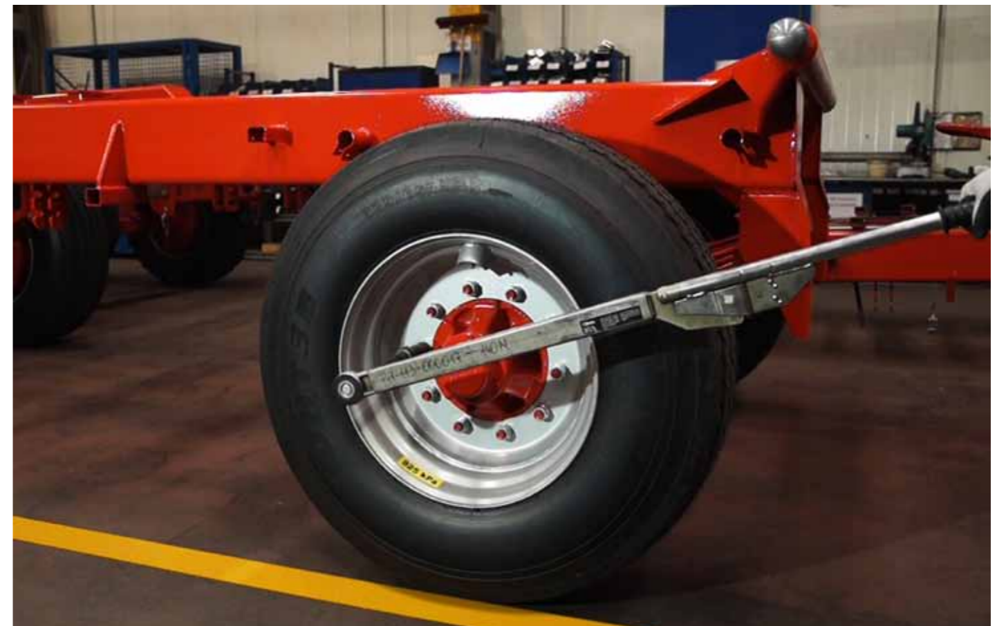
↑ Dokręcanie nakrętek kluczem dynamometrycznym
