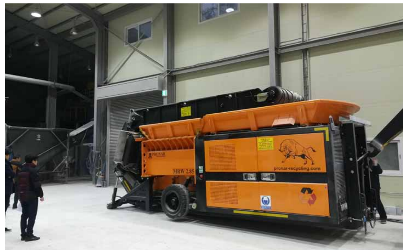
↑ Mobilny rozdrabniacz wolnoobrotowy PRONAR MRW 2.85he przystosowany do przewozu na przyczepie hakowej z silnikiem elektrycznym
