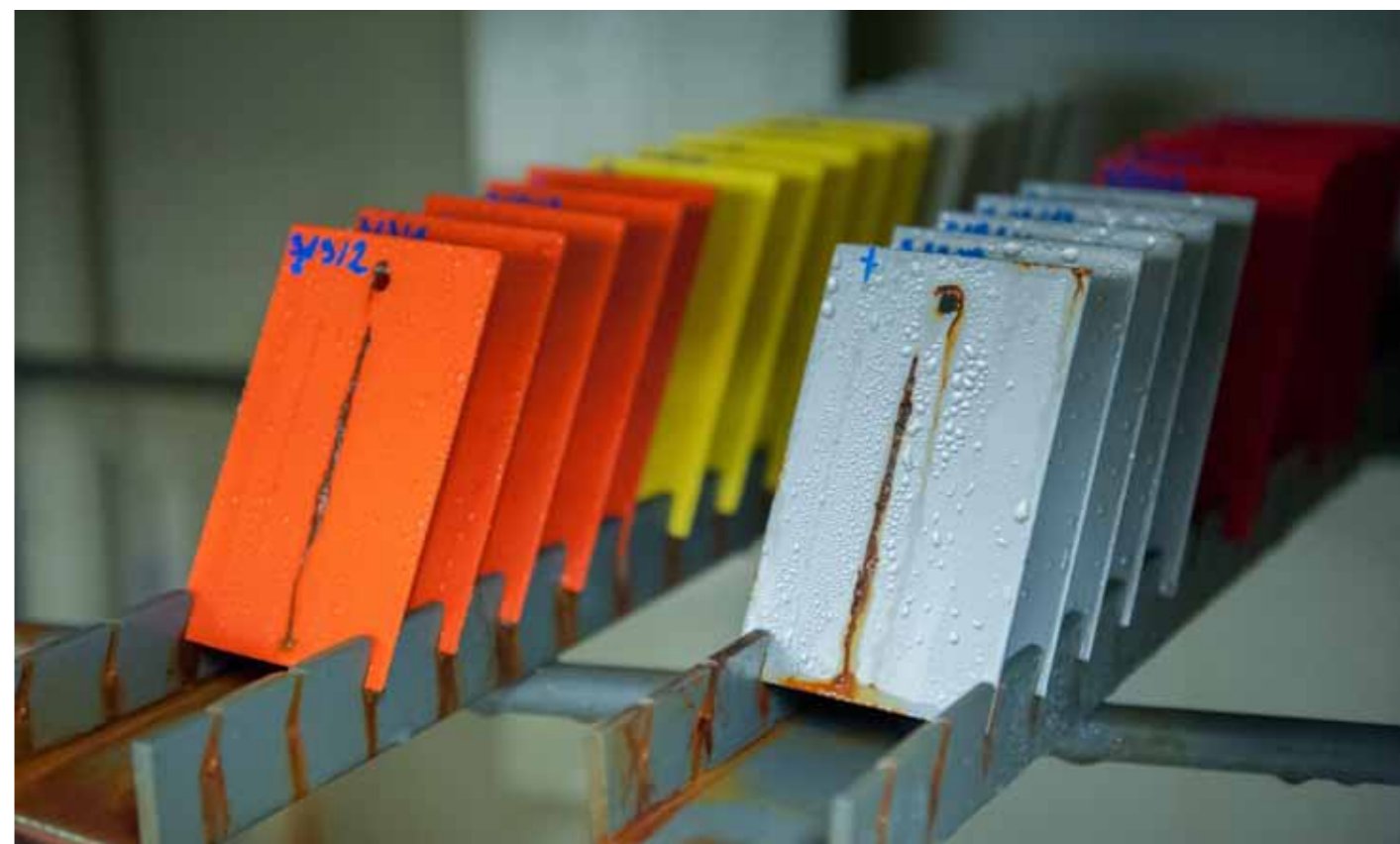
↑ Próbki w czasie badań starzeniowych z wykorzystaniem komory solnej
