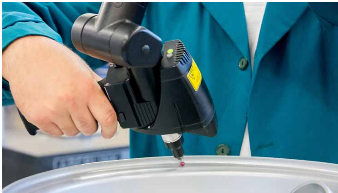
↑ Badanie współrzędnościowym ramieniem pomiarowym zgodności zarysu obręczy z wymaganiami ETRTO
