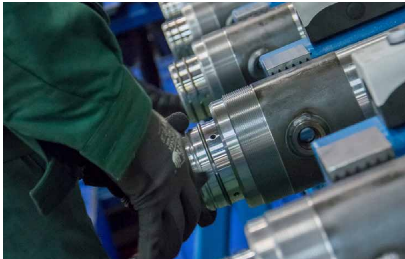
↑ Montaż siłowników teleskopowych
