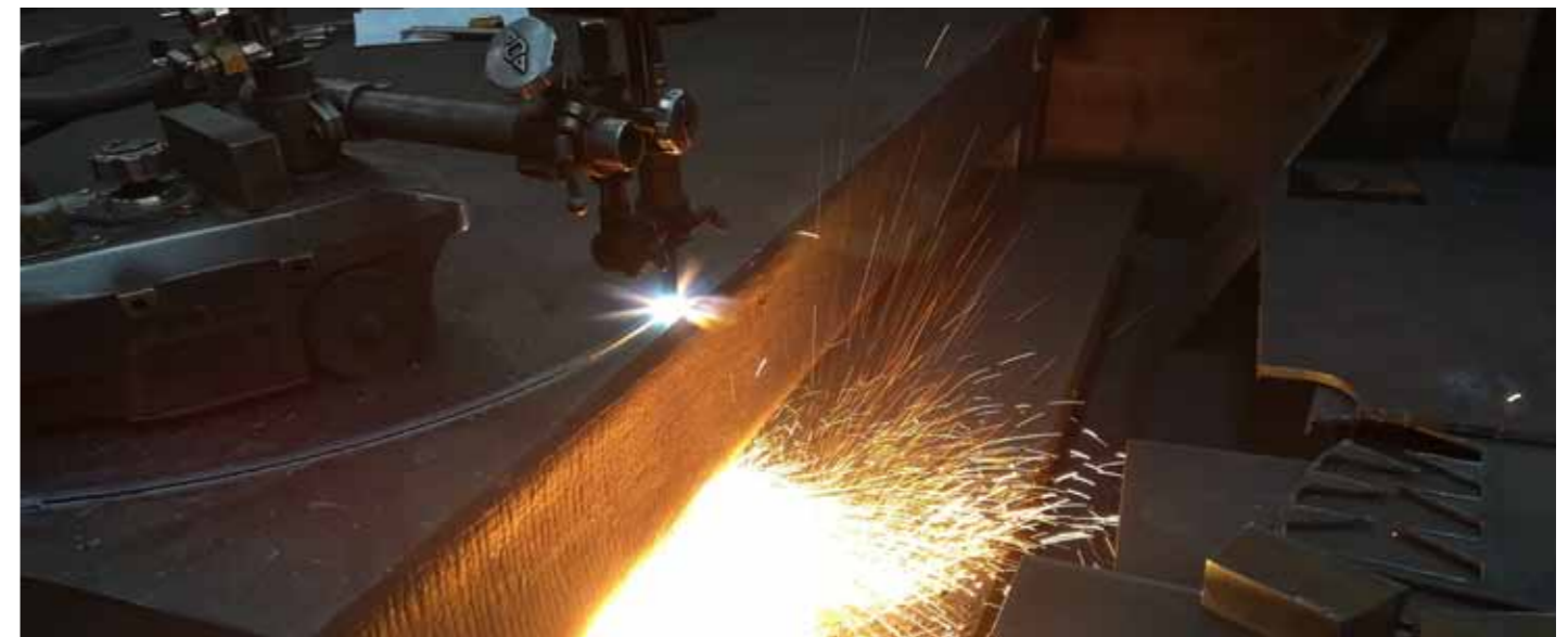
↑ Wycinanie materiału metodą acetylenowo-tlenową
