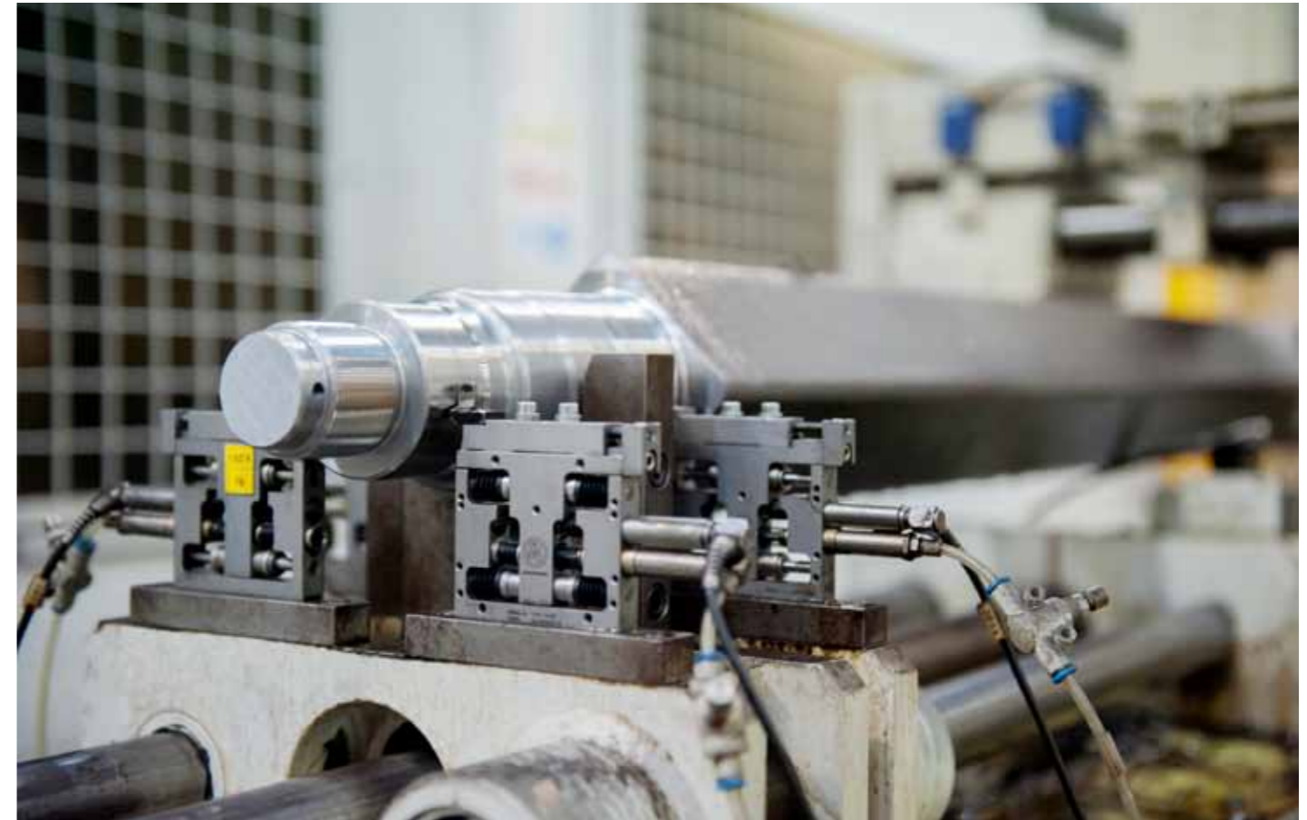
↑ Pomiar średnicy czopów osi jezdnej
