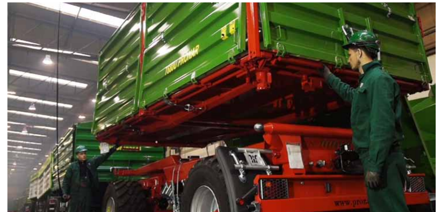
↑ Montaż burt w przyczepie PRONAR T680
