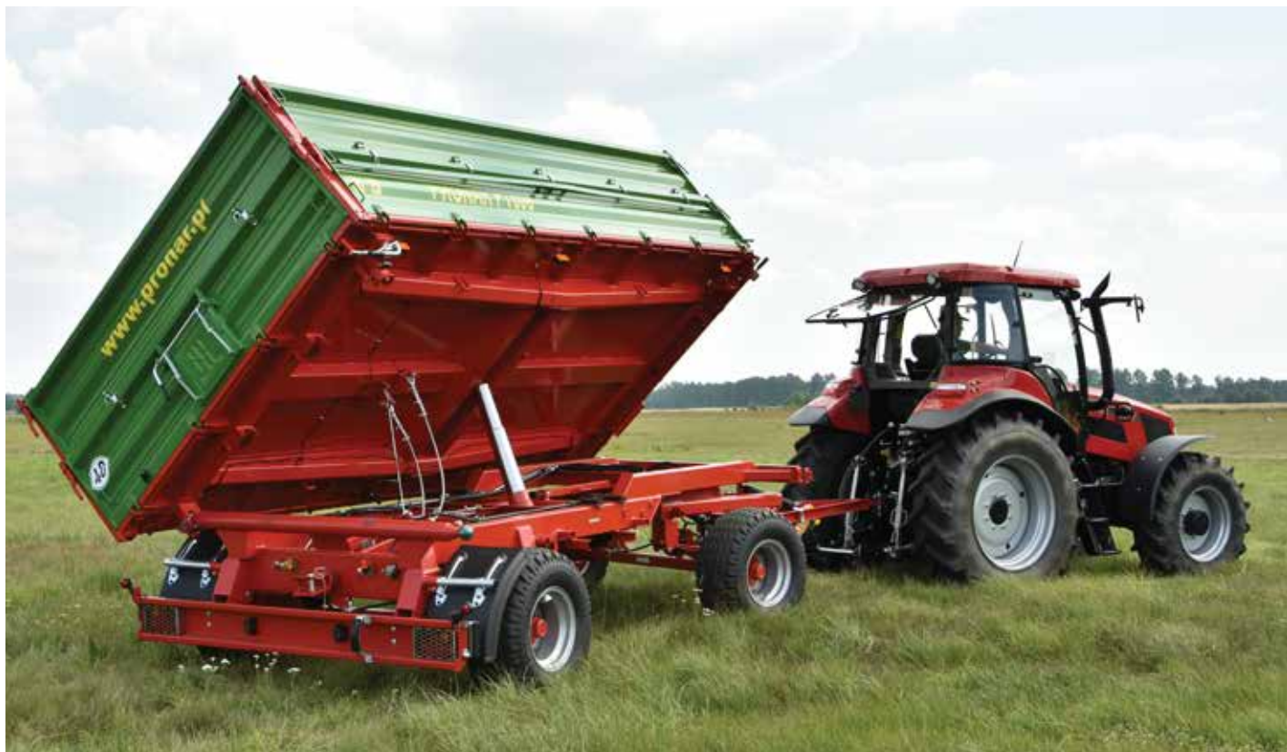
↑ Zaletą przyczep paletowych jest duża objętość skrzyń ładunkowych (na zdjęciu PRONAR T608)
