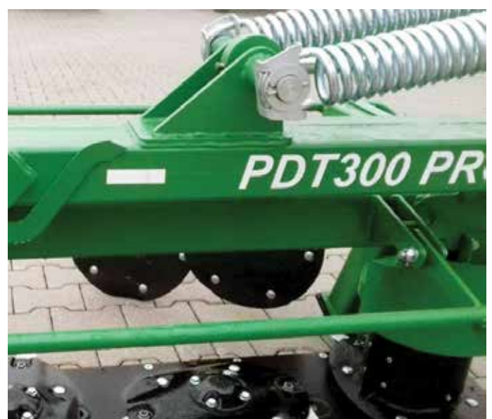
↑ Wskaźnik ustawienia listwy tnącej znajdującej się w pozycji roboczej
