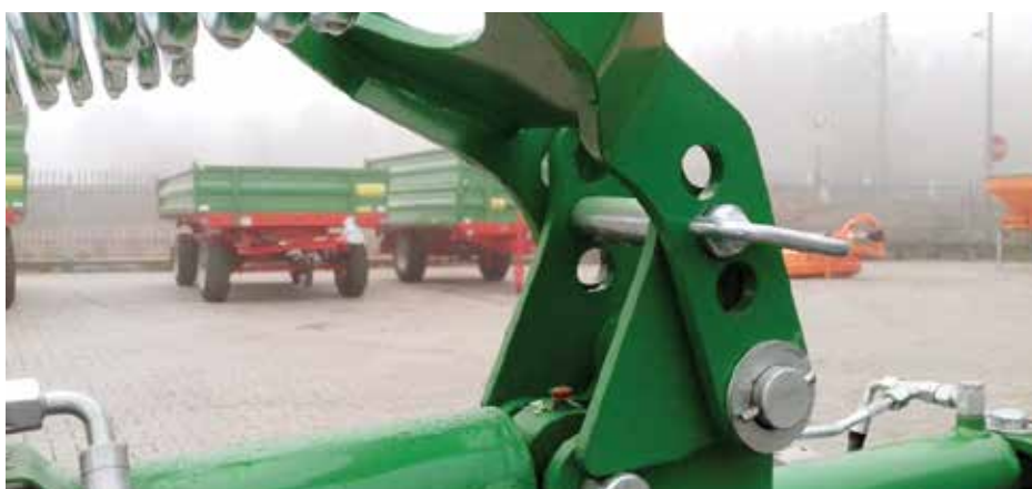
↑ Układ sterowania naciskiem listwy tnącej na podłoże
