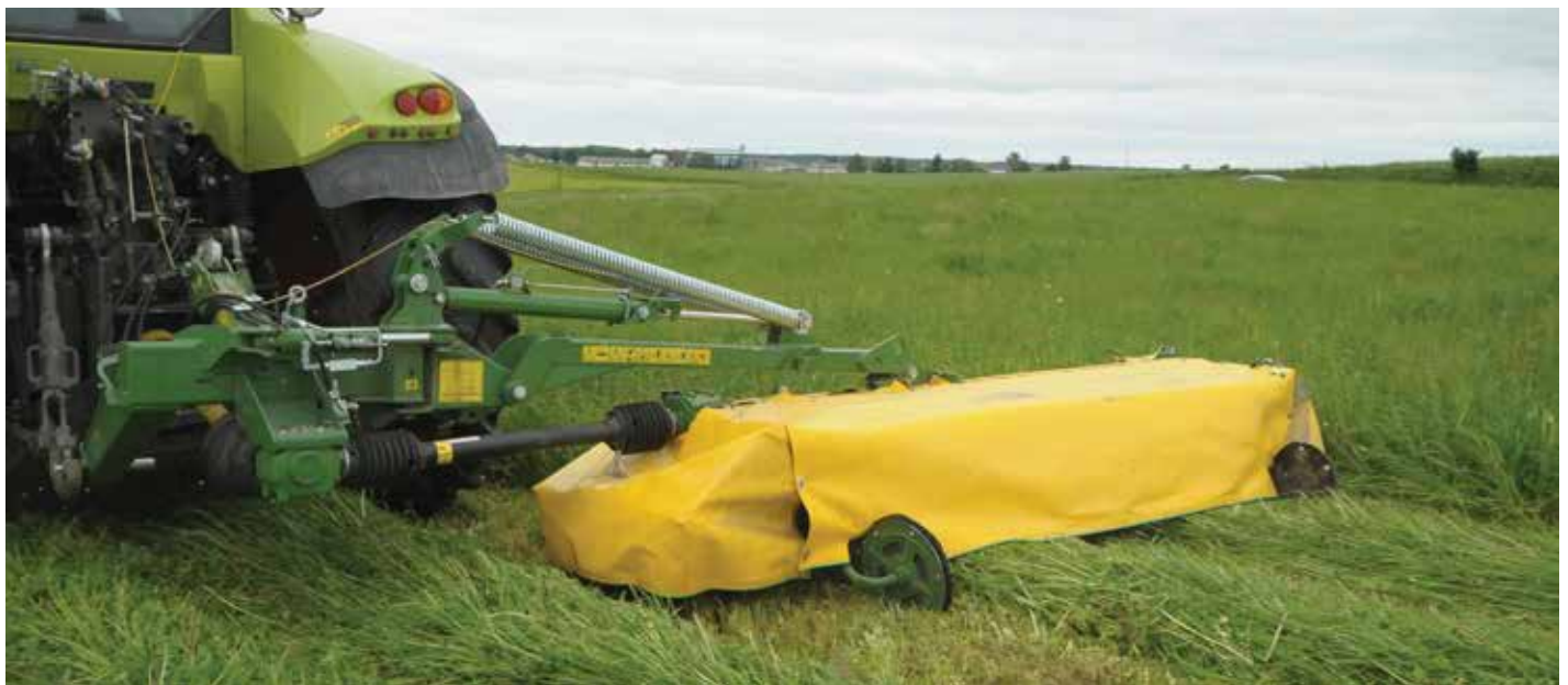
↑ Pokos kosiarki dyskowej jest szeroki i cienki, przez co równomiernie schnie i jest łatwy do przetrzysania
