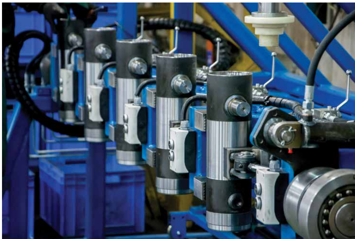
↑ Stanowisko montażu hydraulicznych siłowników teleskopowych
