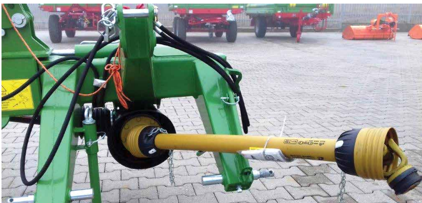
↑ Wałek odbioru mocy ze sprzęgłem stanowi wyposażenie standardowe kosiarki
