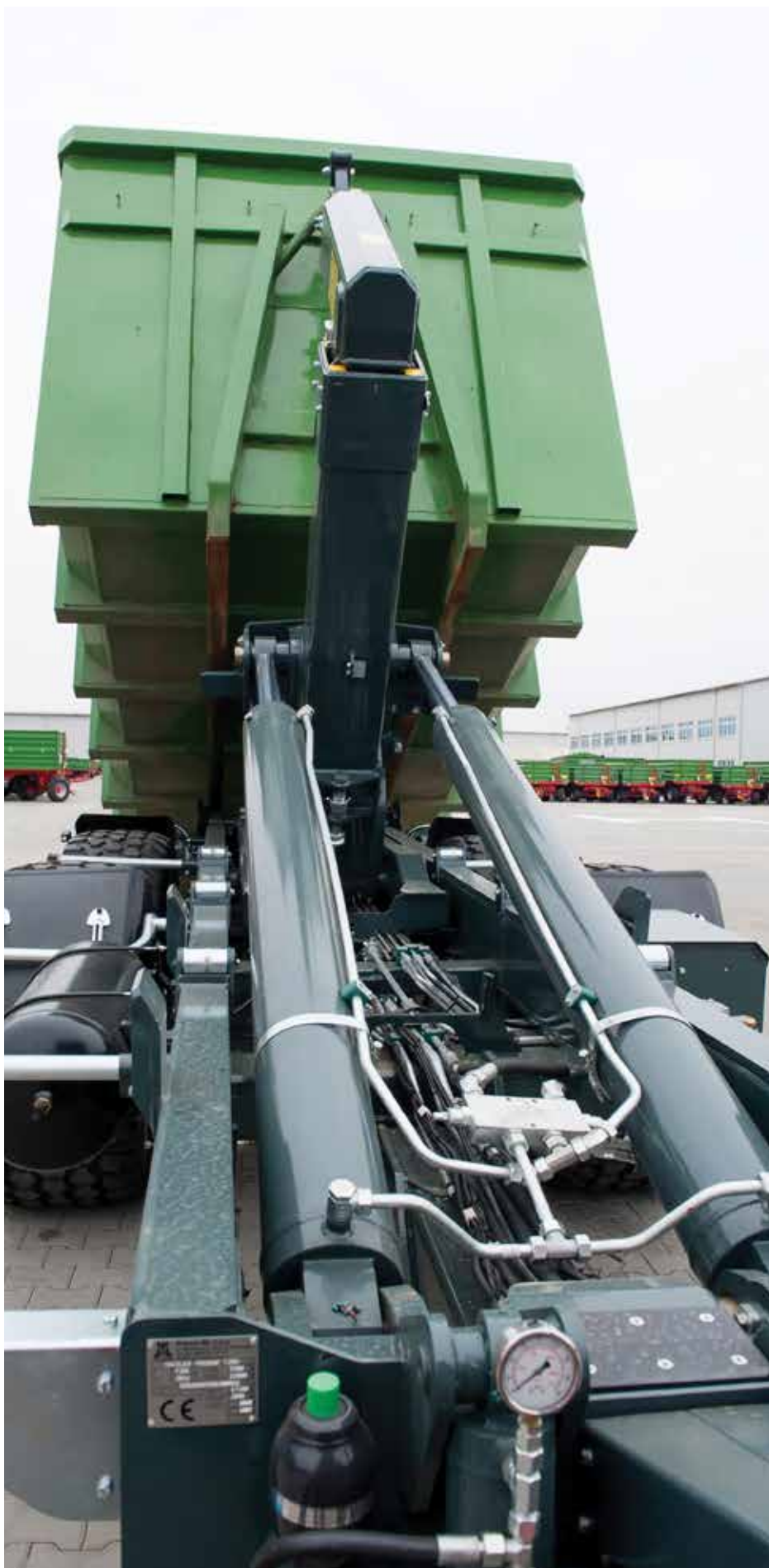
↑ Siłowniki hydrauliczne w przyczepie hakowej PRONAR
