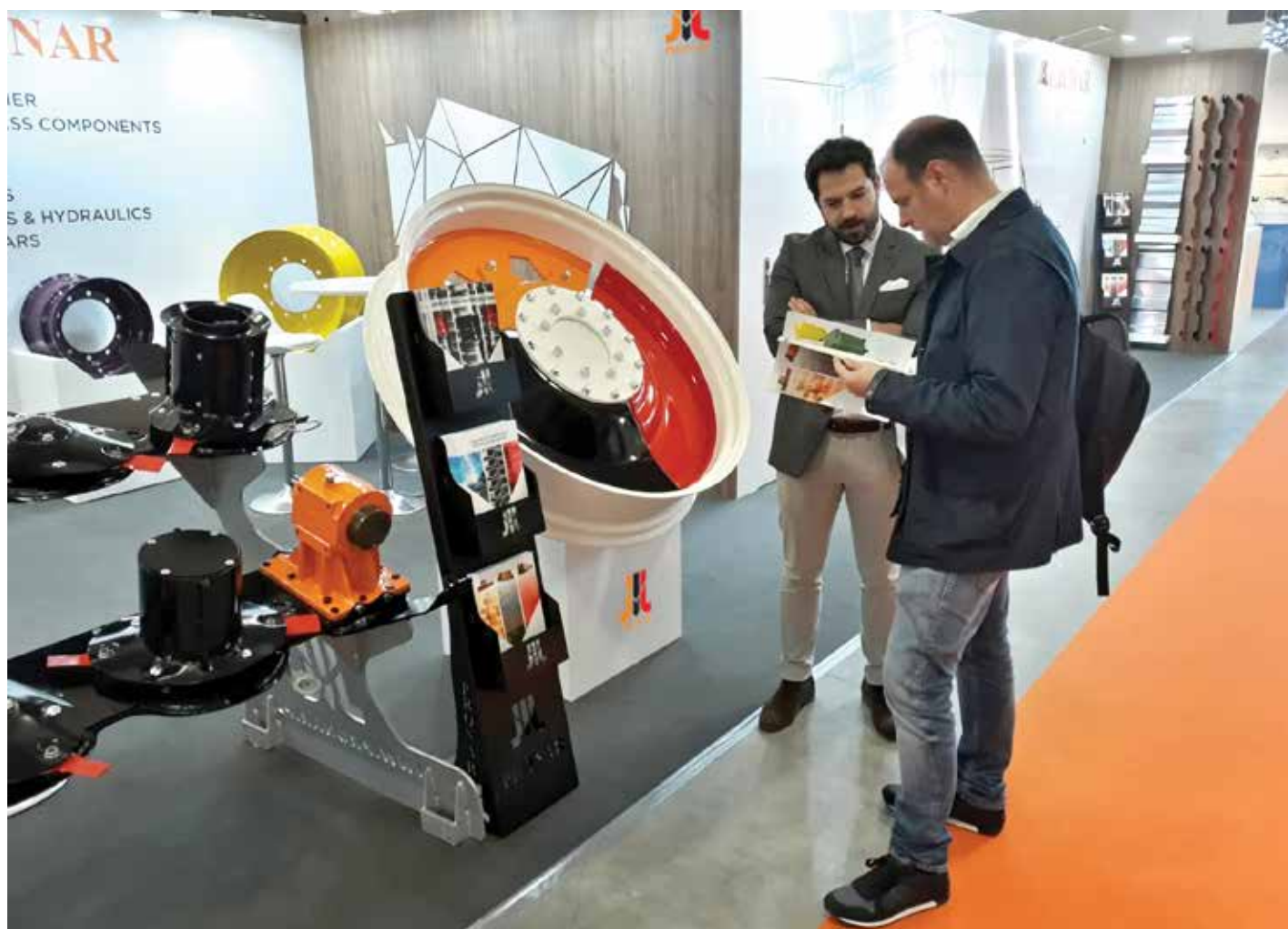
↑ Prezentowane na targach EIMA 2018 w Bolonii wąskie koła do montowania w opryskiwaczach z trzema konfiguracjami połączenia tarczy z obręczą
