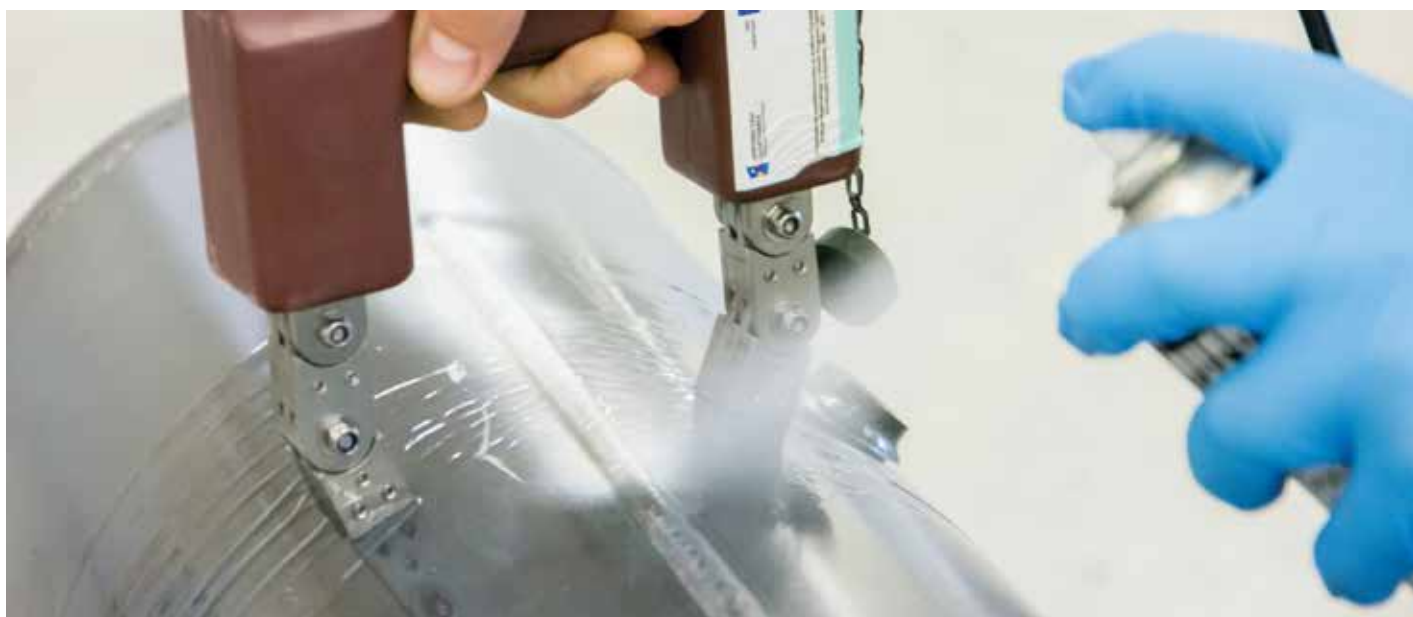
↑ Realizowane w Pronarze badania są prowadzone trzema metodami powierzchniowymi
