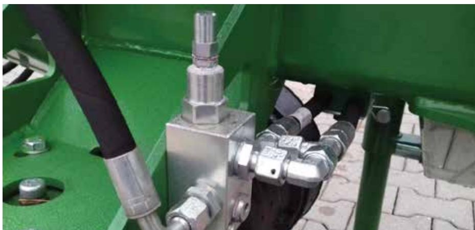
↑ Zawór zabezpieczający listwę tnącą przed uszkodzeniem
