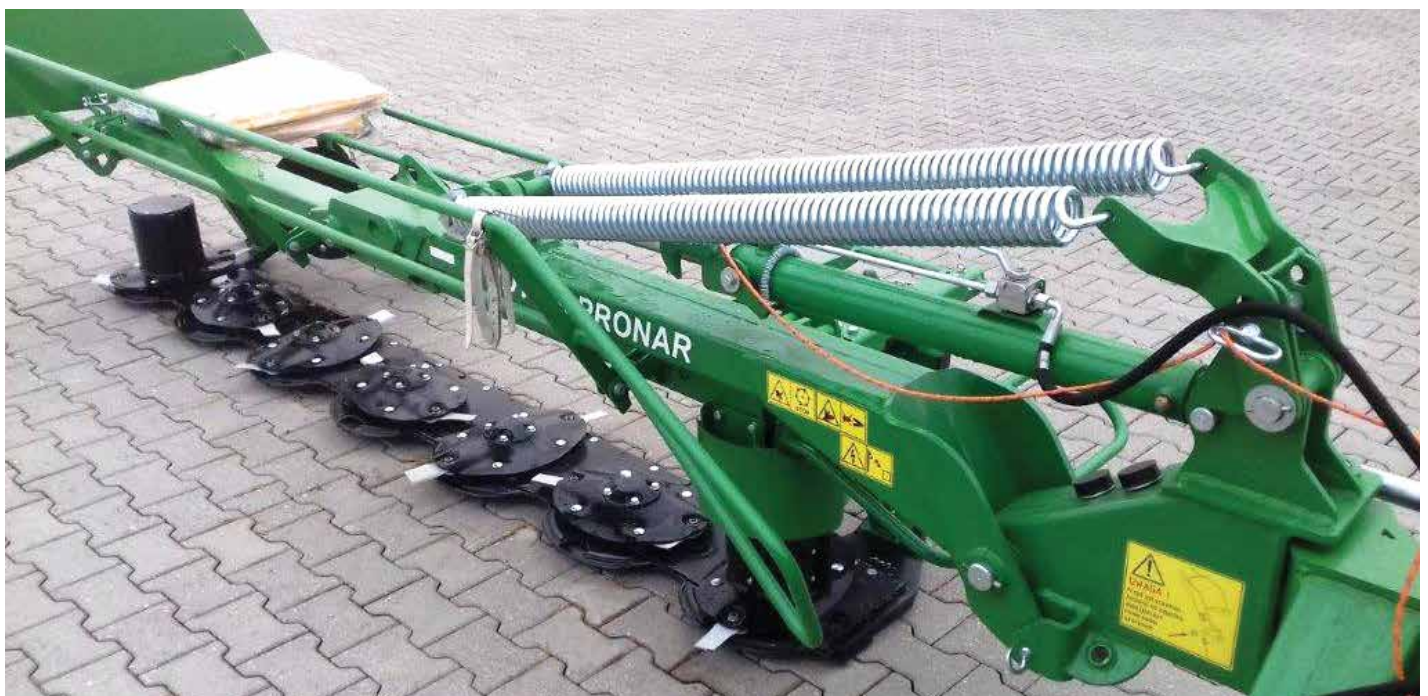
↑ Centralny układ zawieszenia listwy tnącej
