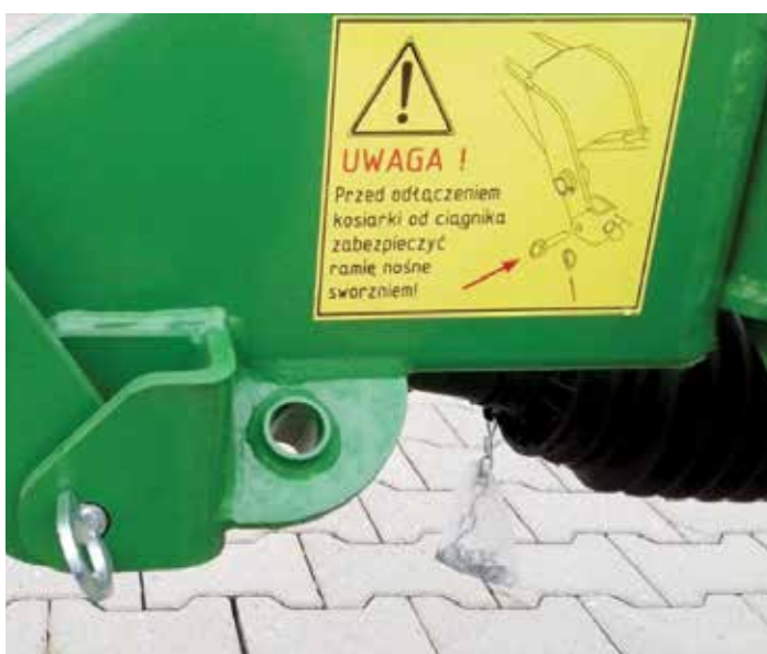
↑ Sworzень blokujący ramę kosiarki (w pozycji magazynowej)
