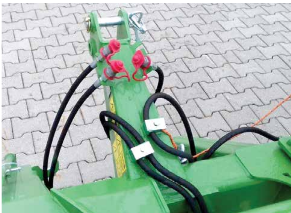
↑ Dwie pary wyjść hydraulicznych do sterowania położeniem kosiarki
