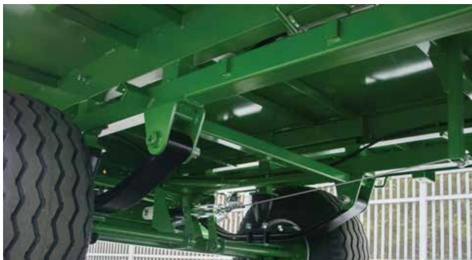
↑ Wydłużoną żywotność zapewnia stabilne i mocne zawieszenie na resorach parabolicznych
