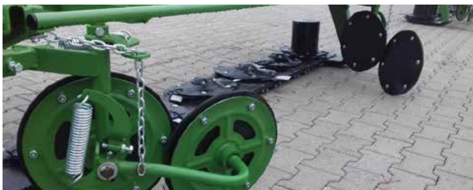
↑ Podwójne talerze zgarniające w kosiarkach PDT300 i PDT340 (stosowane także w kosiarce PDT260 jako wyposażenie opcjonalne)
