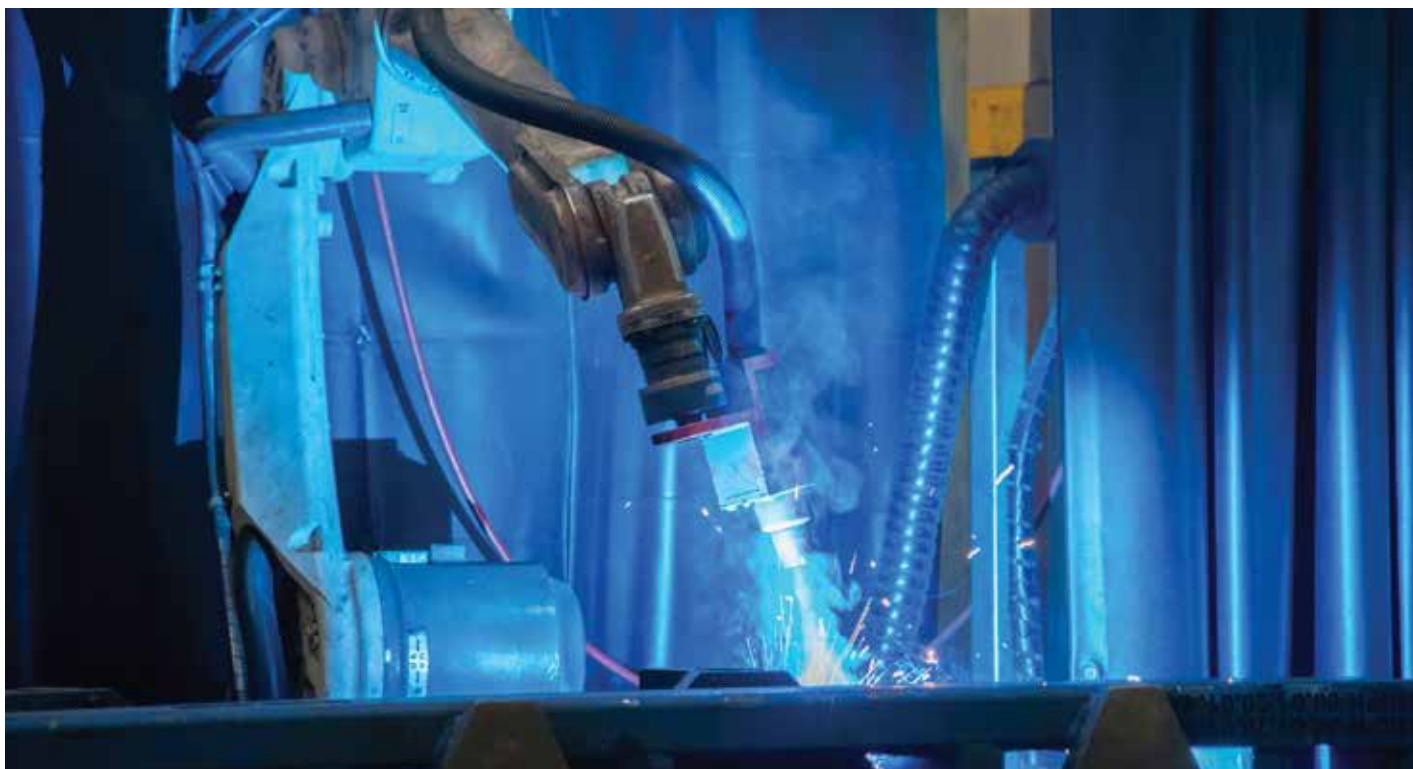
↑ Główne elementy kosiarki dyskowej są spawane za pomocą robotów spawalniczych
