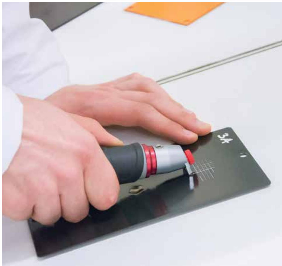
↑ Badanie przyczepności powłoki malarskiej metodą siatki nacięć przy pomocy noża wielostrzężowego
