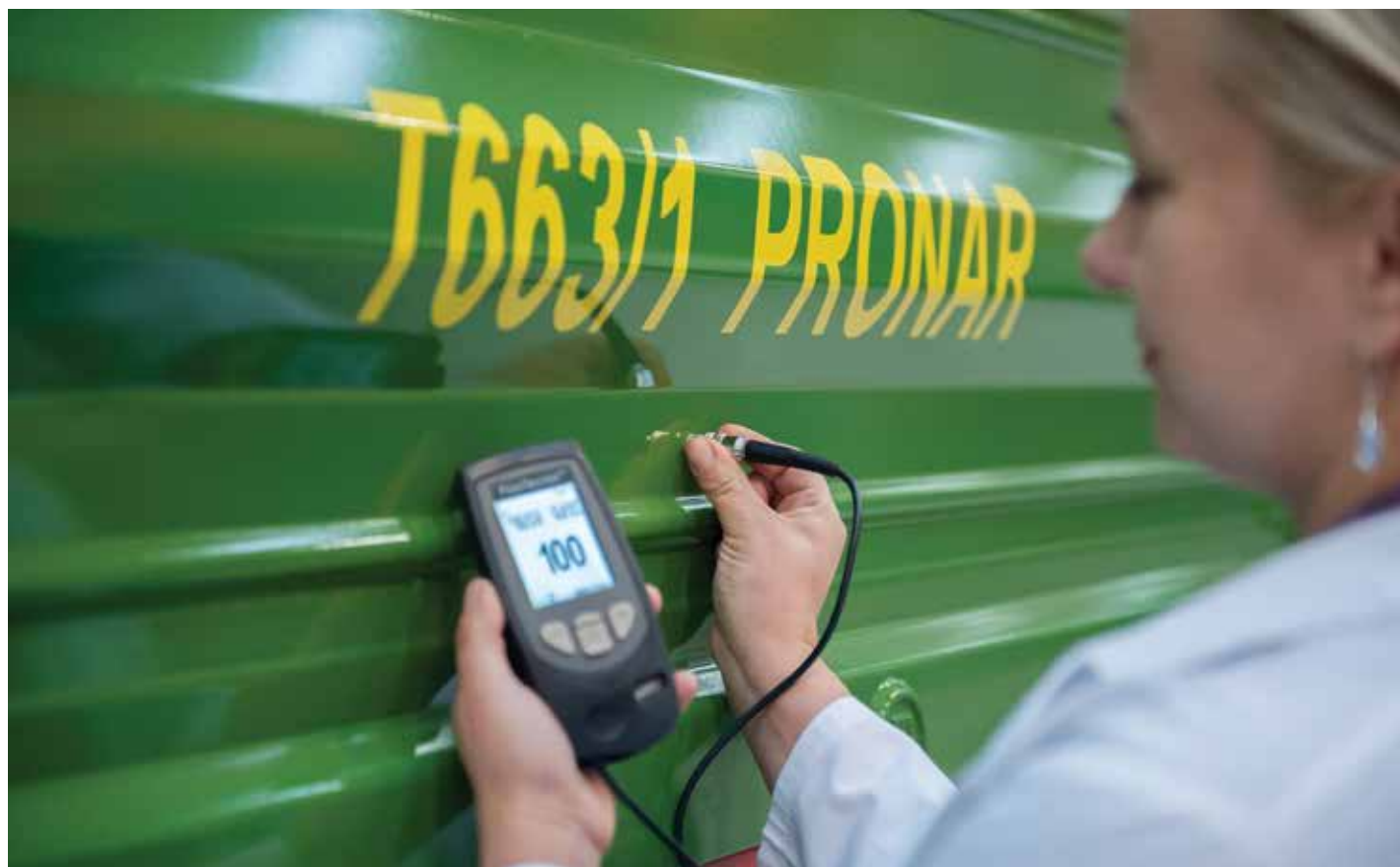
↑ Pomiar grubości powłoki suchej za pomocą warstwowomierza wykorzystującego zjawisko indukcji magnetycznej
