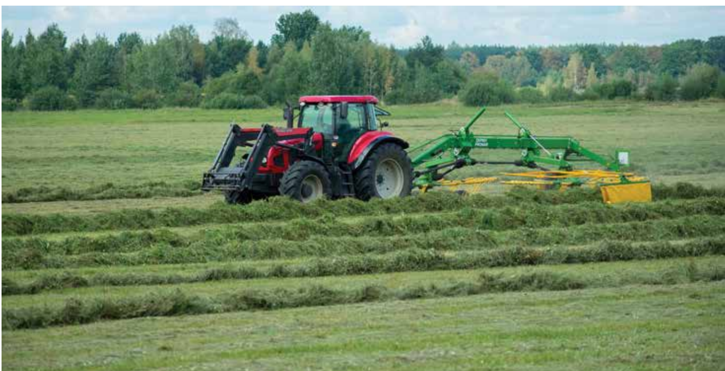
↑ Obie zgrabiarki Pronaru (ZKP900D i ZKP801) można agregować z ciągnikami o mocy nie mniejszej niż 80 KM (na zdjęciu: zgrabiarka zagregowana z ciągnikiem PRONAR 6180)
