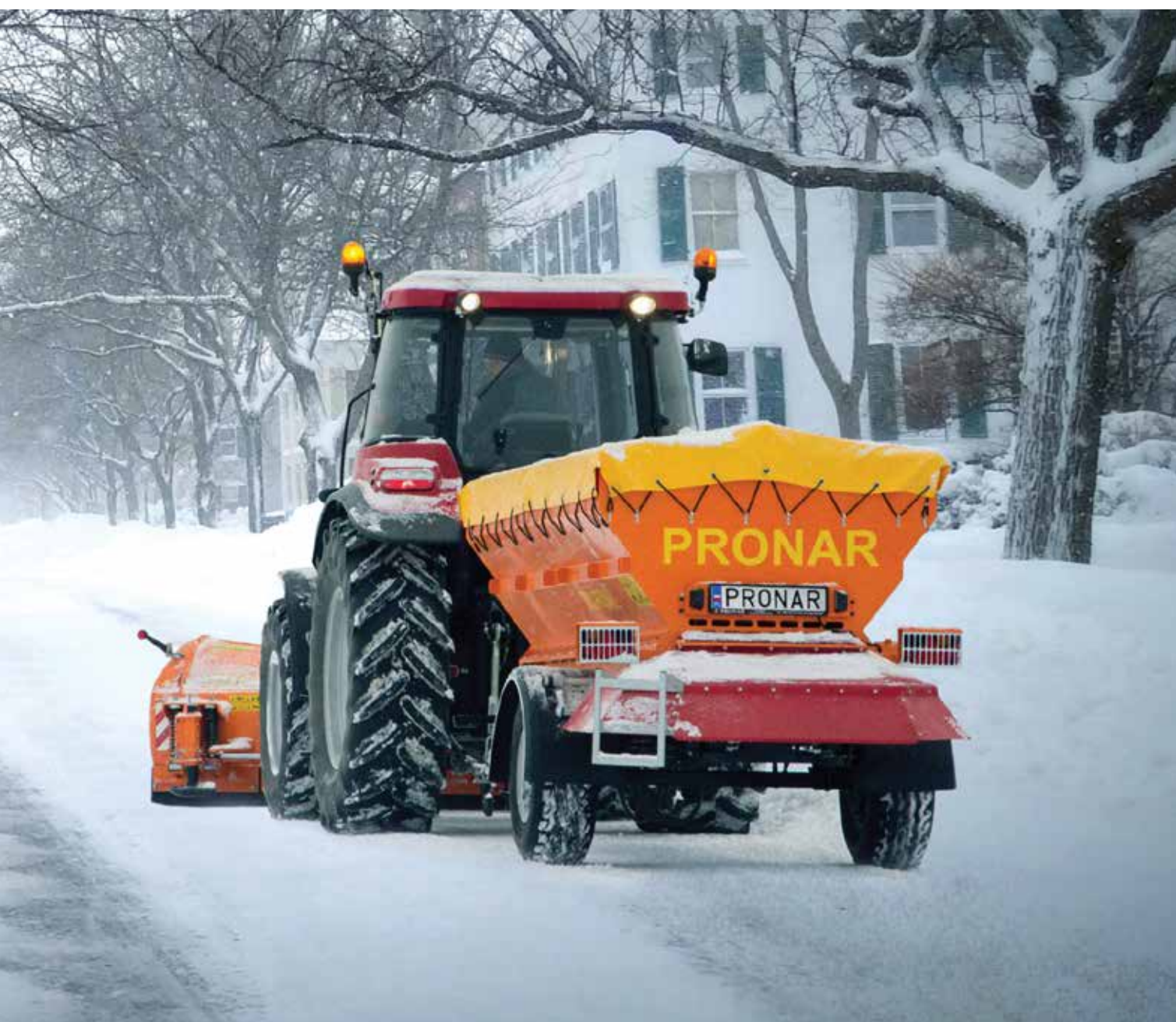
↑ Jednoosiowa posypywarka ciągnioma Pronaru wraz z ciągnikiem i zagregowanym z nim pługiem odśnieżnym PRONAR tworzą bardzo funkcjonalny zestaw do zimowego utrzymania dróg
