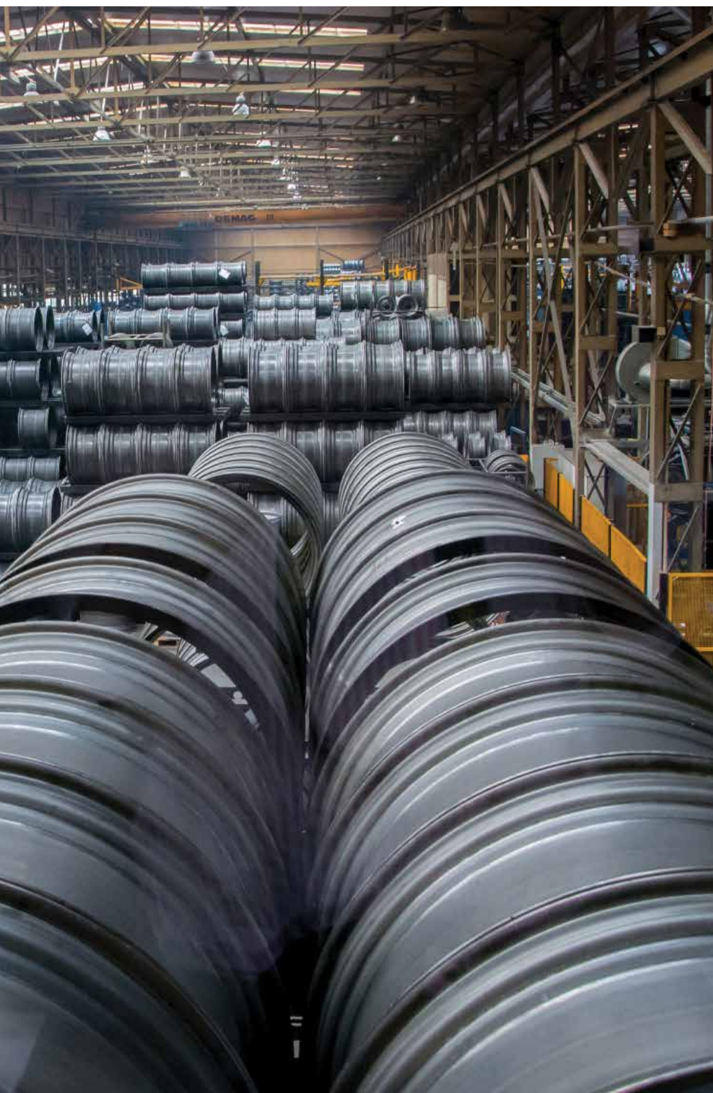
↑ Koła tarczowe składają się z kilku elementów, m.in. obręczy (na zdjęciu)
