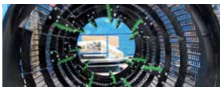
↑ Noże rozrywające worki mogą być zamontowane we wszystkich bębnach przesiewaczy
