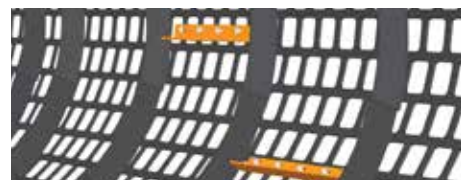
↑ Progi montowane w bębnie przesiewacza pomagają dokładniej oczyszczać materiał
