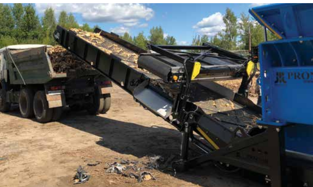
↑ Separator magnetyczny pomaga wyodrębnić materiały ferromagnetyczne
