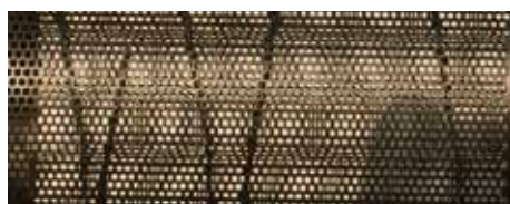
↑ Dzięki siatce opasującej bęben możliwe jest wykonanie sita o perforacji mniejszej niż 10 mm
