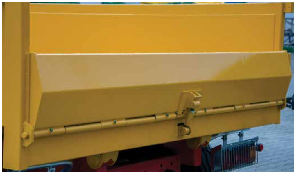
↑ Skrzynie przyczep budowlanych Pronaru wykonano ze stali typu Hardox
