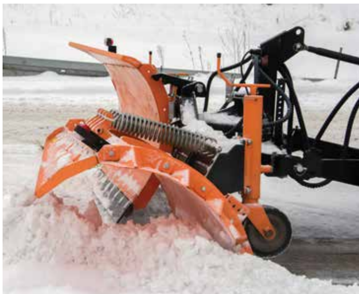
↑ Pługi mogą być wyposażone w łamane odkładnice z zabezpieczeniem sprężynowym. Na zdjęciu pług PUV-3300
