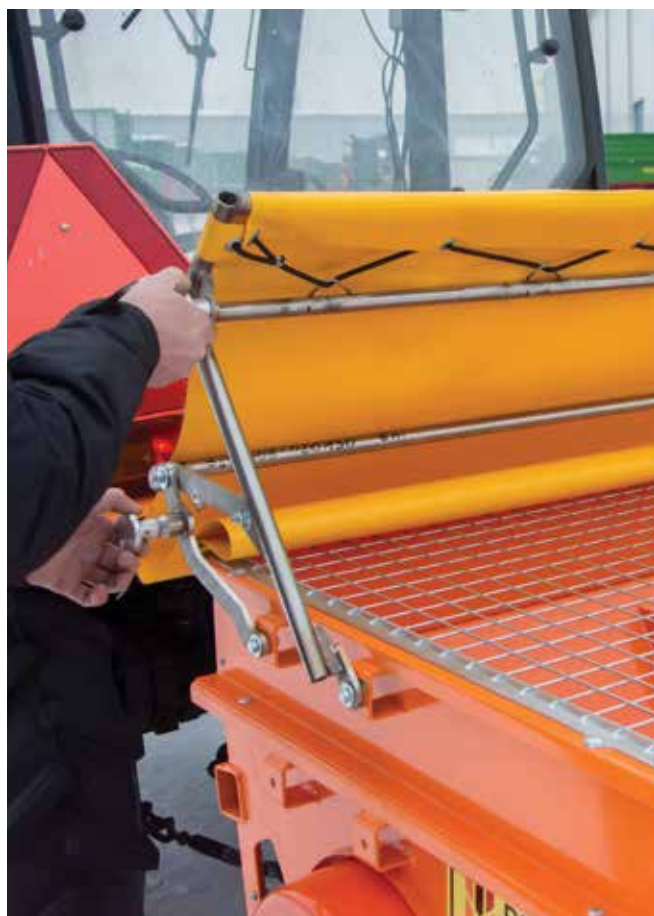
↑ Stelaż z plandeką zamontowany do zasobnika lub jego nadstawy, na której umieszczona jest kratka zabezpieczająca
