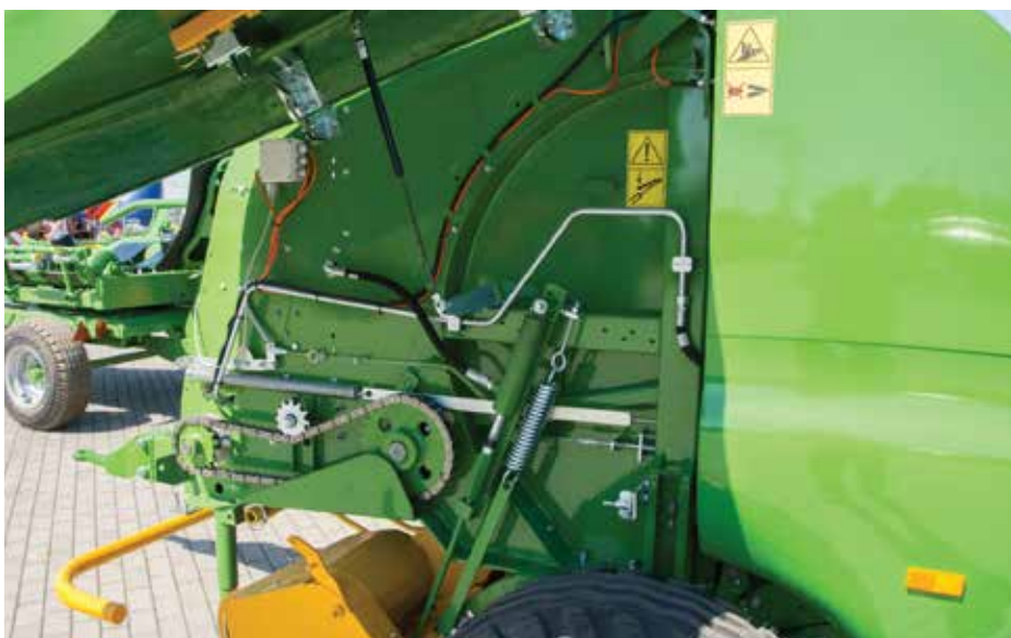
↑ Owijarki Pronaru wyposażono w łatwe do podniesienia osłony boczne, co pozwala na szybką ocenę stanu ważnych elementów maszyny
