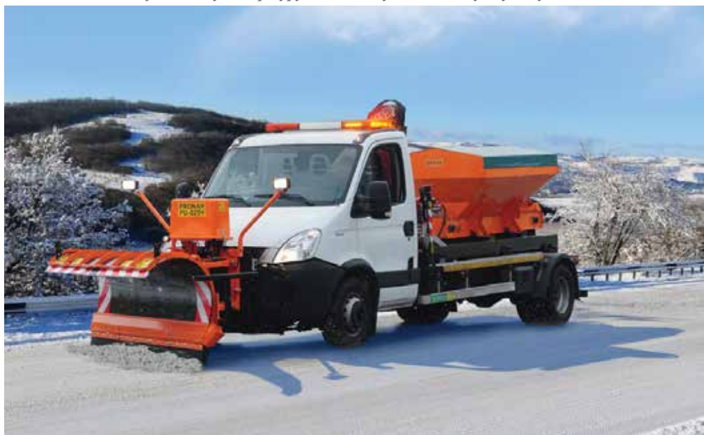
↑ Posypywarki serii EPT można montować na samochodach, które nie muszą być do tego specjalnie przystosowane
