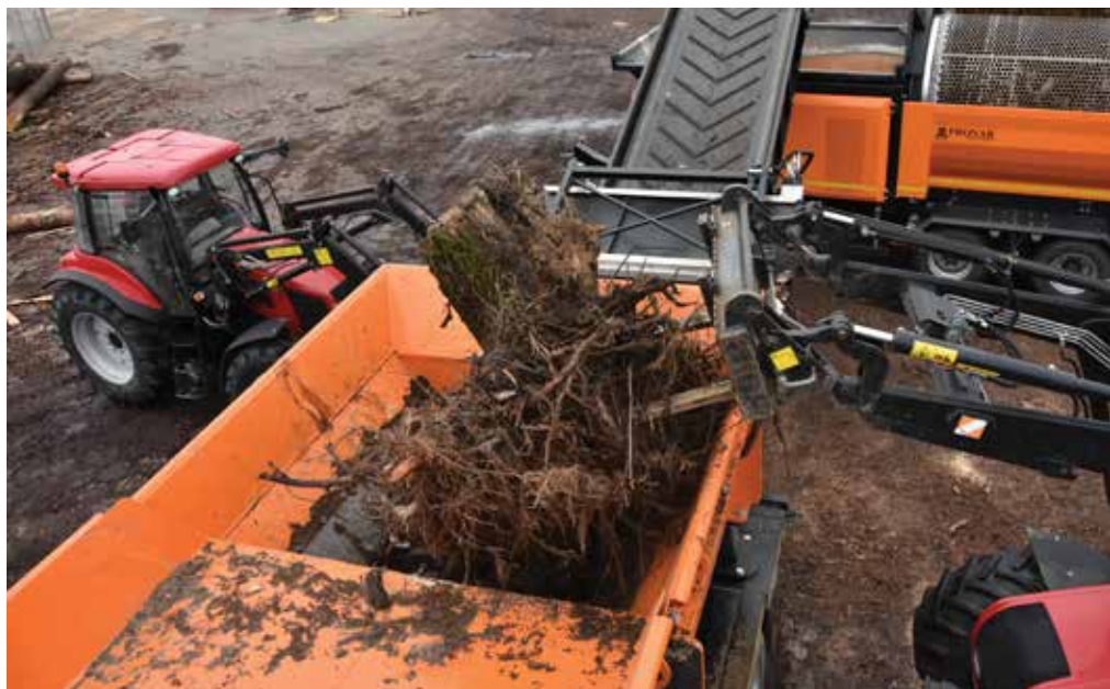
↑ System rozdrabniania tworzą dwa wały tnąco-rozdrabniające. Ich parametry wynoszą: długość - 1700 mm, szerokość - 685 mm
