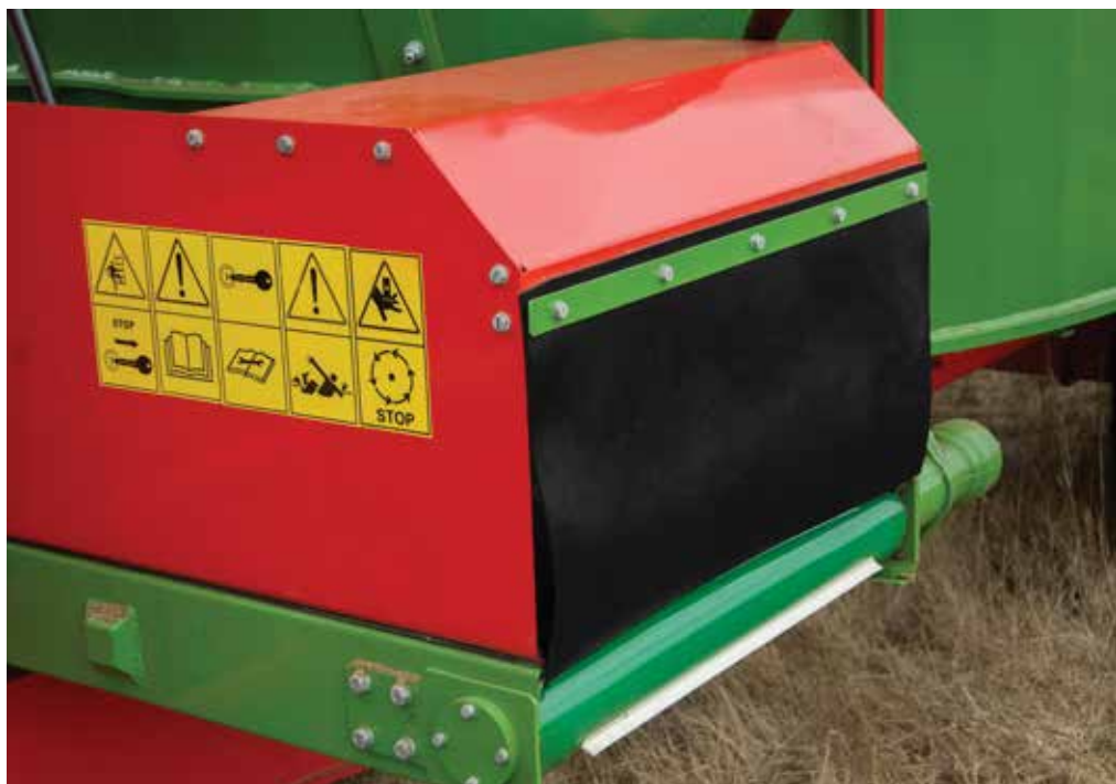
↑ System z poprzeczną taśmą wyładowniczą montowaną z przodu zbiornika pozwala na dozowanie paszy zarówno na lewą, jak i prawą stronę
