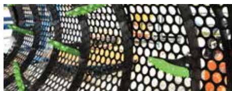
↑ Noże rozrywające worki mogą być zamontowane we wszystkich bębnach przesiewaczy
