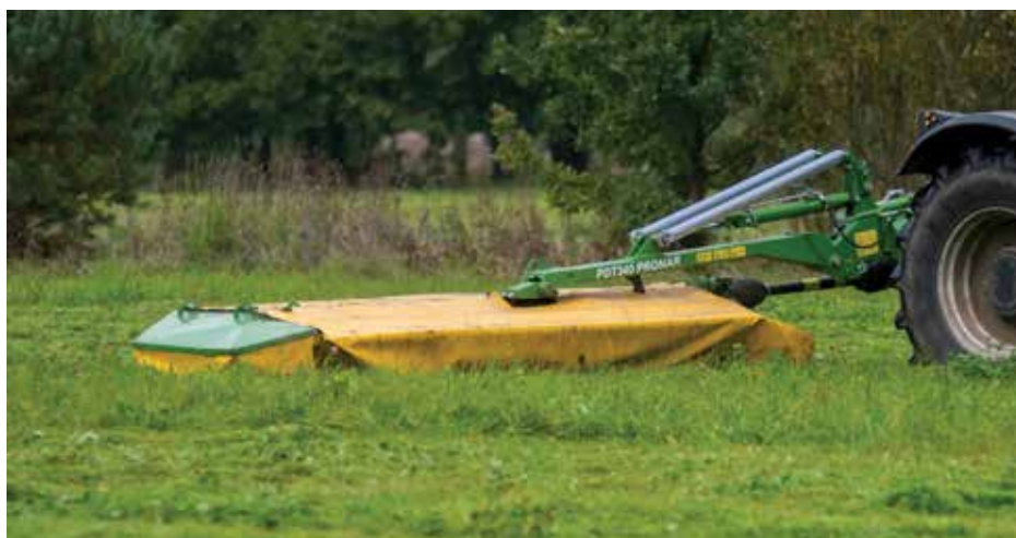
↑ Elementy znajdujące się w bezpośrednim kontakcie z glebą i koszonymi roślinami zostały wykonane z hartowanej stali borowej
