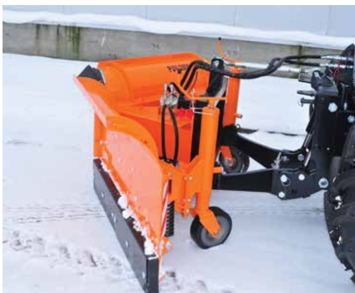
↑ Gumowe koła podporowe mają bezstopnią regulację. Na zdjęciu: pług PUV-2800
