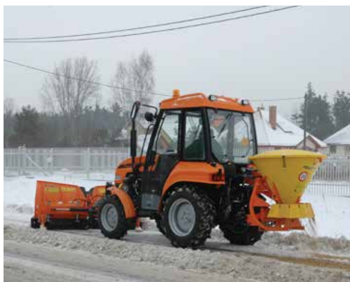
↑ Oprócz dróg osiedlowych, odśnieżone muszą być także chodniki. Tu pomagają w tym pług PU-1700 oraz posypywarka PS-250
