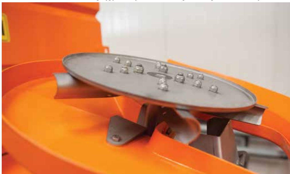
↑ Tarcze rozsiewające w obydwu posypywarkach wykonano z wytrzymałych materiałów
