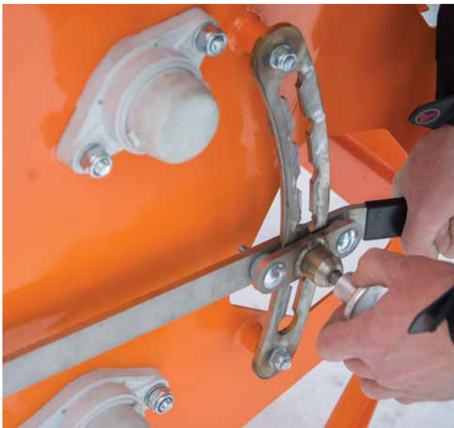
↑ Regulacja docisku przesłony do walca jest bardzo prosta
