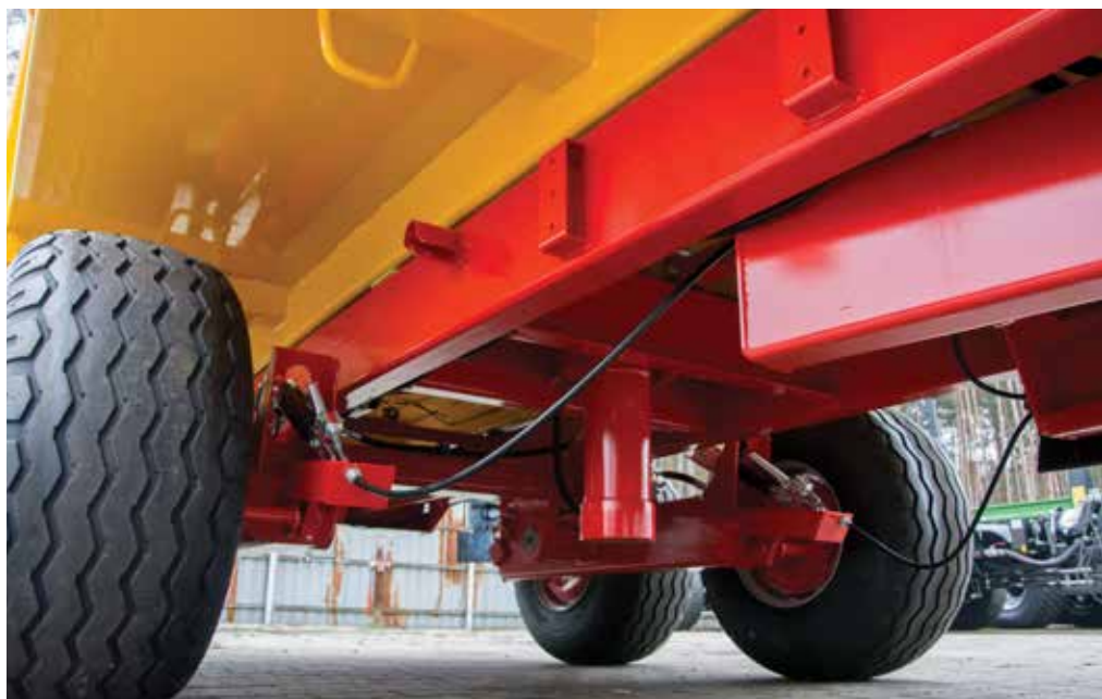
↑ Dużą wytrzymałość przyczep gwarantuje wykorzystanie solidnych profili zamkniętych
