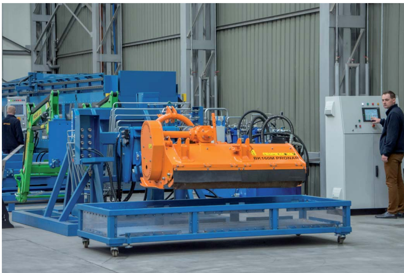
Przekładnie kątowe montowane w kosiarkach bijakowych podlegają wyczerpującym testom
