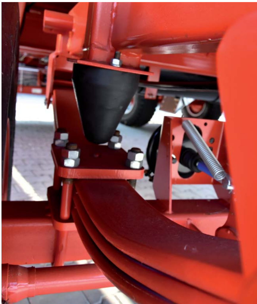
Zawieszenie jest oparte na resorach parabolicznych, z których każdy jest wyposażony w trzy pióra zwiężające się na końcach. Dzięki takiej budowie resory nie wymagają smarowania
