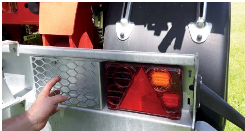
Wyposażenie belki tylnej w oświetlenie typu LED można traktować jako wzorcowe
