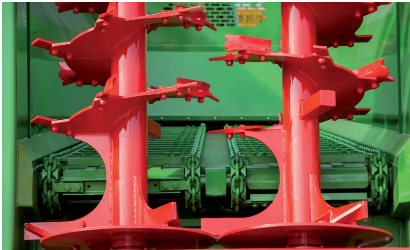
Dwa pionowe walce rozrzucające umożliwiają uzyskanie szerokości roboczej od 8 do 12 m
