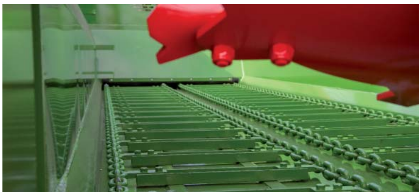
Przenośnik podłogowy jest wyposażony w dwa łańcuchy
