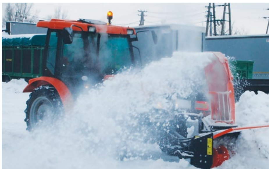
Wysokość robocza odśnieżarki OW 1.5 przekracza pół metra
