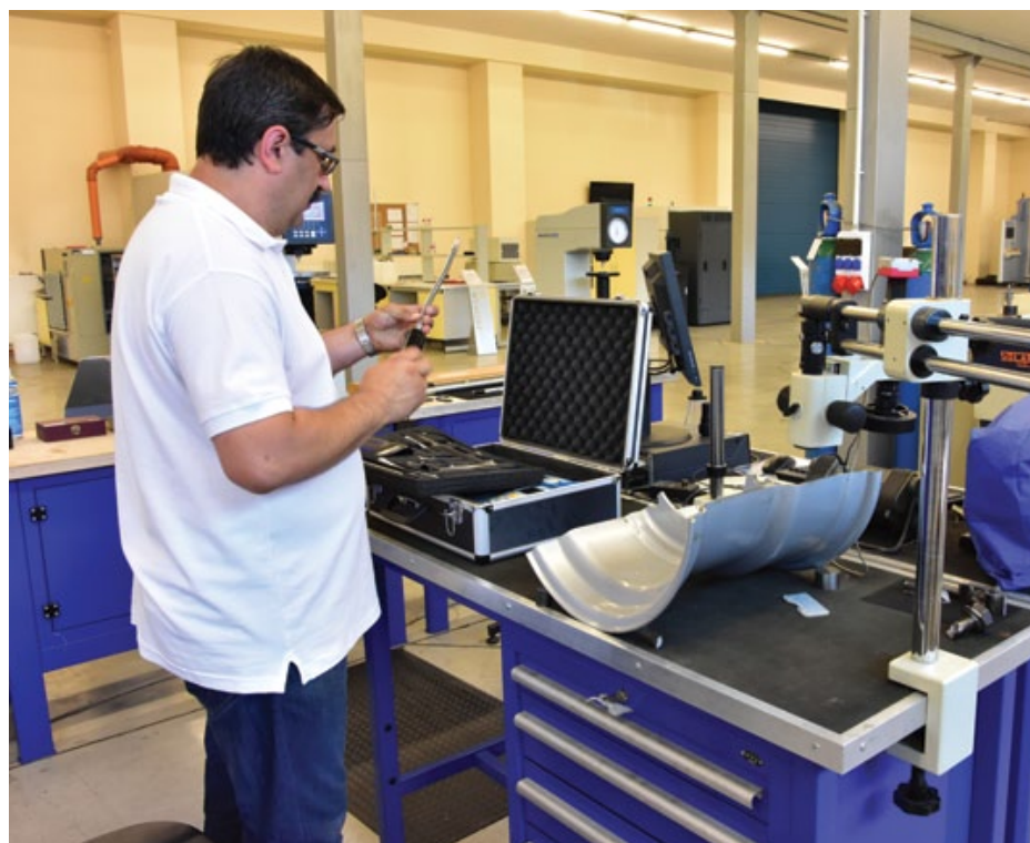
Kierownik Laboratorium Andrzej Szymaniuk przeprowadza badanie spoin felgi
