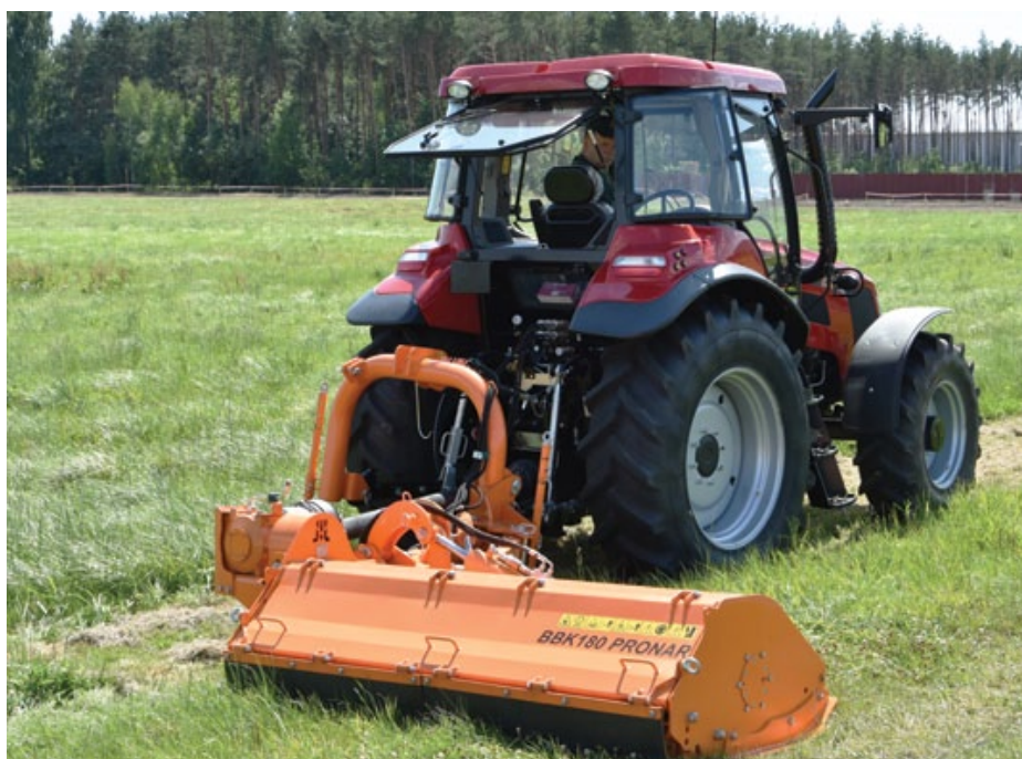
Kosiarki BBK Pronaru posiadają mechaniczne zabezpieczenie przeciwnajzdowe
