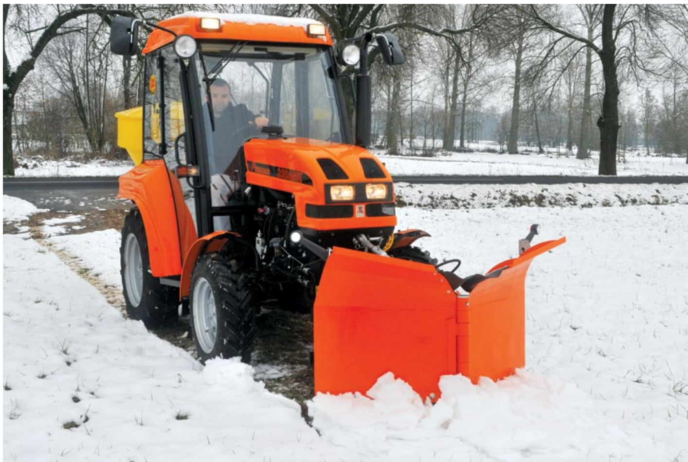
Użytkownikom mniejszych ciągników Pronar proponuje jeden z pługów łamanych: PUV-1400
