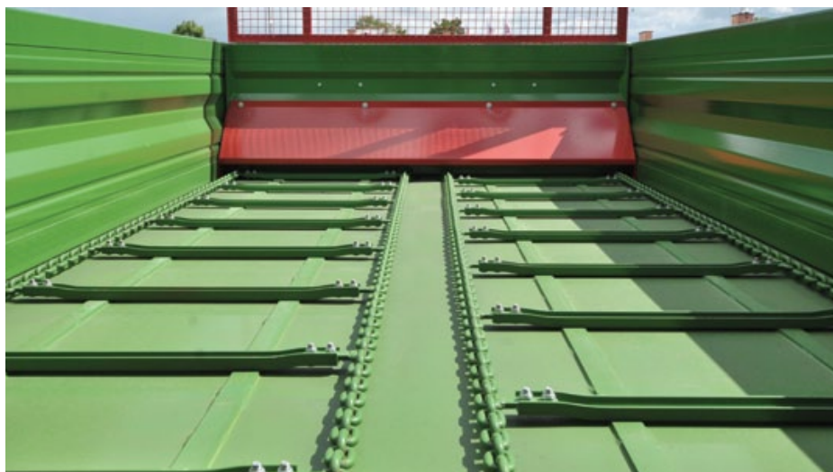
W zmodernizowanych modelach zastosowano mocniejsze sprężyny do napinania łańcuchów
