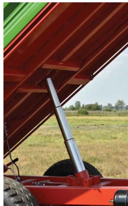
Przyczepa jest standardowo wyposażona w mechanizm trójstronnego wywrotu
