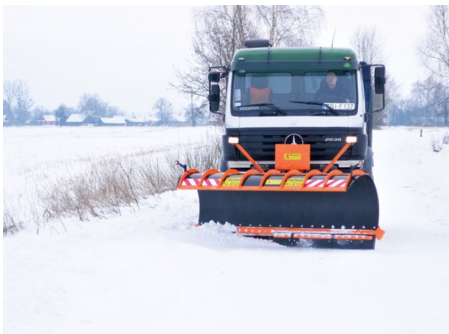
Pług z odkładnicą z tworzywa sztucznego - model PU-S32H
