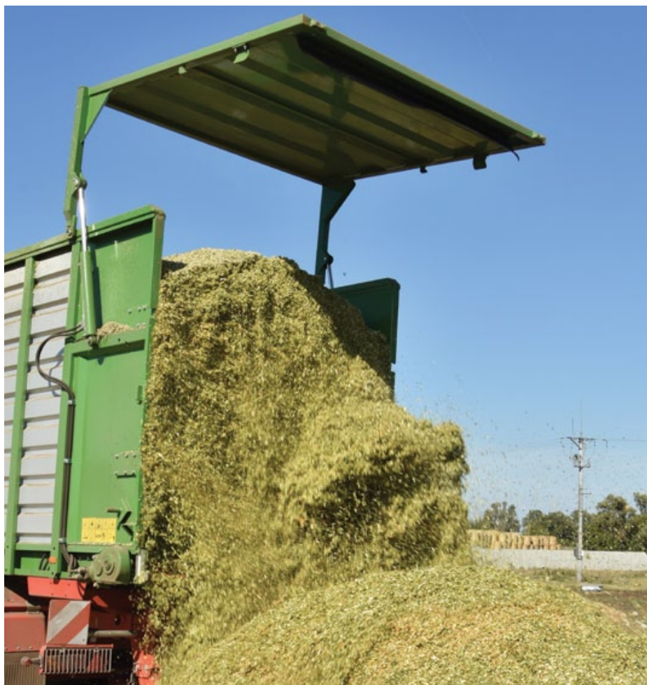
Tylna ściana przyczepy jest otwierana hydraulicznie pod kątem 90°
