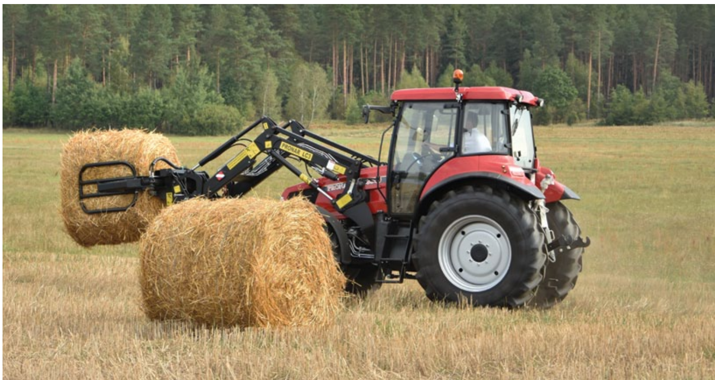
Chwytnak do bel z ładowaczem LC3 i ciągnikiem PRONAR 5340 podczas pracy
