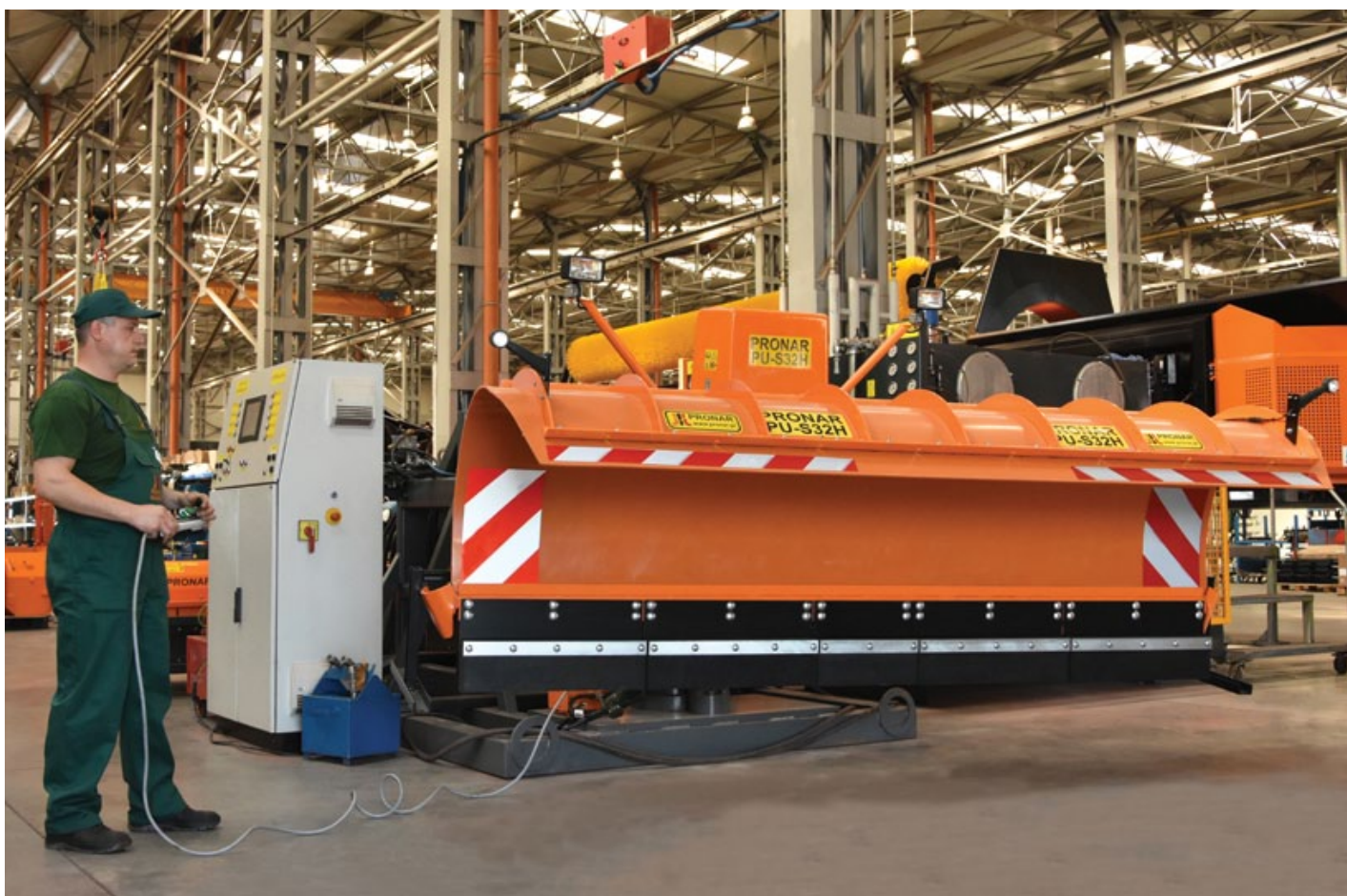
Proces kontroli końcowej na stanowisku diagnostycznym
