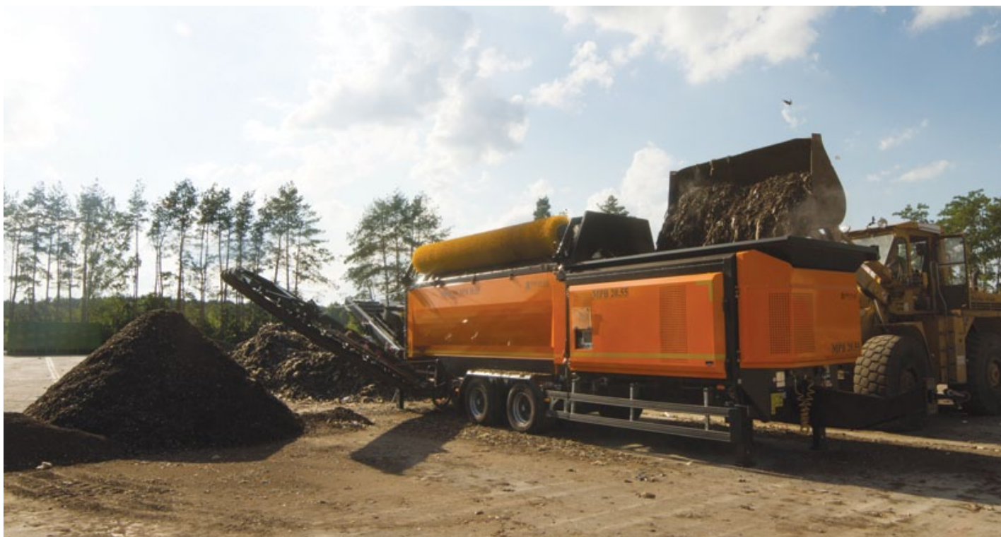
We Francji mobilny przesiewacz bębnowy PRONAR MPB 20.55 jest stosowany do pracy przy materiale drzewnym i separacji trocin
