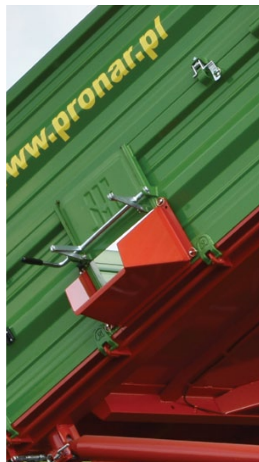
Umieszczone w tylnej burcie okno zsykowe umożliwia wyładunek strumieniowy
