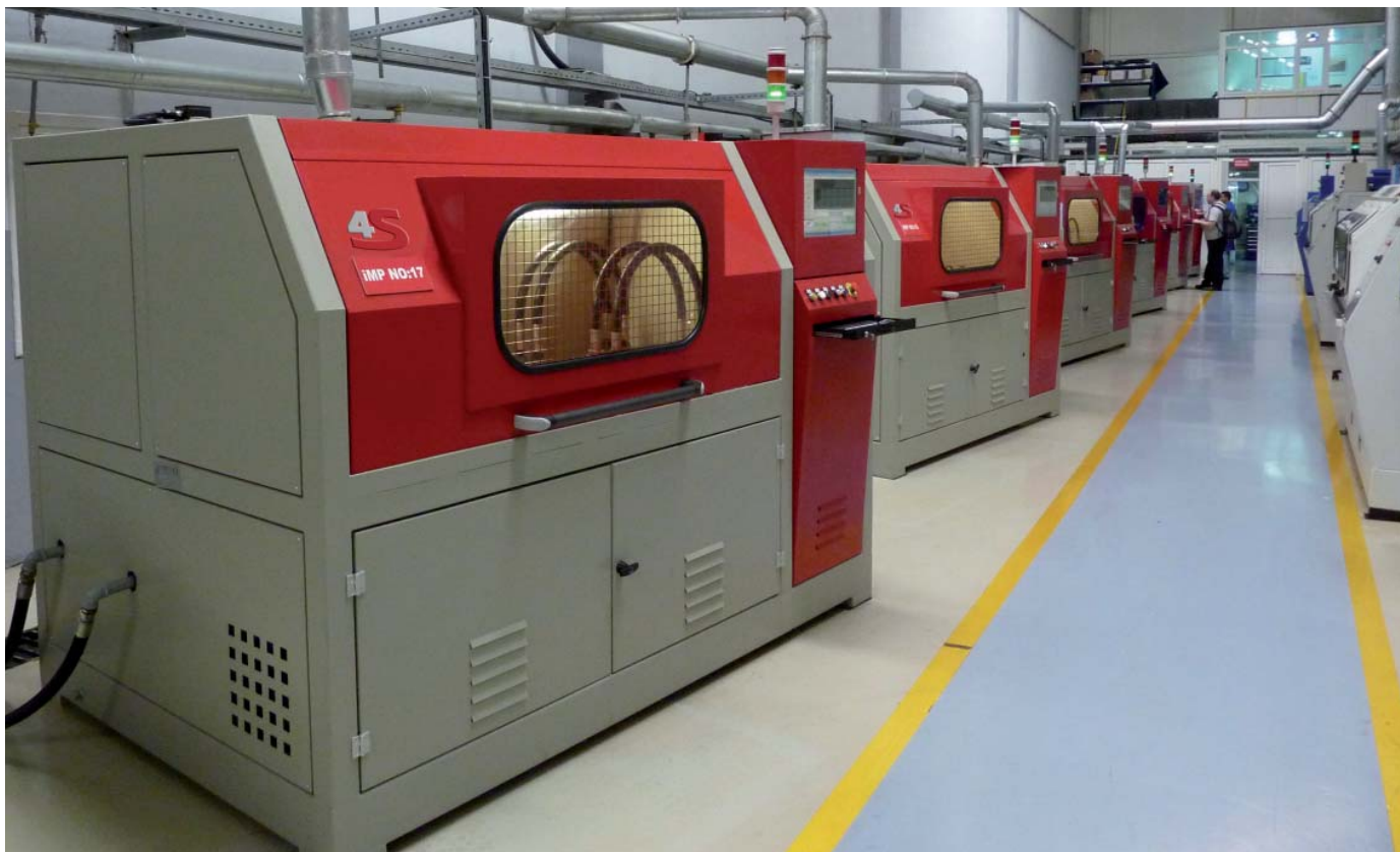
Nowe stanowisko badawcze pozwoli na prowadzenie testów oraz badań złączy hydraulicznych
