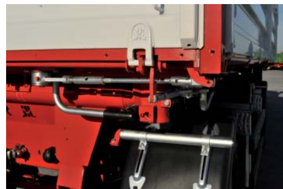
Nowy system ryglowania ścian, odkuwane zawiasy ścian w zmodernizowanej przyczepie T680
