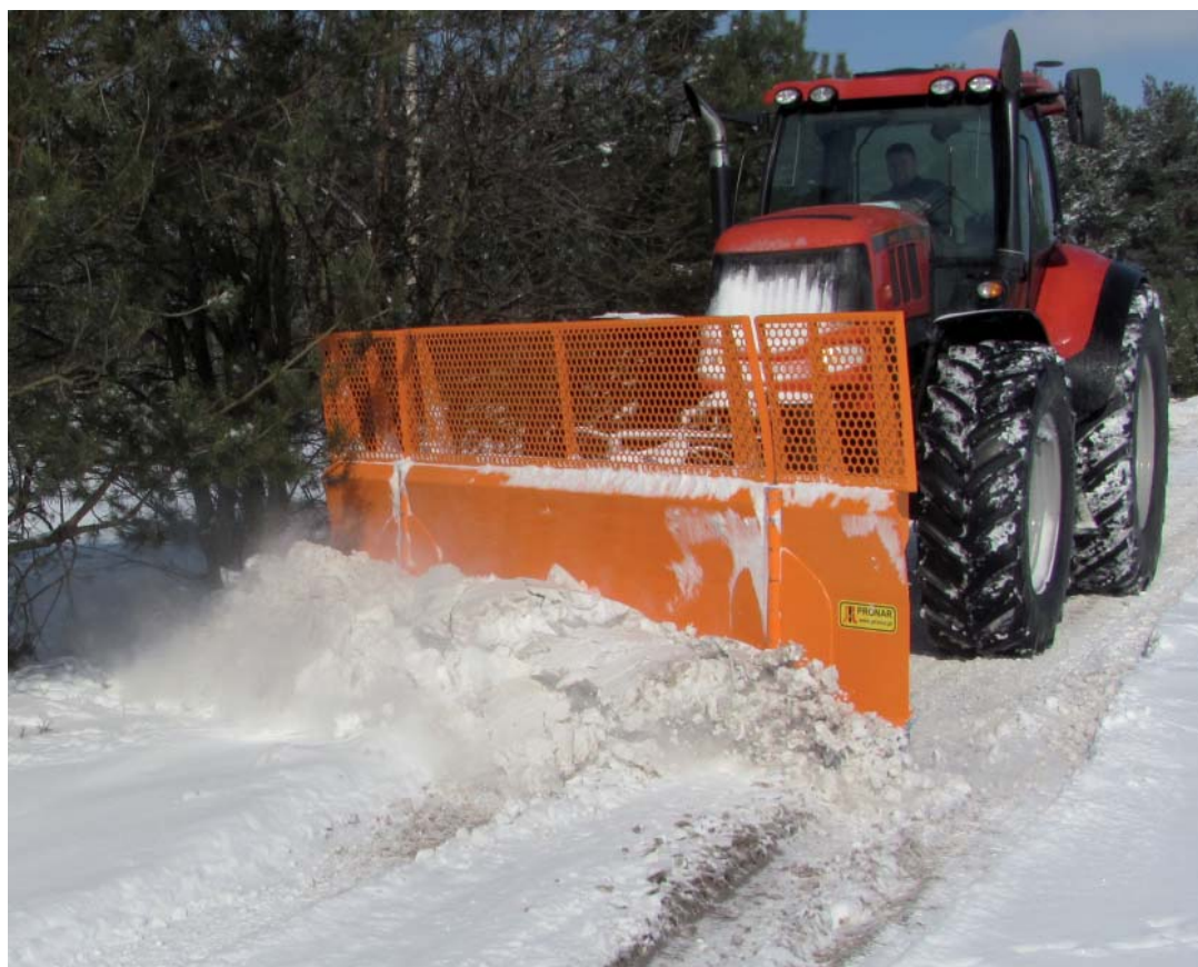
Konstrukcja zgarniaka umożliwia zwiększenie jego funkcjonalności poprzez nadstawy do śniegu, które podwyższają wysokość roboczą do 1050 mm
