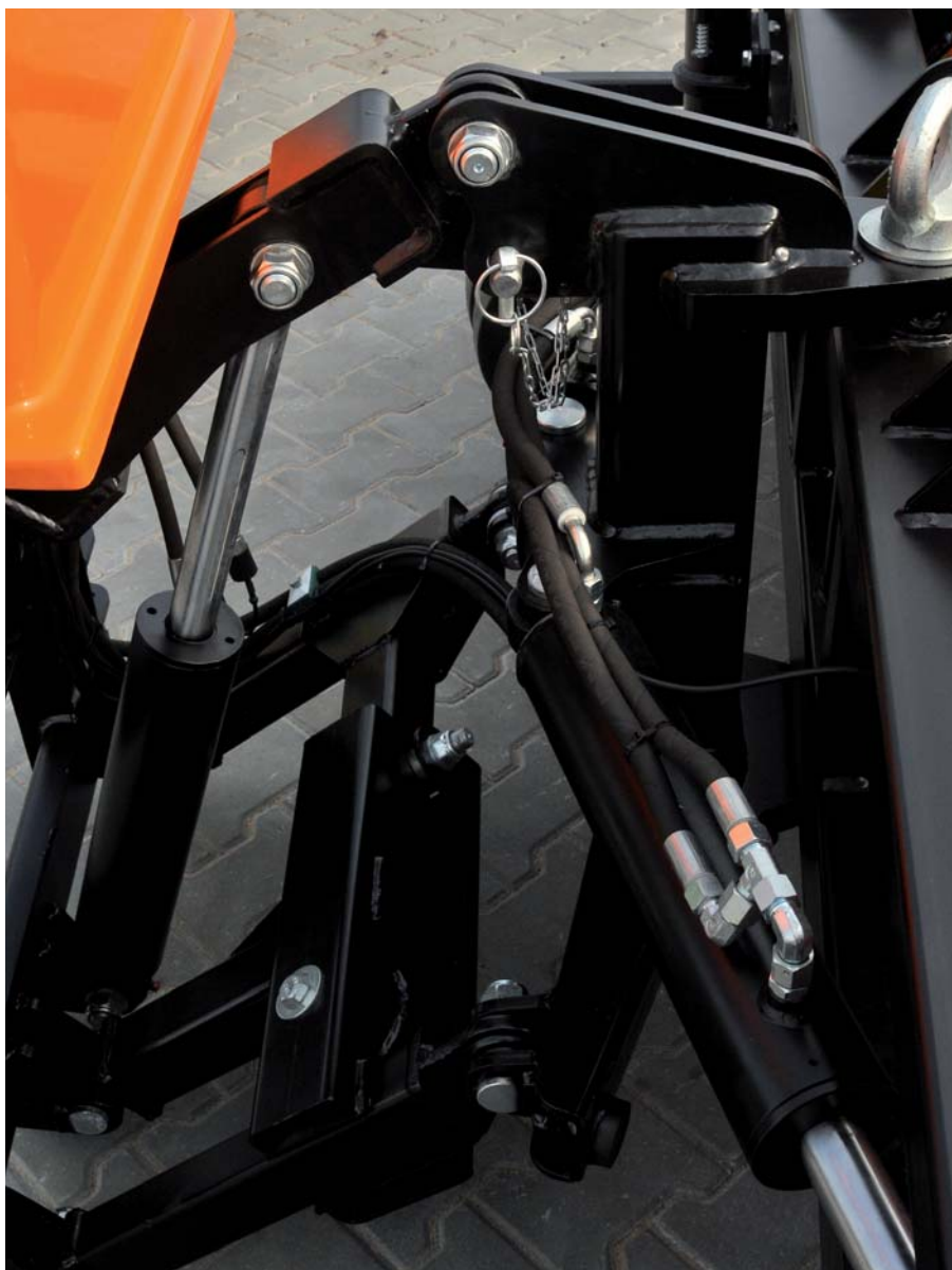
Wahaczowy układ zawieszenia pługów PUS-S
