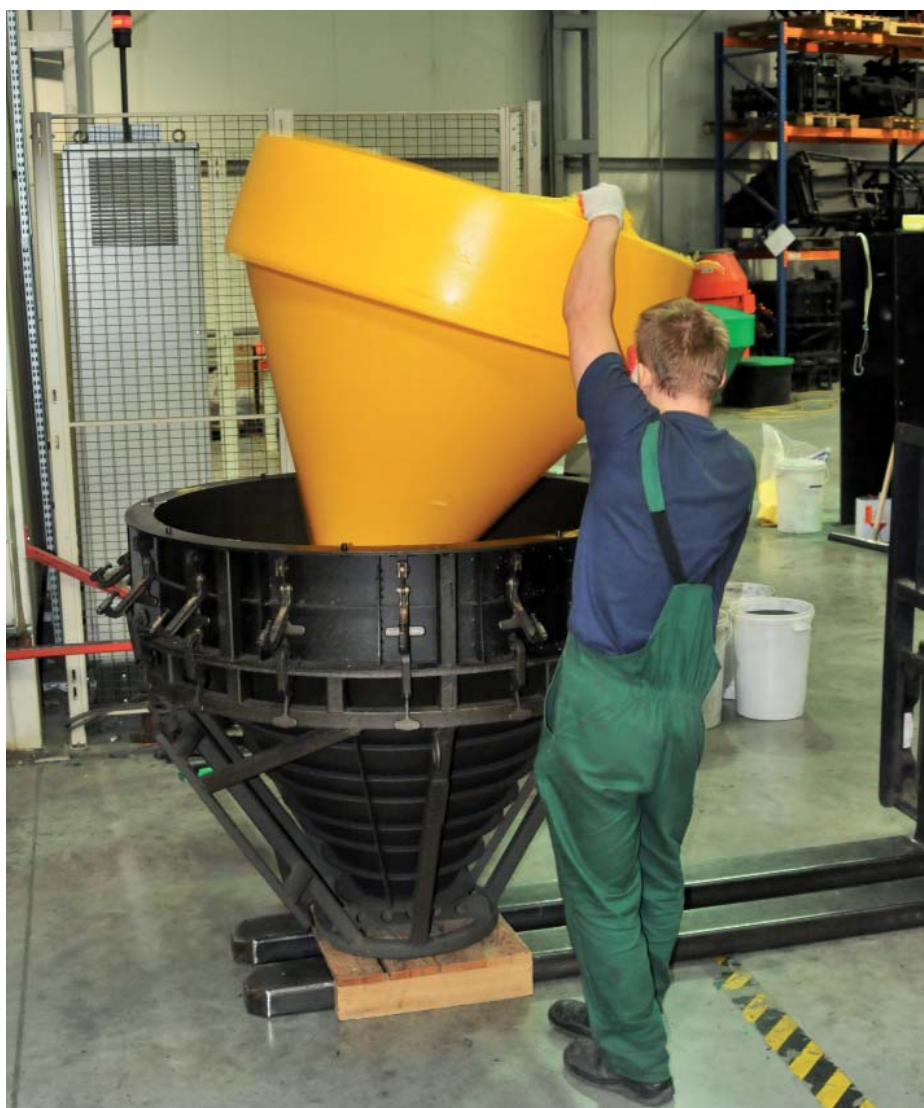
Wewnętrzna powierzchnia kosza, dzięki właściwościom polietylenu, jest bardzo śliska (zmniejsza to możliwość przywierania rozsypywanego materiału)
