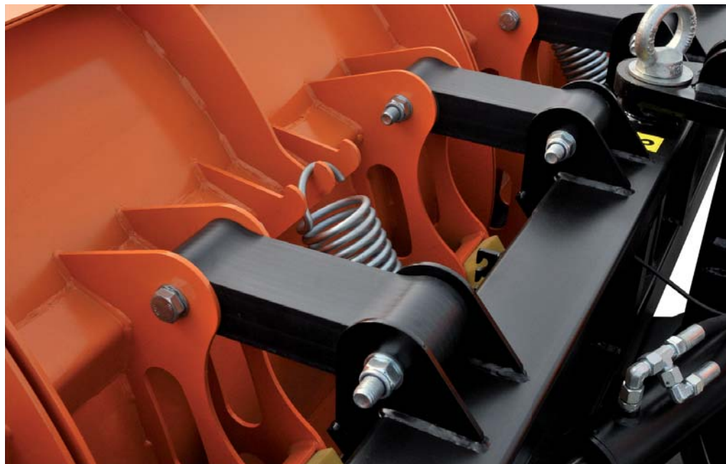
Zabezpieczenie przed uszkodzeniem w przypadku najechania na przeszkodę zapewniają poliuretanowe amortyzatory
