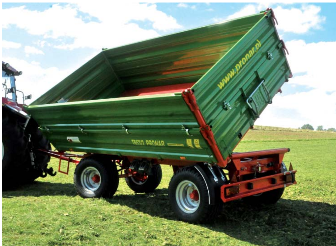
Trójboczny wywrót skrzyni ładunkowej zwiększa funkcjonalność przyczepy
