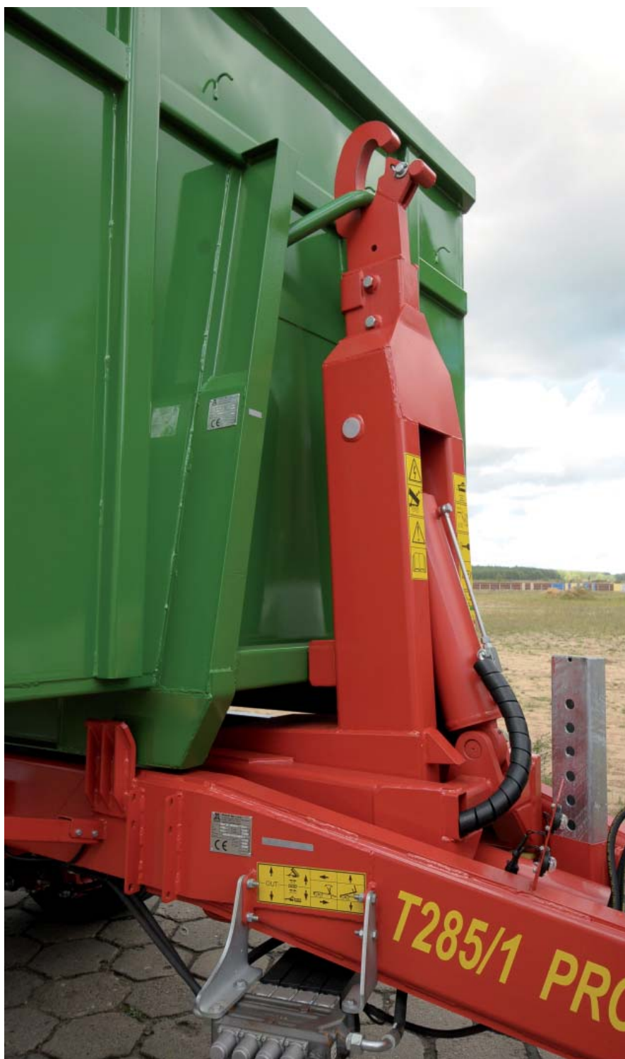
Hak z automatycznym zabezpieczeniem kontenera chroni go przed ześlizgnięciem
