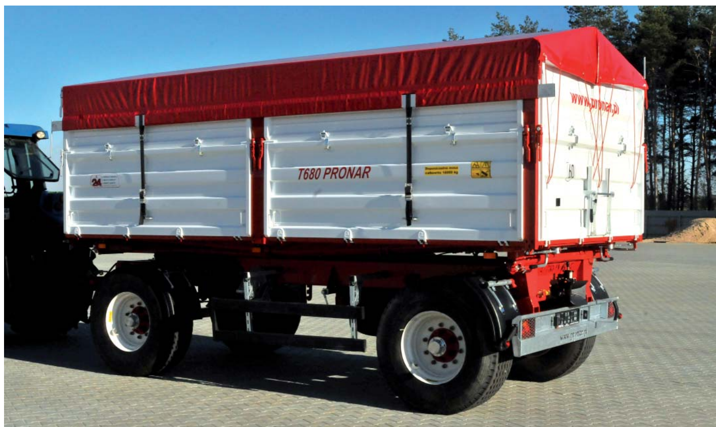
Zmodernizowana przyczepa PRONAR T680 ze ścianami bocznymi dzielonymi słupkiem środkowym i z nową plandeką
