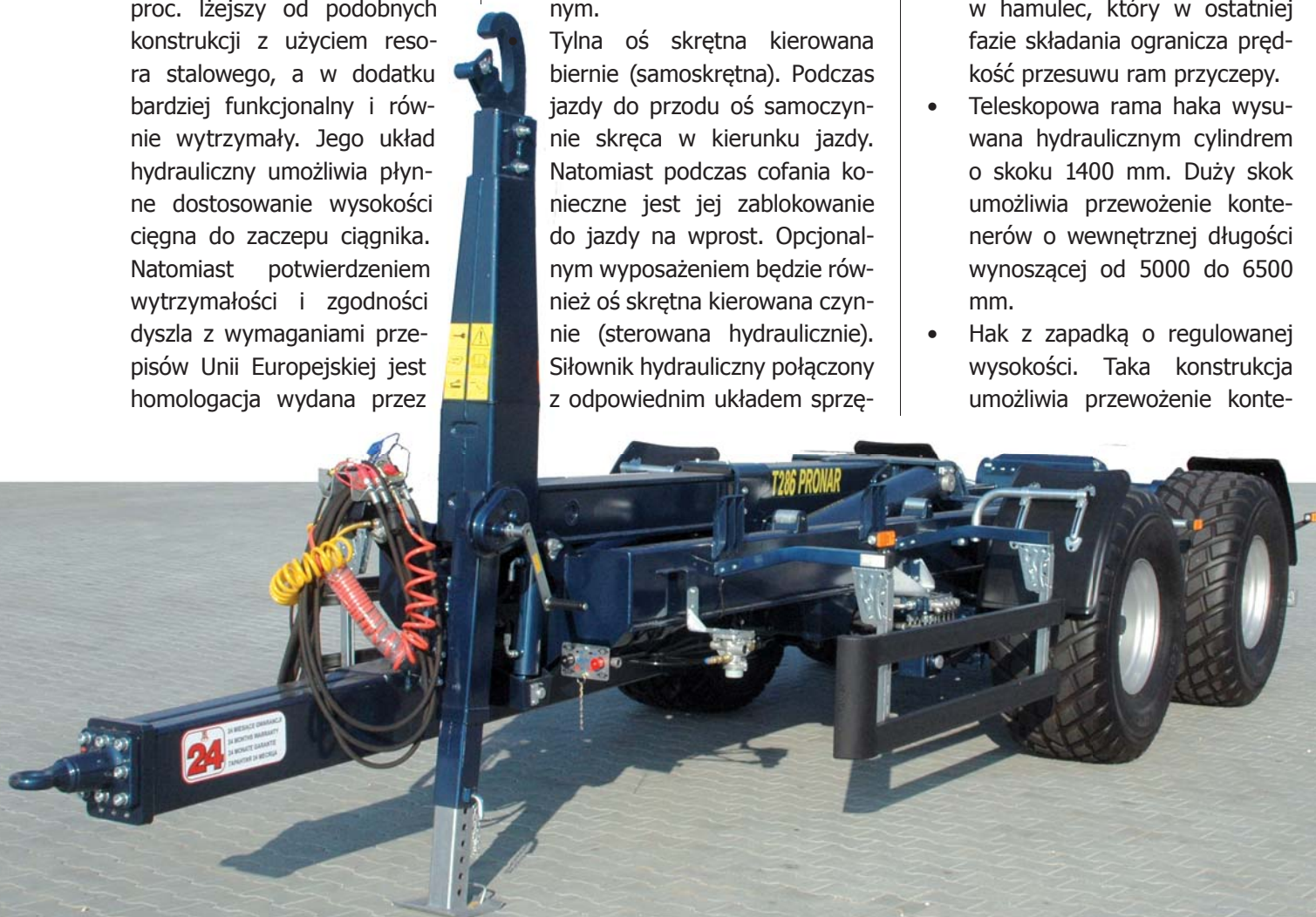
Przyczepa hakowa PRONAR T286. Charakterystyczne cechy konstrukcji: teleskopowa rama haka i dwa hydrauliczne cylindry wywrotu
