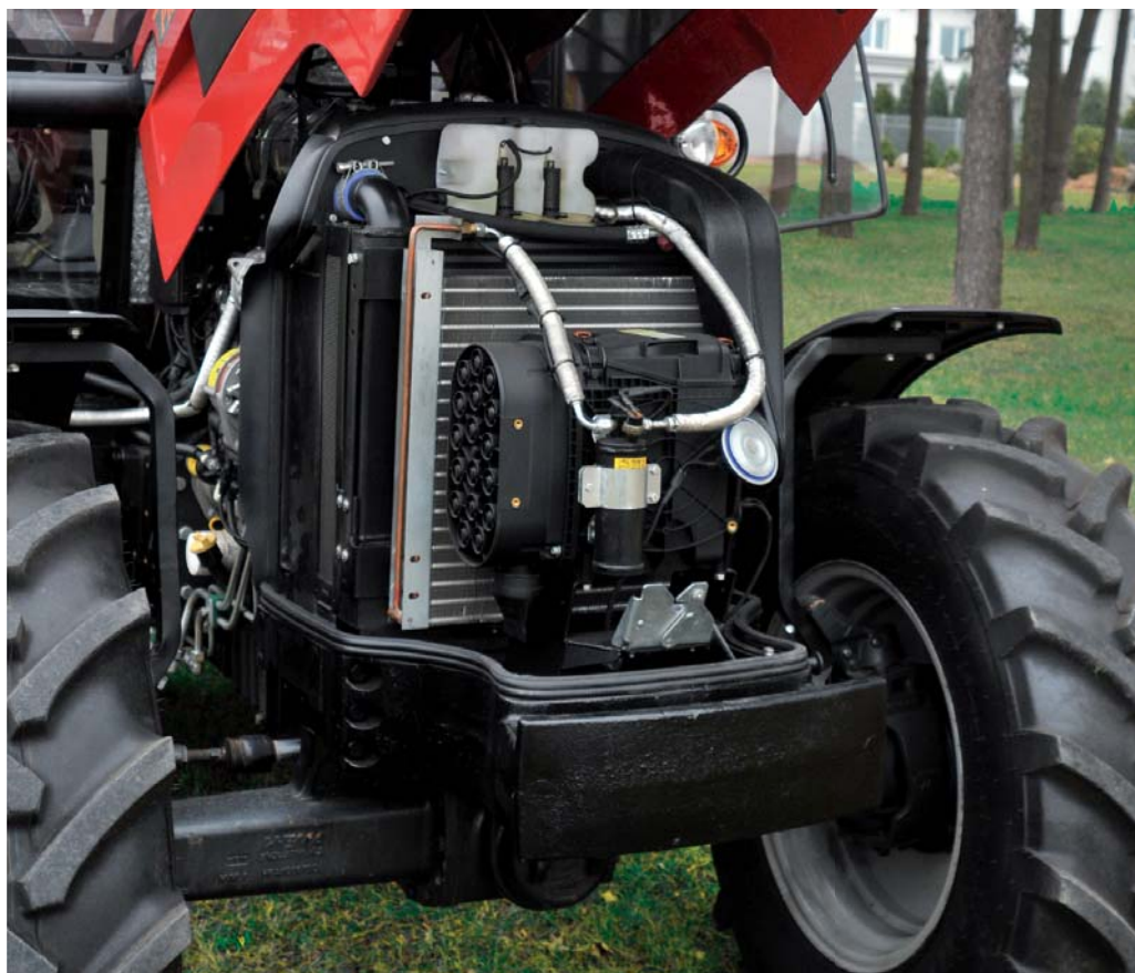
Pod maską ciągnika pracuje oszczędny 4-cylindrowy silnik marki Deutz, spełniający normę toksyczności Stage IIIB
