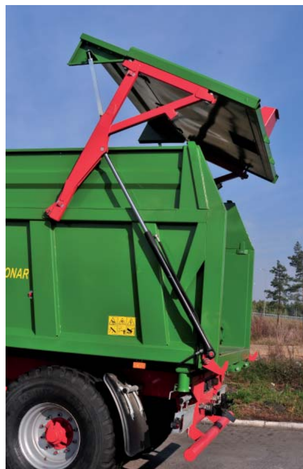
Hydraulicznie unoszona ściana tylna zwiększa szybkość rozładunku
