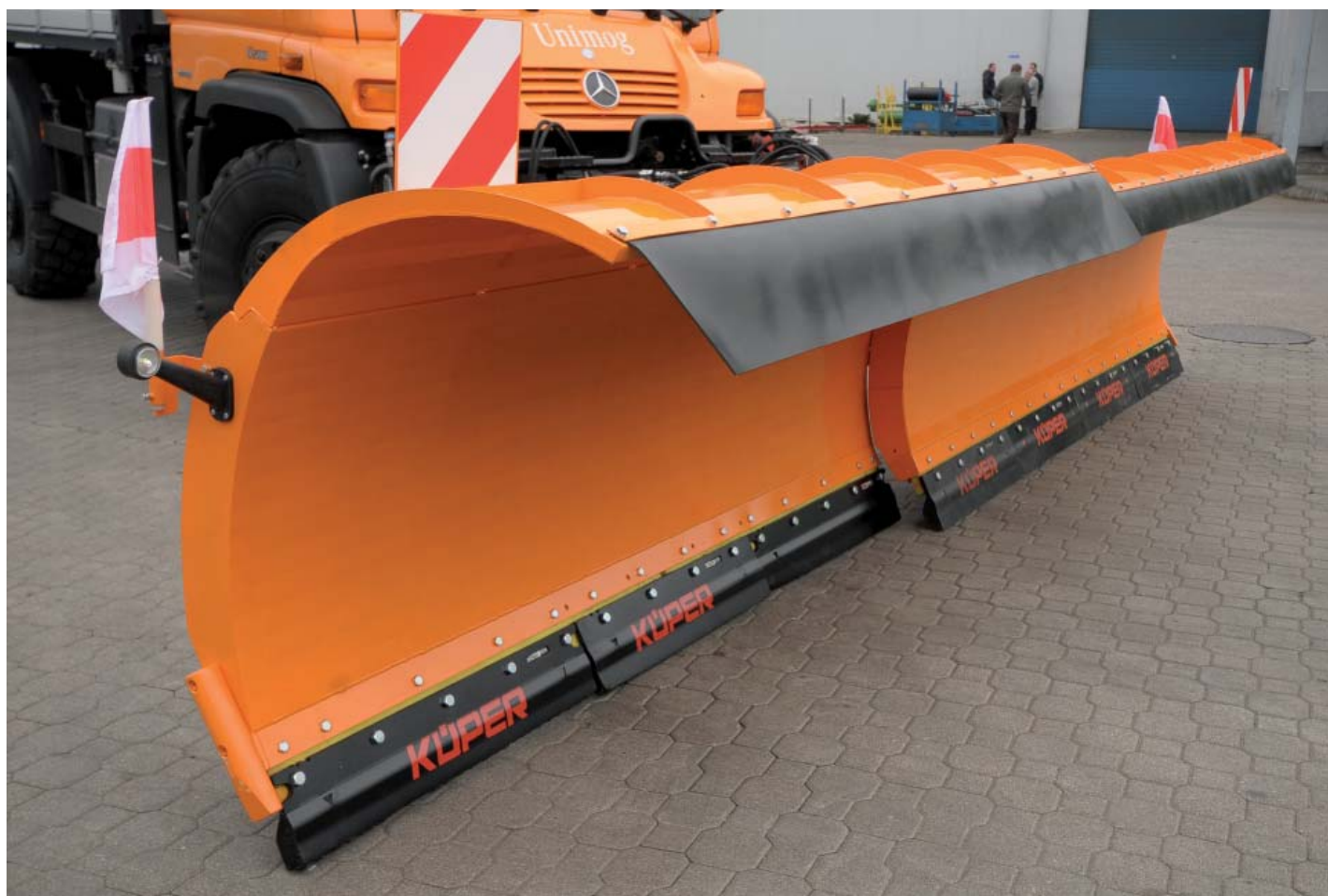
Segmentowa budowa lemiesza gumowego Kuper umożliwia szybki montaż i demontaż
