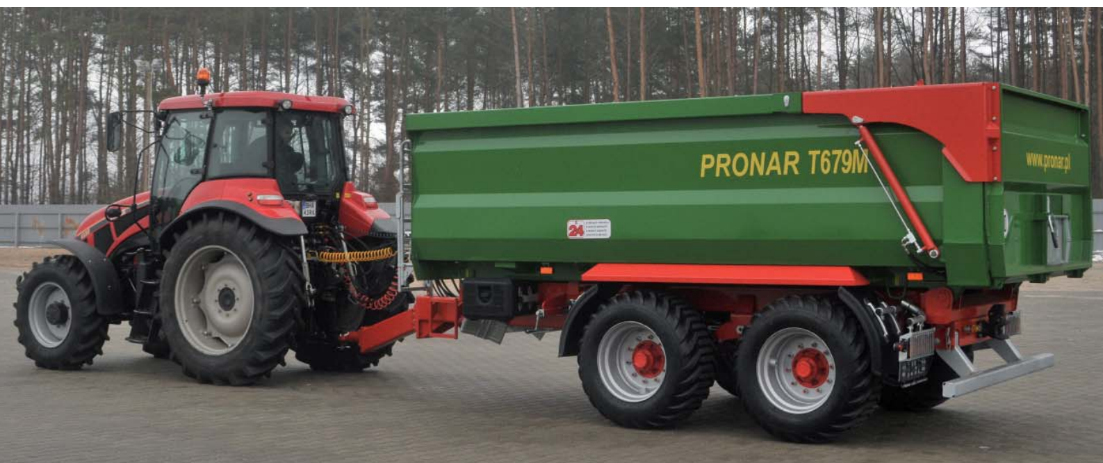
Przyczepa PRONAR T679M ma zwiększony rozstaw kół, dzięki czemu lepiej porusza się po nierównościach i pochyłościach terenu
