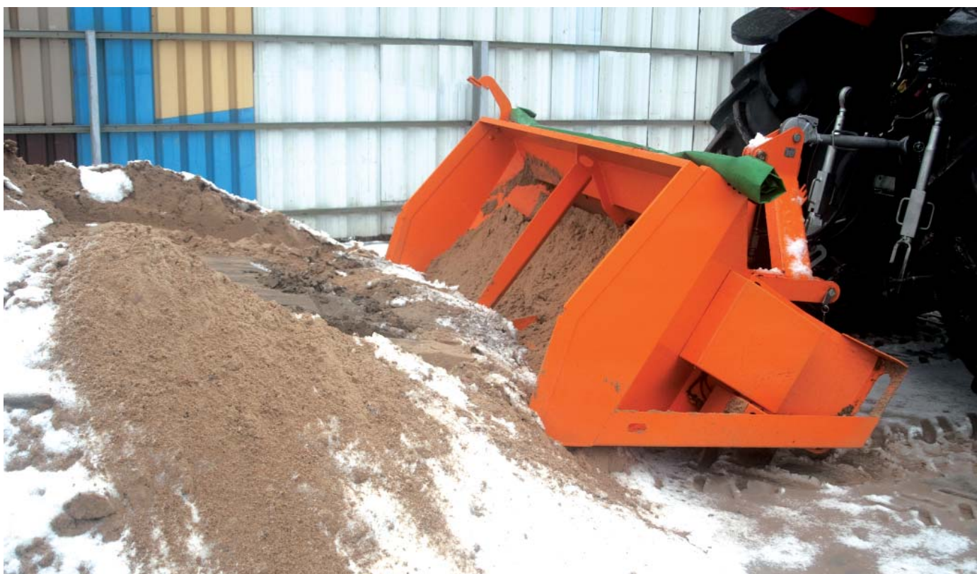
Operator bez wysiadania z kabiny ciągnika jest w stanie w ciągu kilku sekund napełnić materiałem z przemy łyżkę o pojemności 1000 litrów
