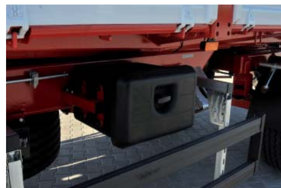
Wyposażenie opcjonalne - skrzynka narzędziowa i boczne urządzenie (osłony) zabezpieczające
