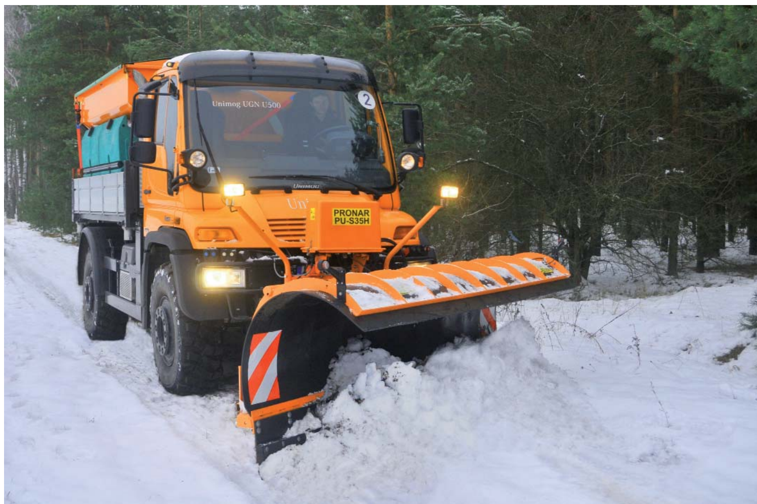
Plug samochodowy PRONAR PU-S35H zagregowany z Unimogiem
