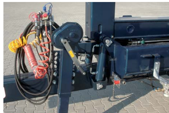
Hydraulicznie amortyzowany dyszel
