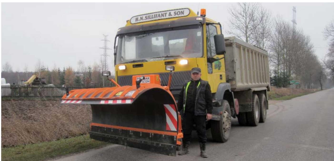
Szerokość robocza 3,2 m pozwala odśnieżyć drogi asfaltowe i inne drogi gminne - mówi Bogdan Wojnowski
