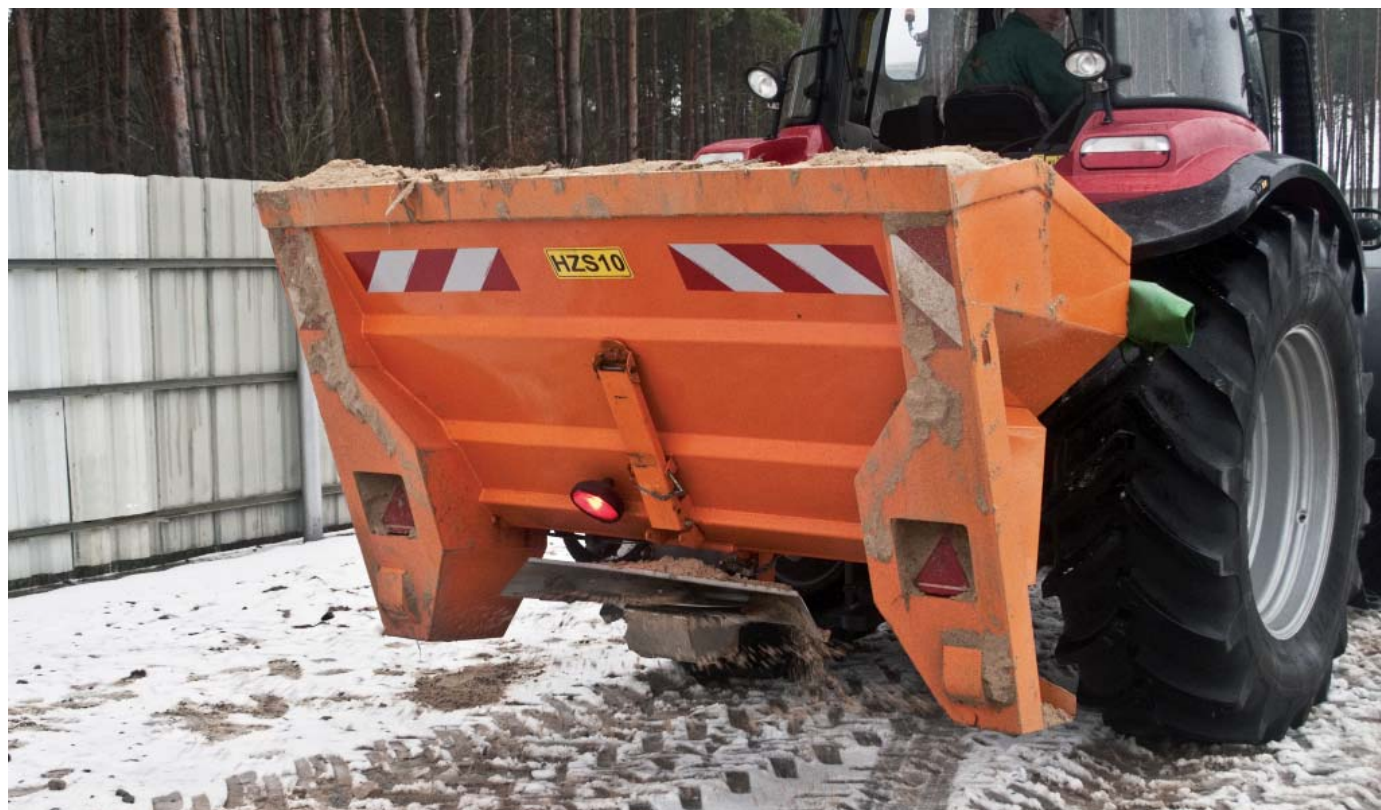
Elementy łyżki, narażone na zniszczenie podczas załadunku, zostały wykonane ze stali trudnościeralnej
