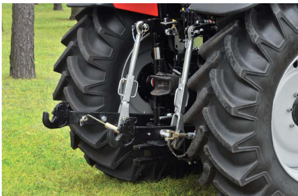
Tylny TUZ jest wyposażony w dwa zewnętrzne cylindry o maksymalnym udźwigu 4900 kg
