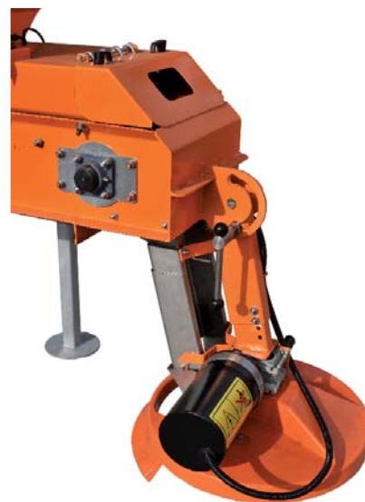
Tarcza rozsypująca napędzana silnikiem elektrycznym
