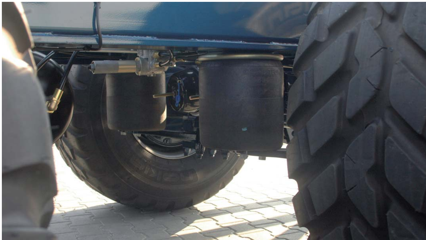
Zawieszenie pneumatyczne - opcjonalne wyposażenie przyczepy PRONAR T286
