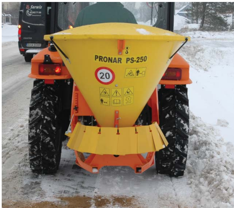
Posypywarka PS-250 o pojemności 2,5 dm 3
