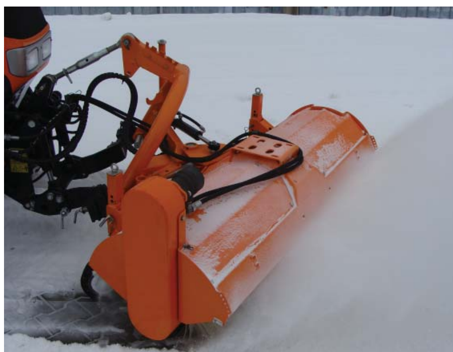
Specjalna szczotka grzebieniowa pozwala na usunięcie śniegu
