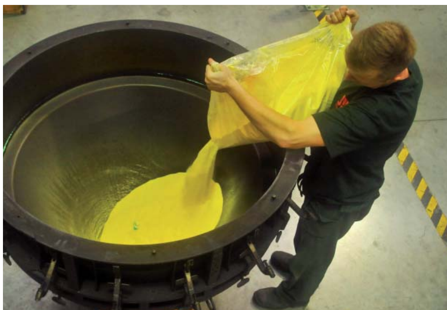
Kosz zasypowy oraz pokrywa są wykonane z polietylenu metodą formowania rotacyjnego
