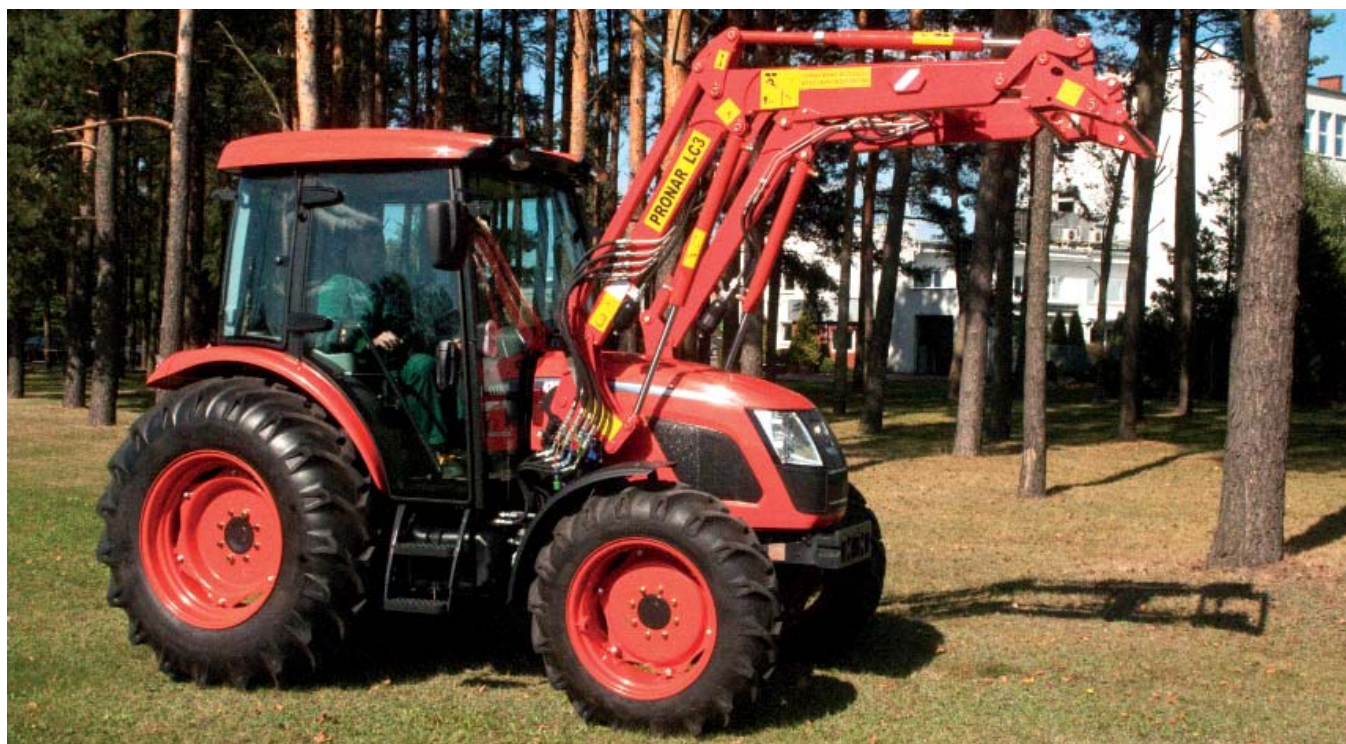
W celu zabezpieczenia elementów ciągnika i ładowacza w Kioti RX7320 zamontowano dwustronną amortyzację hydrauliczną
