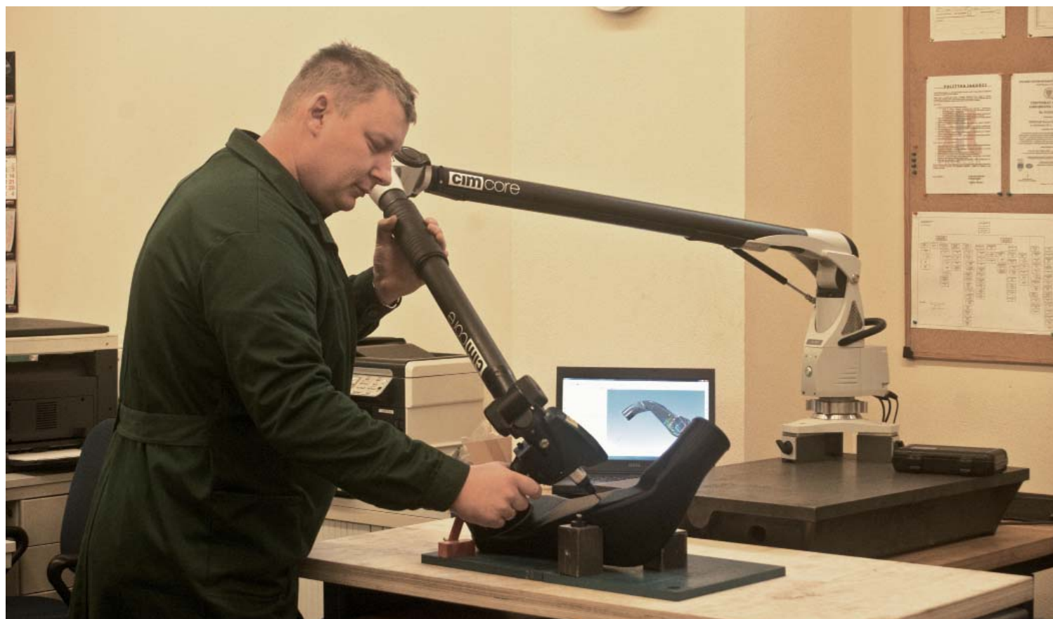
Większe podzespoły sprawdzane są regularnie przy wykorzystaniu ramienia pomiarowego o trzech stopniach swobody
