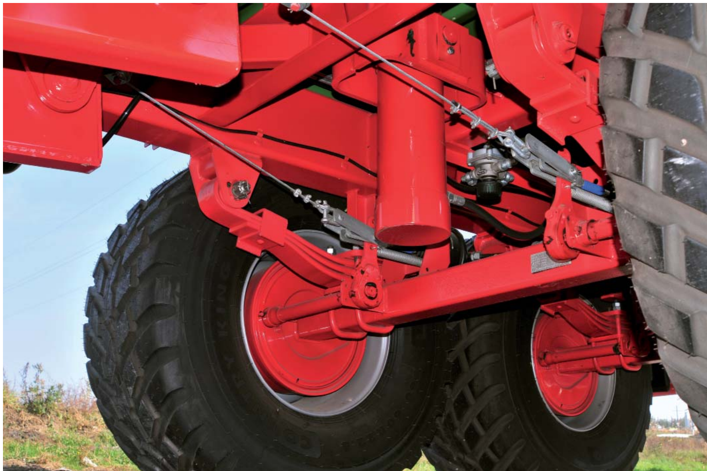
Przyczepa PRONAR T669/1 jest osadzona na podwoziu tandem o resorach parabolicznych
