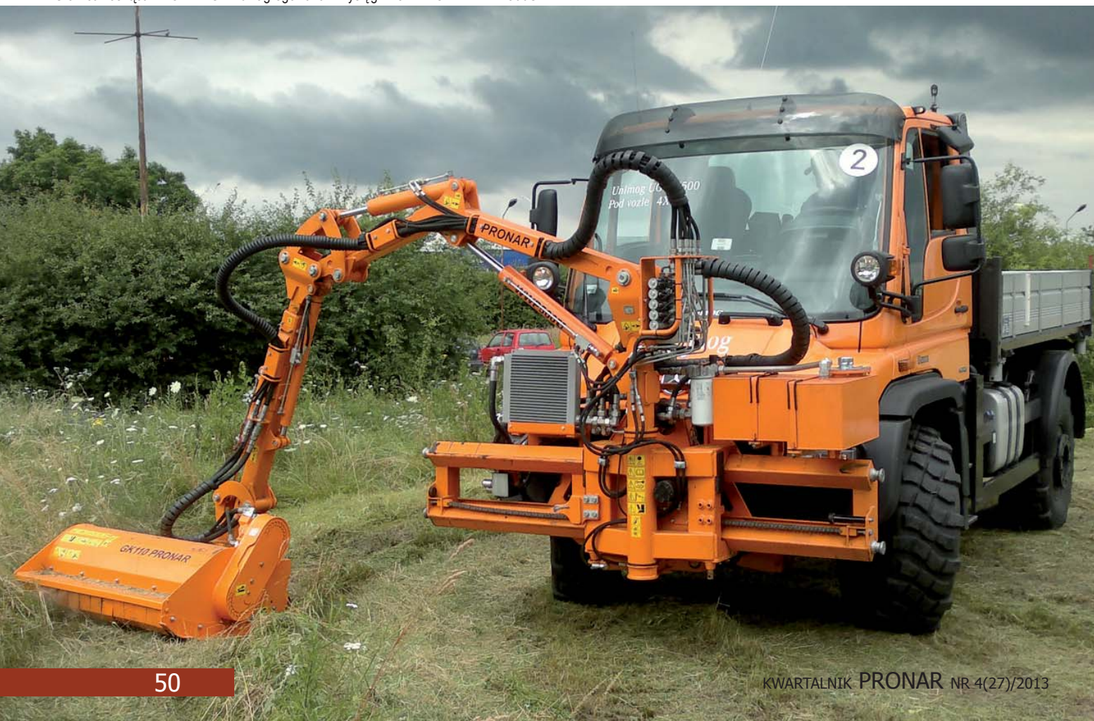
Głowica kosząca PRONAR GK110 zagregowana z wysięgnikiem PRONAR WWP500U
