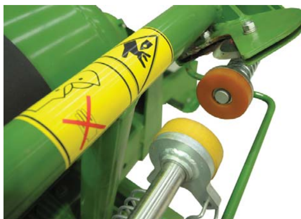
Mechanizm odcinająco-przytrzymujący folię
