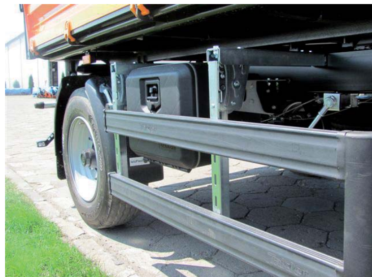
Skrzynka narzędziowa (wyposażenie dodatkowe) zabezpieczona jest barierami przeciwnajzdowymi
