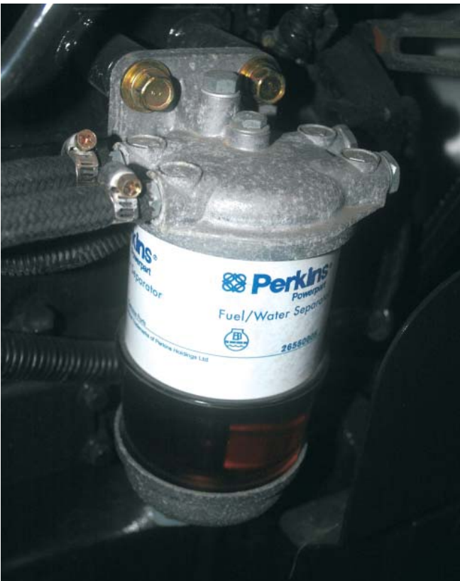
Filtr paliwa należy wymieniać co roku, właśnie przed zimą
