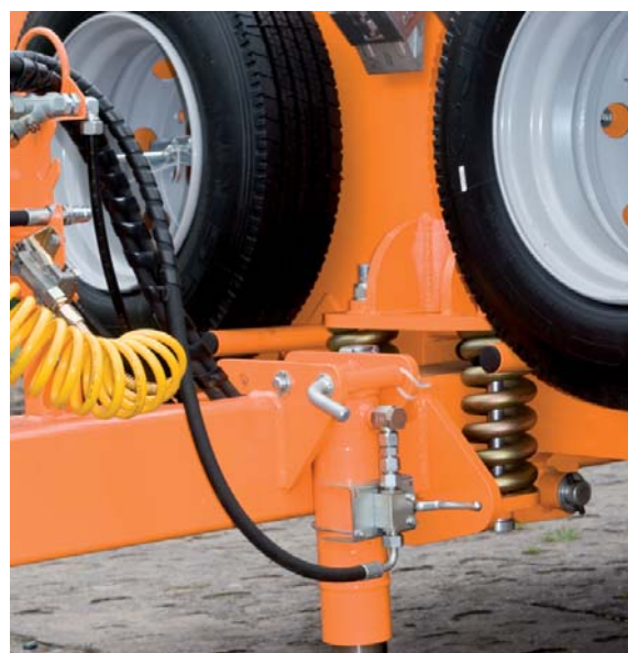
Hydrauliczna podpora dyszla przyczepy PRONAR RC2100
