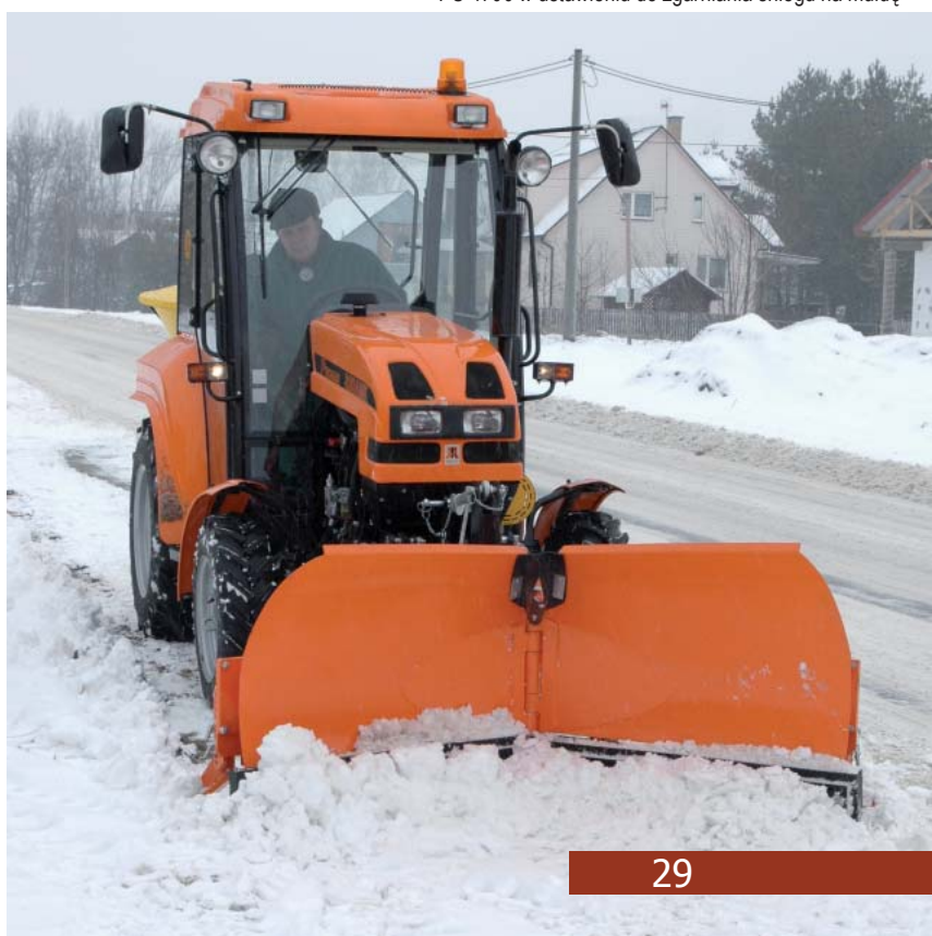
PU-1700 w ustawieniu do zgarniania śniegu na muldę
