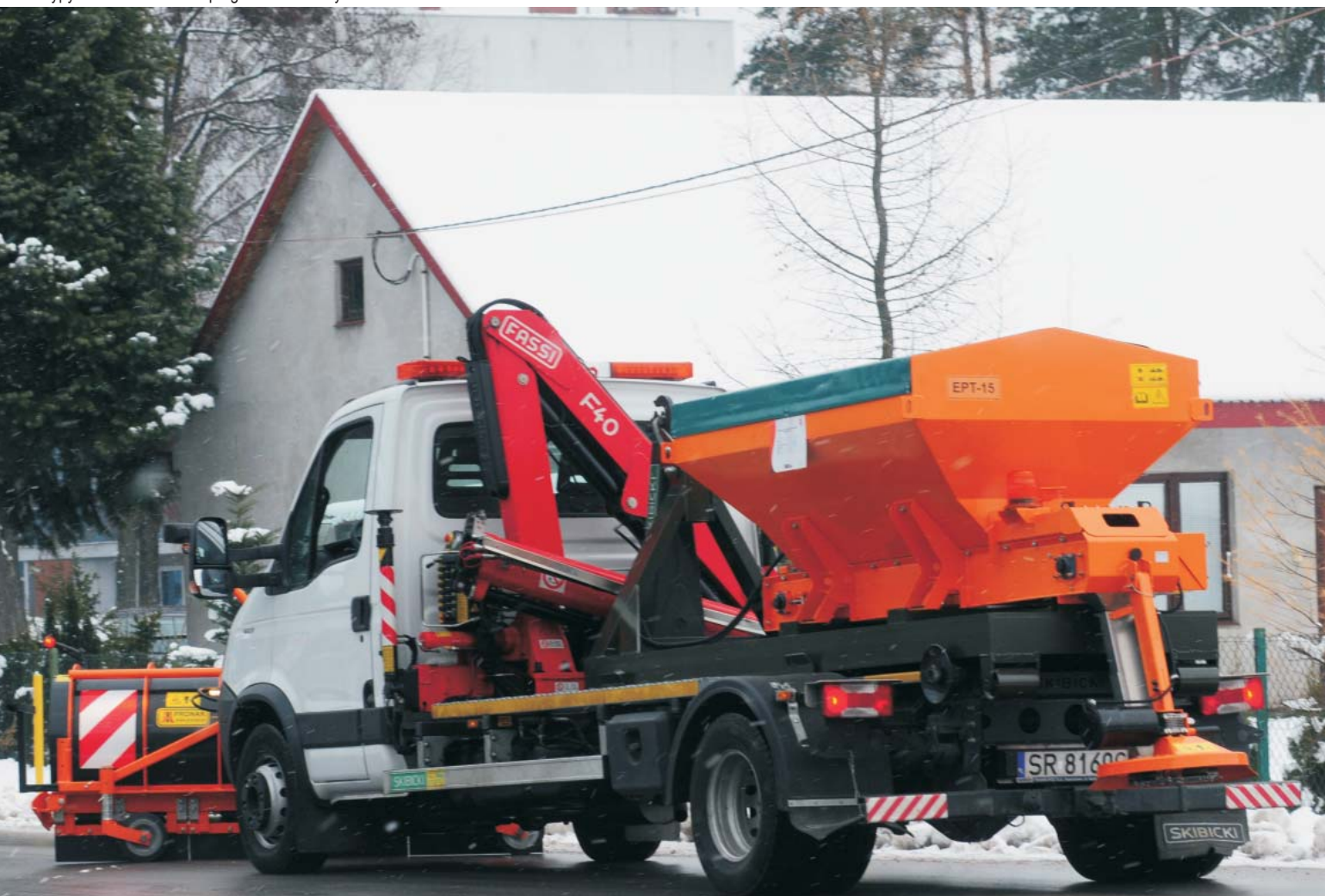
Posypywarka EPT-15 oraz pług samochodowy PU-S25H
