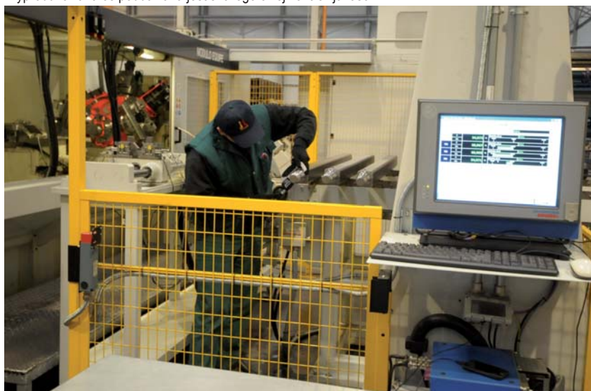
Wyprodukowana oś poddawana jest szczegółowej kontroli jakości
