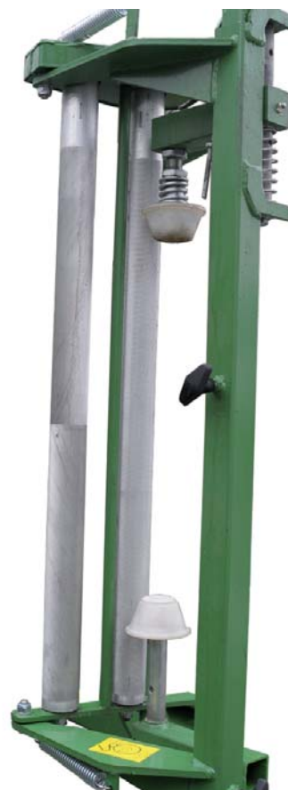
Uniwersalny podajnik przystosowany do odwijania folii o szerokości 500 i 750 mm
