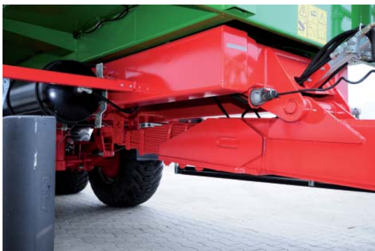
Amortyzowany dyszel nie przenosi drgań na ciągnik
