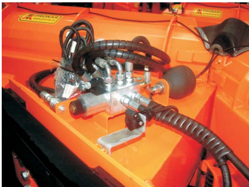
Trzeba sprawdzić stan techniczny przewodów hydraulicznych
