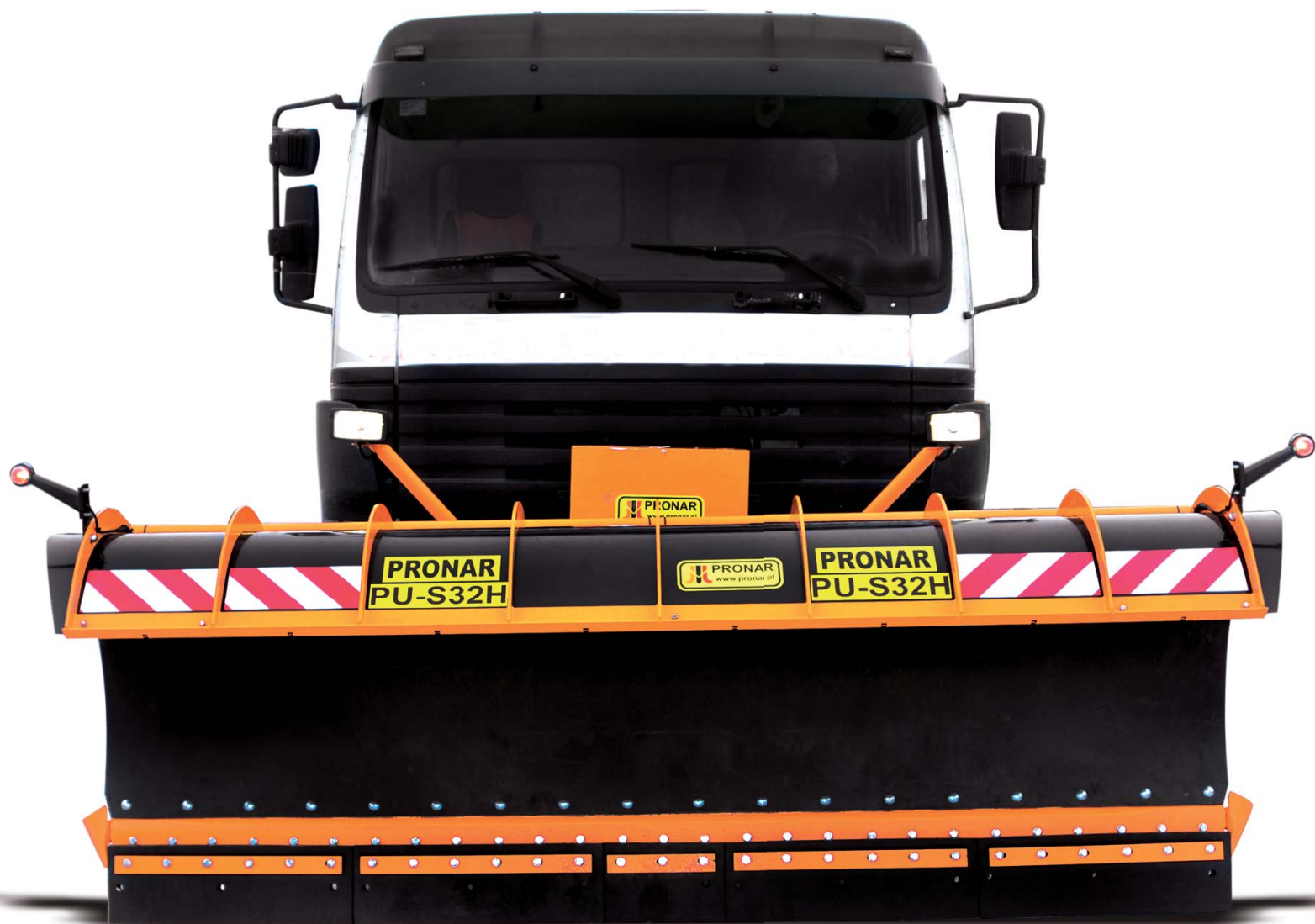
Plug PU-S32H przeznaczony do pracy z samochodami ciężarowymi
