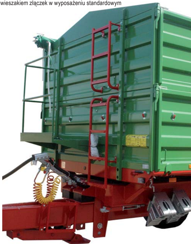
Przyczepa T683 - sztywny dyszel amortyzowany podkładami gumowymi z hydraulicznie sterowaną nożycową podporą, z uchwytem przewodów hydraulicznych i wieszakiem złączek w wyposażeniu standardowym
