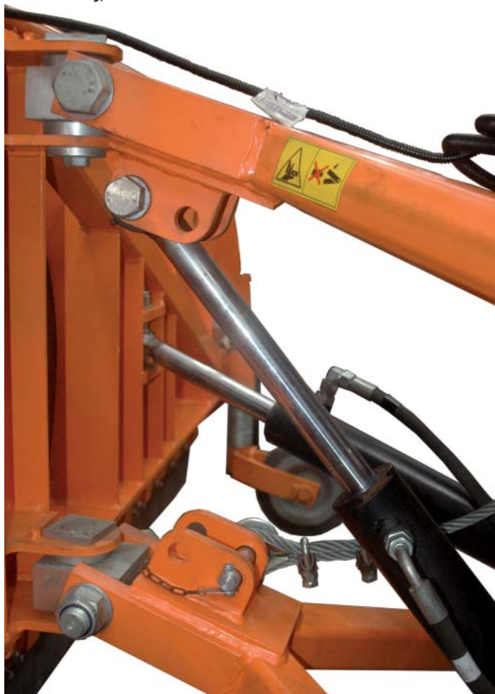
Należy skontrolować szczelności siłowników i połączeń hydraulicznych
