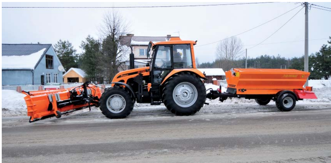
Plug odśnieżny PU-3300 zagregowanych na ciągniku 82TSA z posypywarką T131
