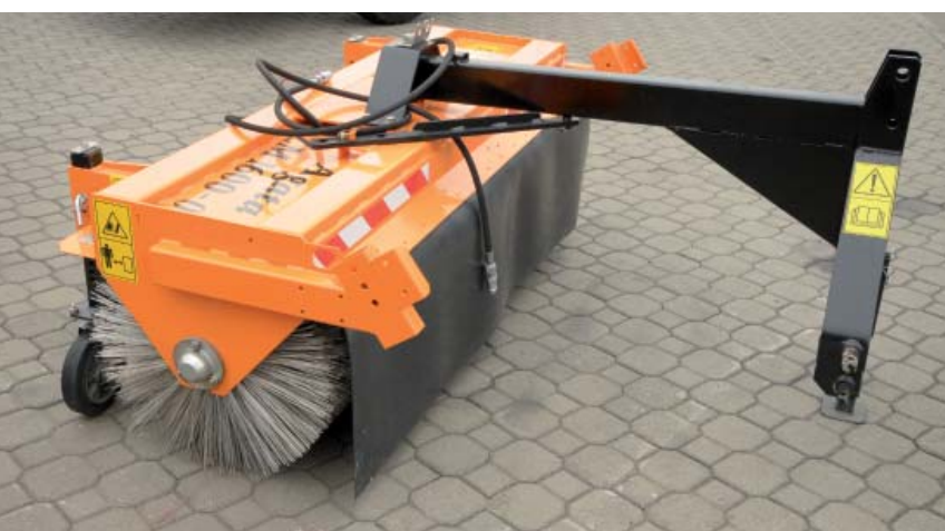
Zamiatarka Agata ZM1600 w wersji do odgarniania zanieczyszczeń lub śniegu - szczotka o średniej twardości (stal + PP). Konstrukcja jest przystosowana do montażu elementów dodatkowych np. bocznej szczotki lub rynny zbierającej
