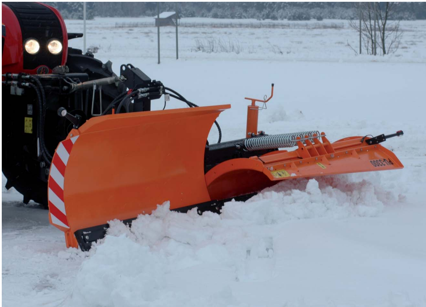
Konstrukcja pługów PU-3300 i PU-2600 zabezpiecza odkładnicę przed zniszczeniem przy najechaniu na przeszkodę
