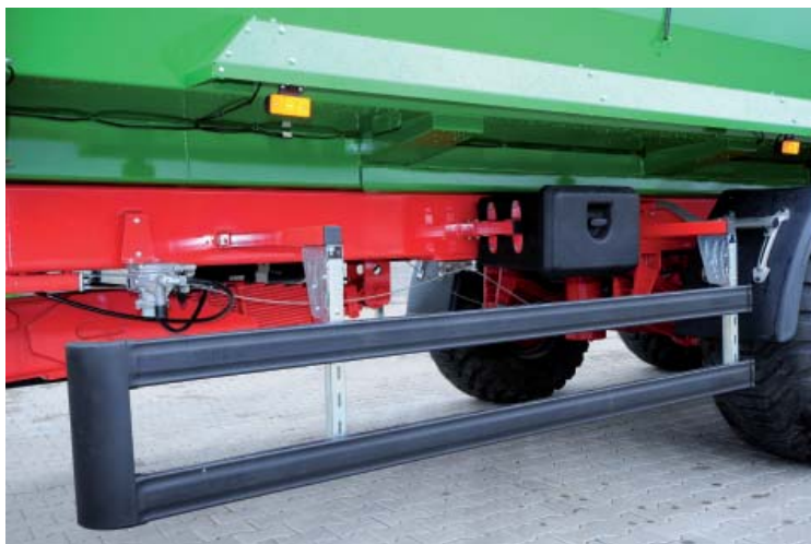
Skrzynka narzędziowa i boczne osłony przeciwnajazdowe są dodatkowym wyposażeniem przyczepy PRONAR T700M
