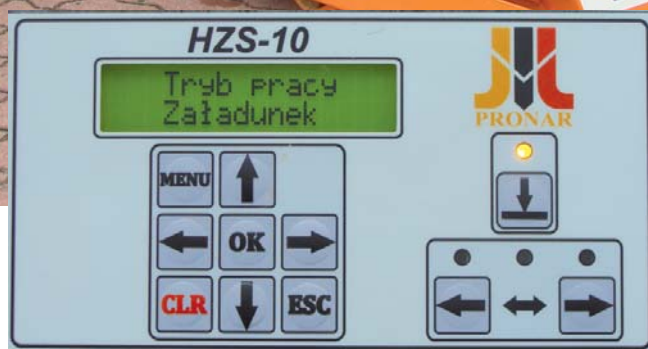
Panel sterowania posypywarki PRONAR HZS10 - tryb pracy: załadunek
