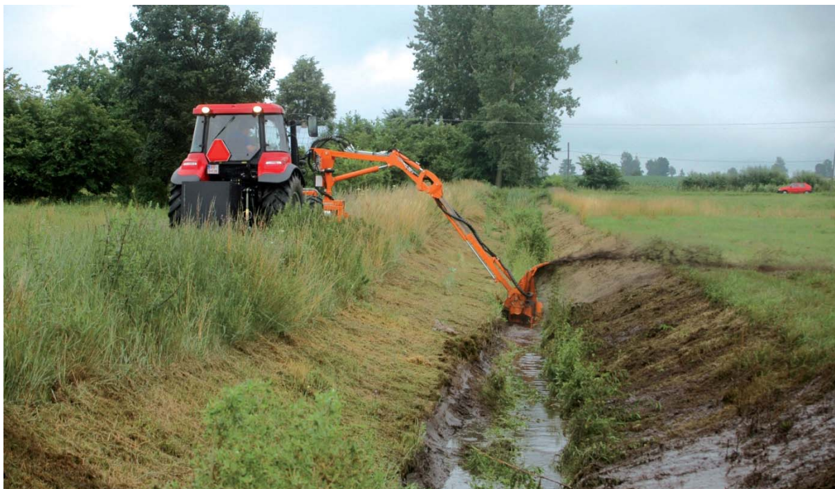
Dbłość o dobry stan rowów melioracyjnych zapewnia odmularka PRONAR GO800 podłączona do wysięgnika
