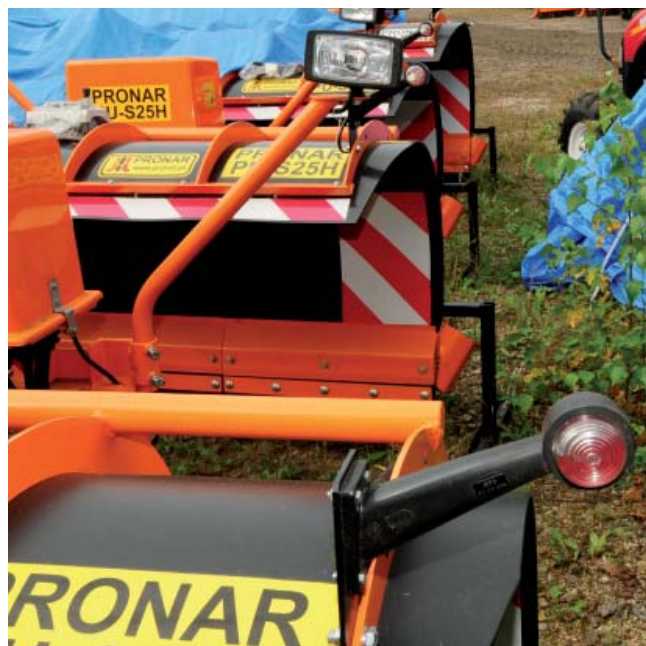
Pług do odśnieżania PU-S25H - światła obrysowe lemiesza
