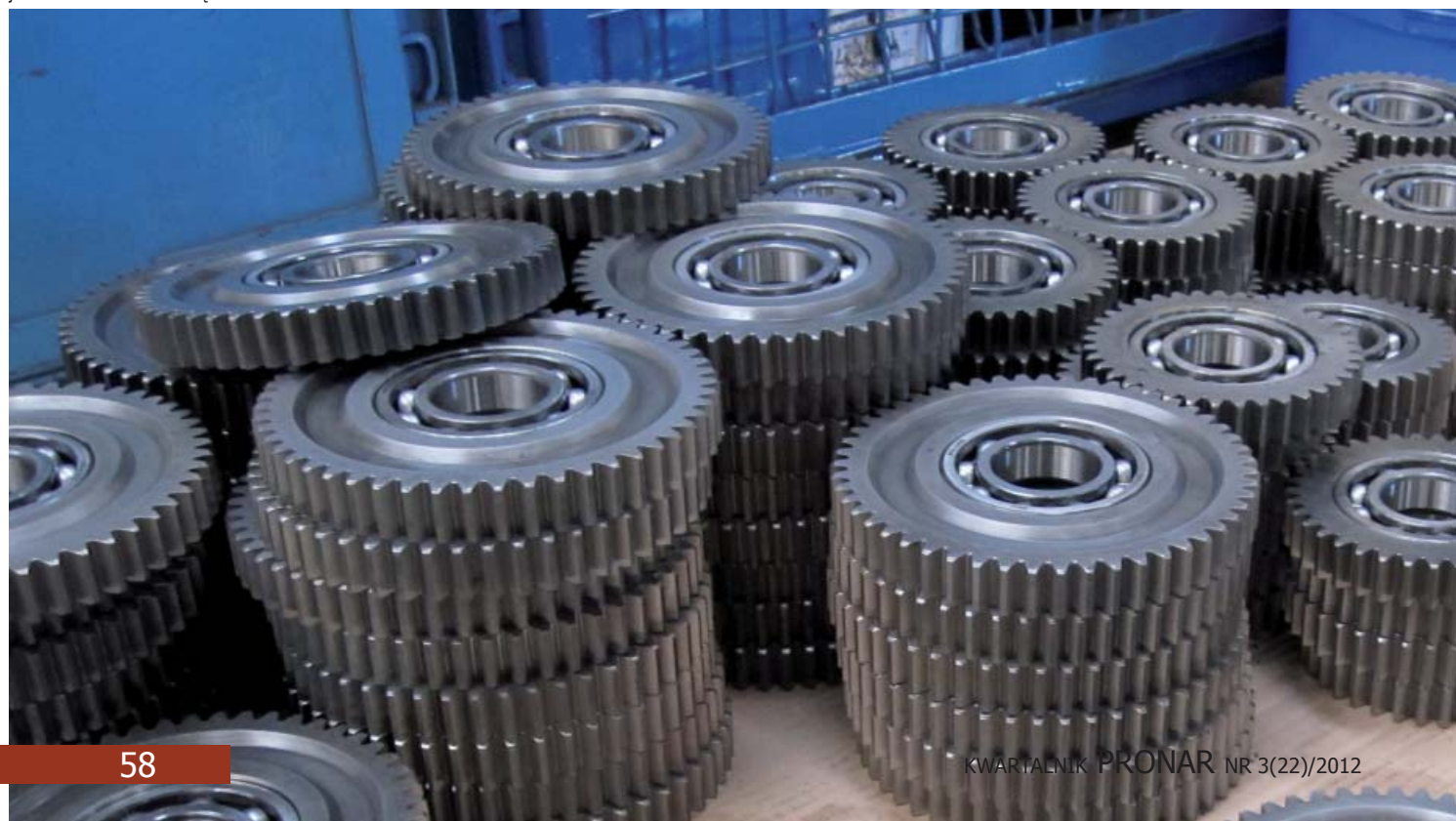
Napęd wewnętrzny listwy rozprowadzają wysokiej jakości szlifowane koła zębate
