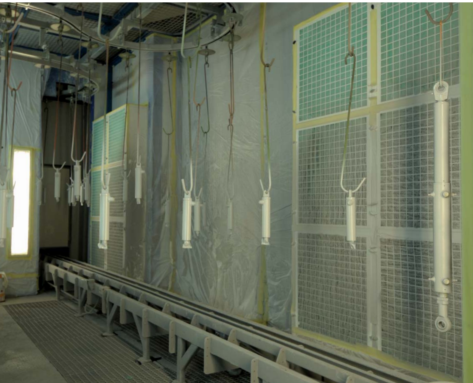
Kabina lakiernicza do aplikacji podkładu gruntującego
