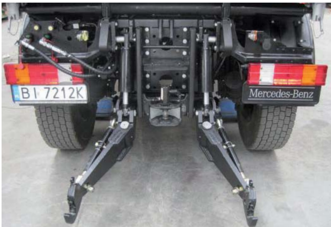
Tylny TUZ wraz z automatycznym zaczepem transportowym zamontowany na nośniku (Unimog U400)
