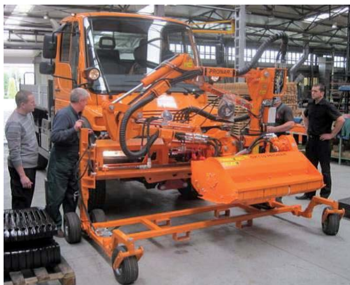
Montaż wysięgnika WWP500U z głowicą koszącą GK 110
