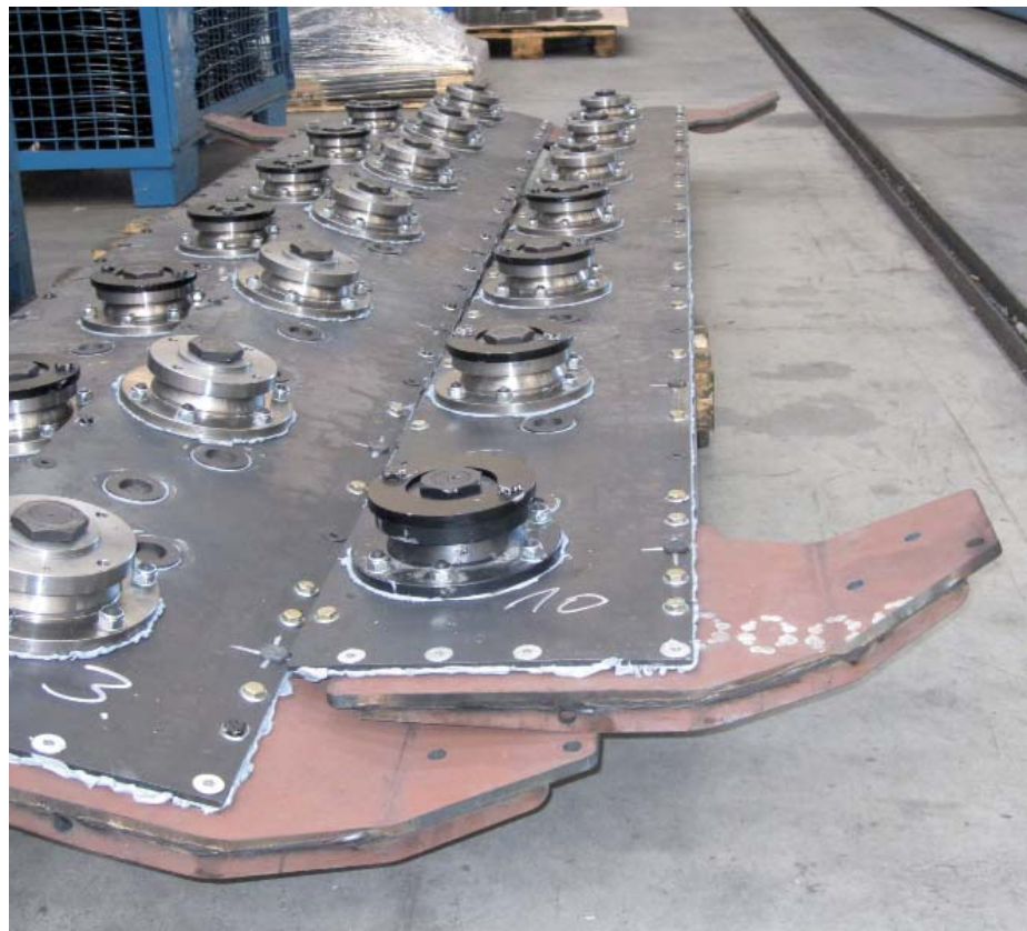
Listwy tnące przed malowaniem i montażem końcowym
