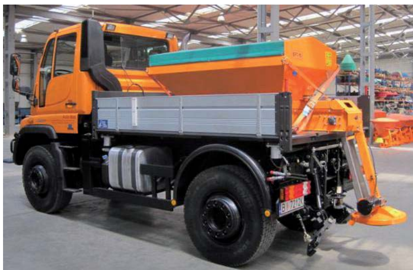
Unimog z zamontowaną posypywarką PRONAR EPT15
