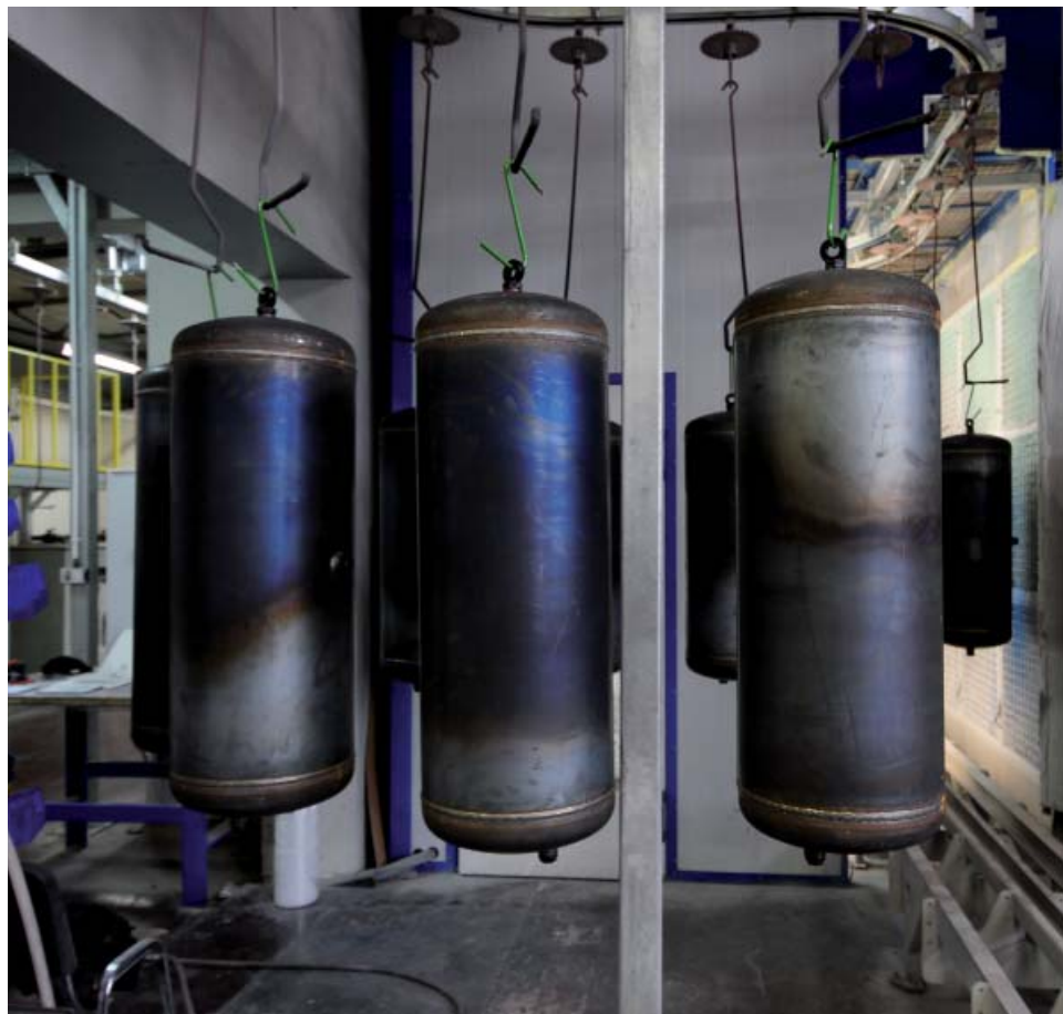
Detale przed ostateczną kontrolą stanu przygotowania powierzchni i wejściem do kabiny lakierniczej
