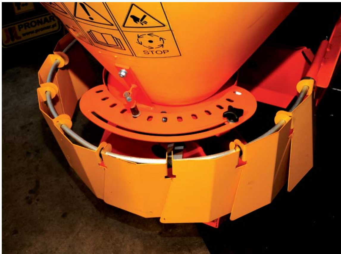
Posypywarka piasku PS-250 - układ dozujący i rozsypujący
