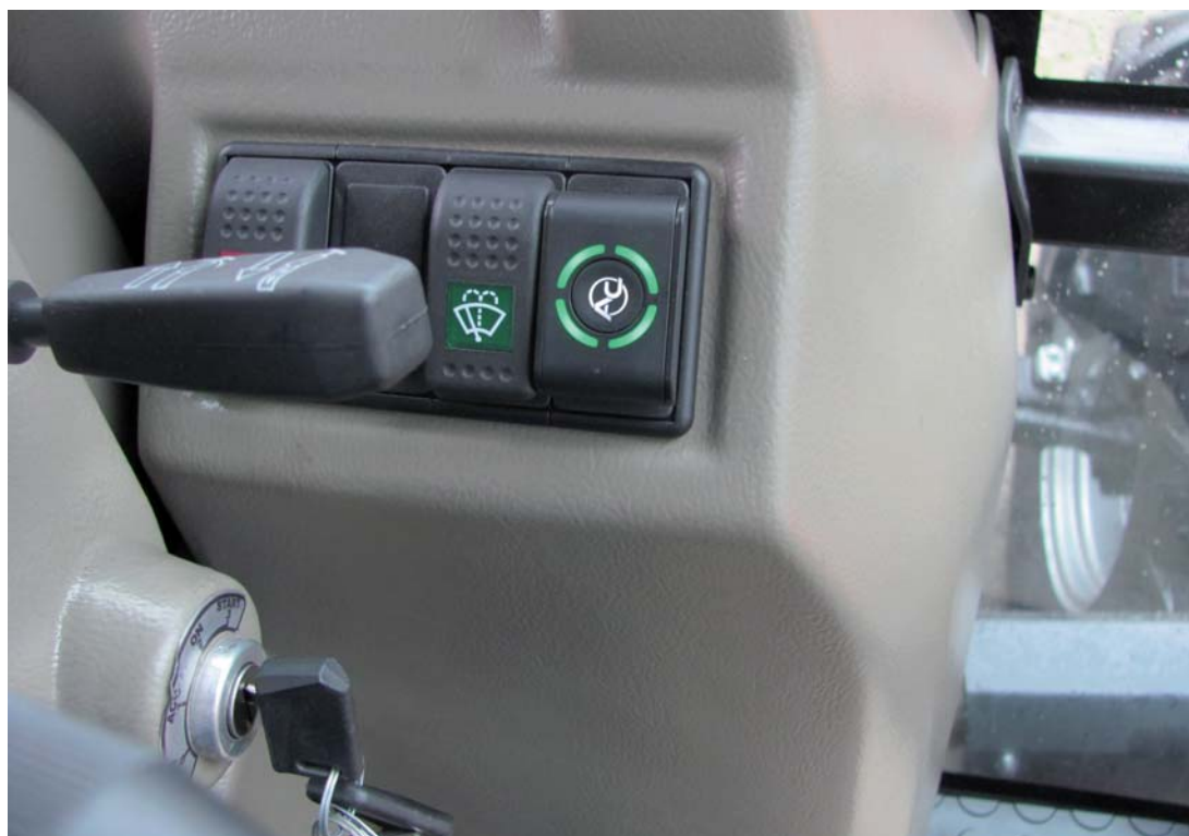
Przełącznik gazu w kabinie
