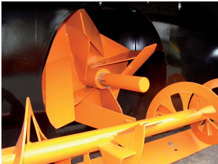
Lemiesz z trudnościeralnej stali, ślimak rozdrabniający a także zgarniający śnieg i lód na wirnik oraz wirnik wyrzucający śnieg do komina. Elementy wirnika również wykonane są ze stali trudnościeralnej. Pod cylindryczną osłoną znajduje końcówka wałka do agregowania z tyłu ciągnika przy jeździe do przodu
