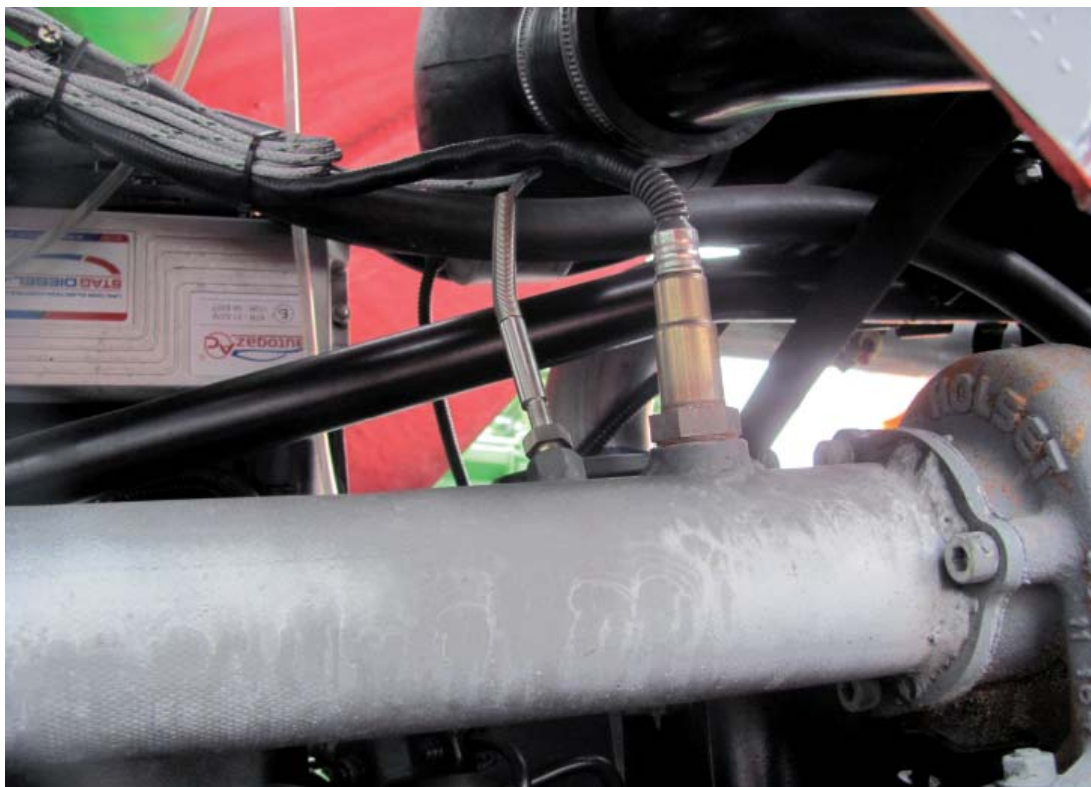
Czujnik temperatury spalin i sonda lambda na kolektorze wydechowym. W tle: sterownik gazu
