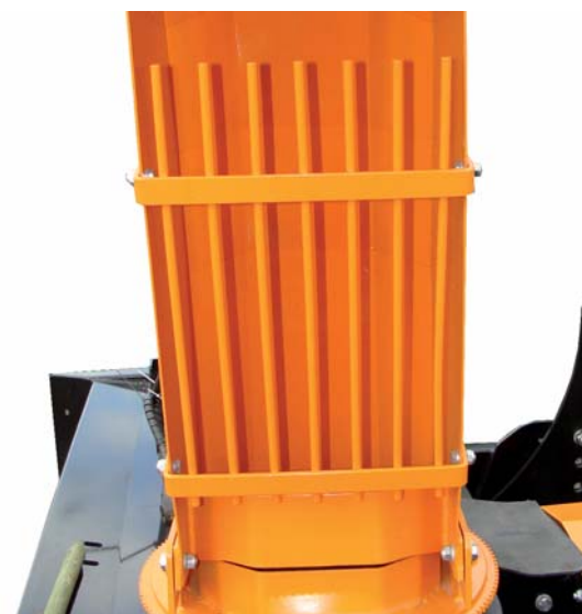
Oslona zabezpieczająca przed wyrzuceniem brył lodu lub kamieni
