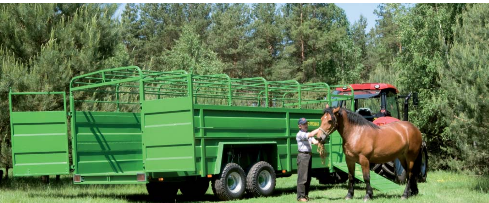
Przyczepa PRONAR T046/2 z osią podwójną typu tandem o długości wewnętrznej 7 m
