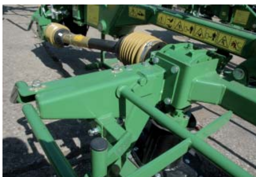
Wystarczy zdemontować część tylnej osłony, aby w jej miejsce założyć spulchniacz pokosu
