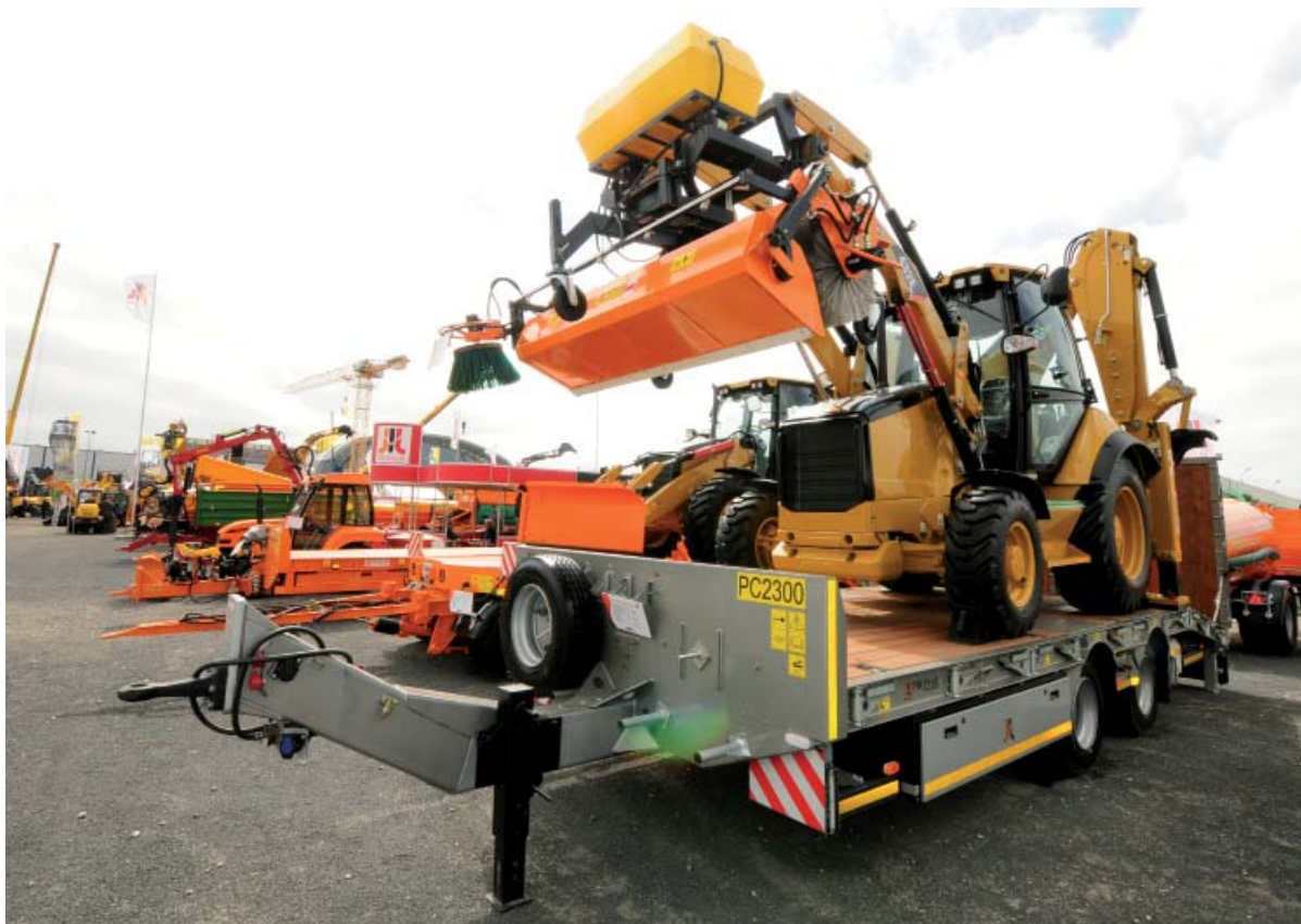
Zmiatarka Agata ZM-2000 zagregowana na koparko- ładowarce Caterpillar CAT432E
