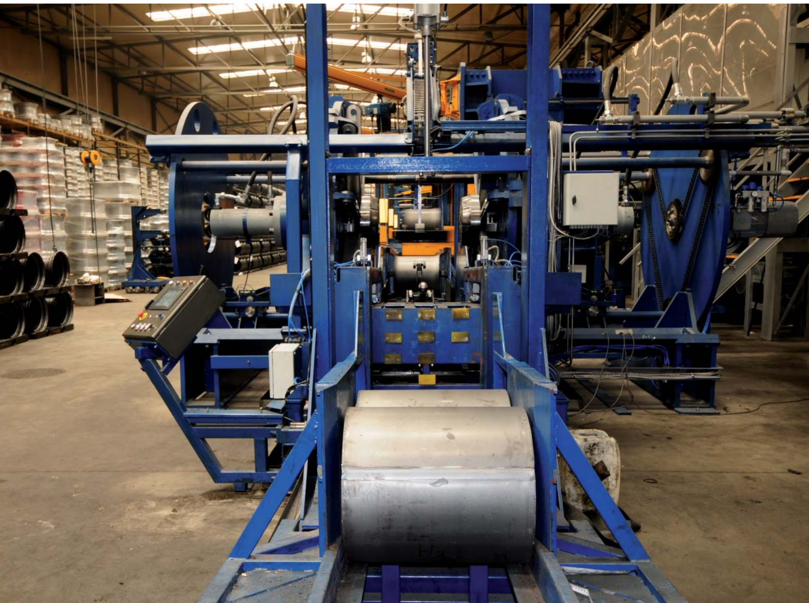
Rozpierak wstępny w trakcie produkcji obręczy
