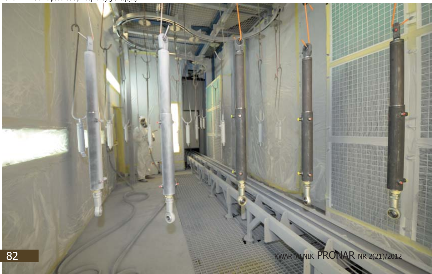
Lakiernik w kabinie podczas aplikacji farby gruntującej
