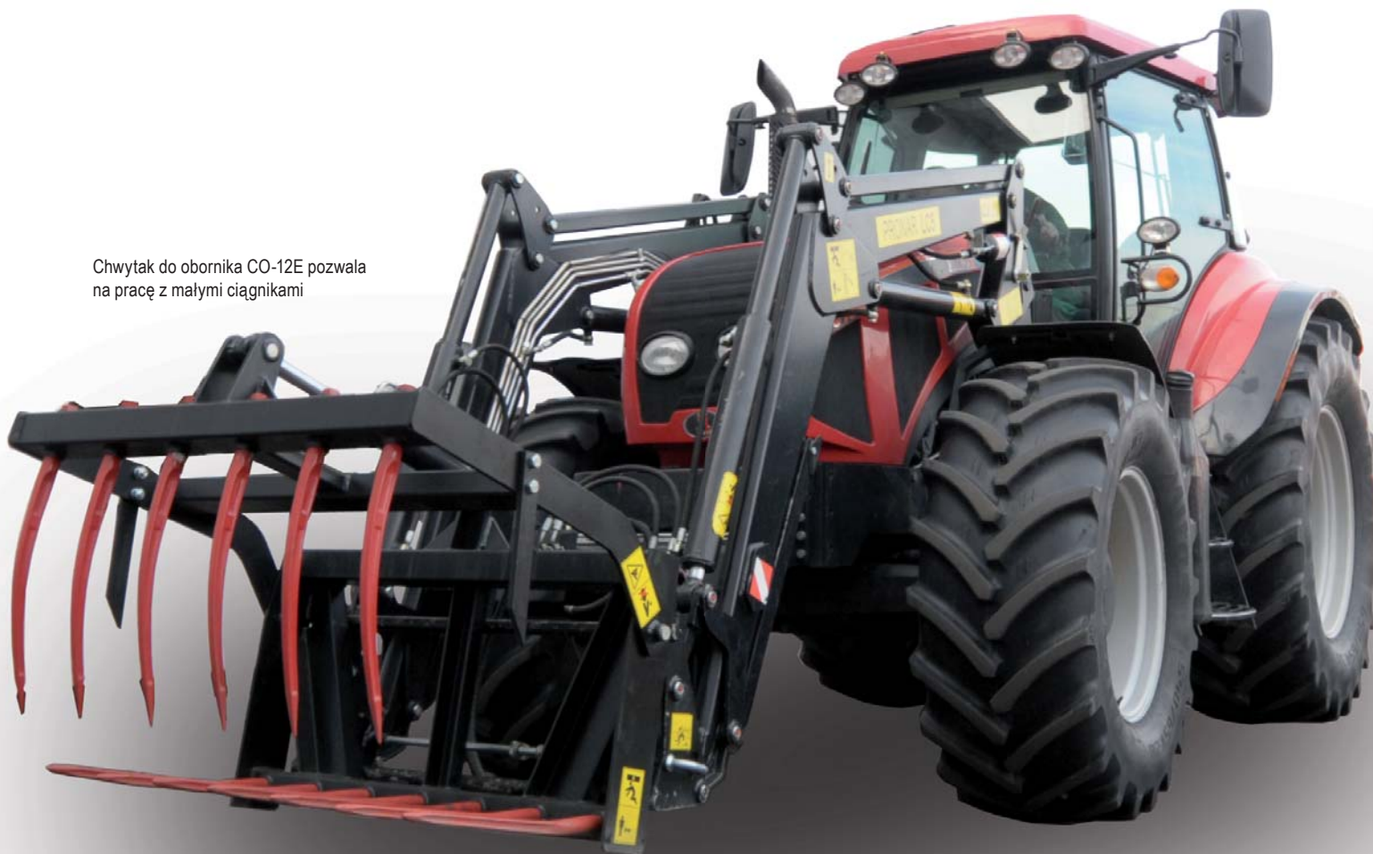
Dane techniczne chwytnaka do obornika CO-12E oraz wideł do obornika WO-12E
