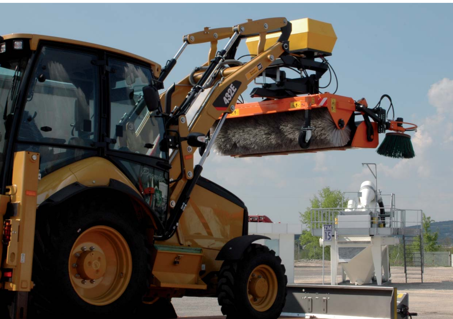
Zamiatarka ZM-2000 z układem zraszania i ze szczotką boczną zamontowaną na koparko-ladowarce CAT
