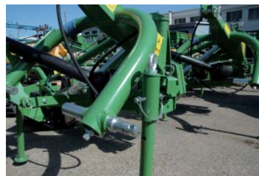
Funkcjonalna podpora kosiarki oraz regulowane sworznie zaczepu
