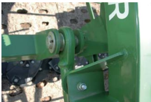
Połączenia ruchome realizowane przy pomocy łożysk przegubowych ślizgowych
