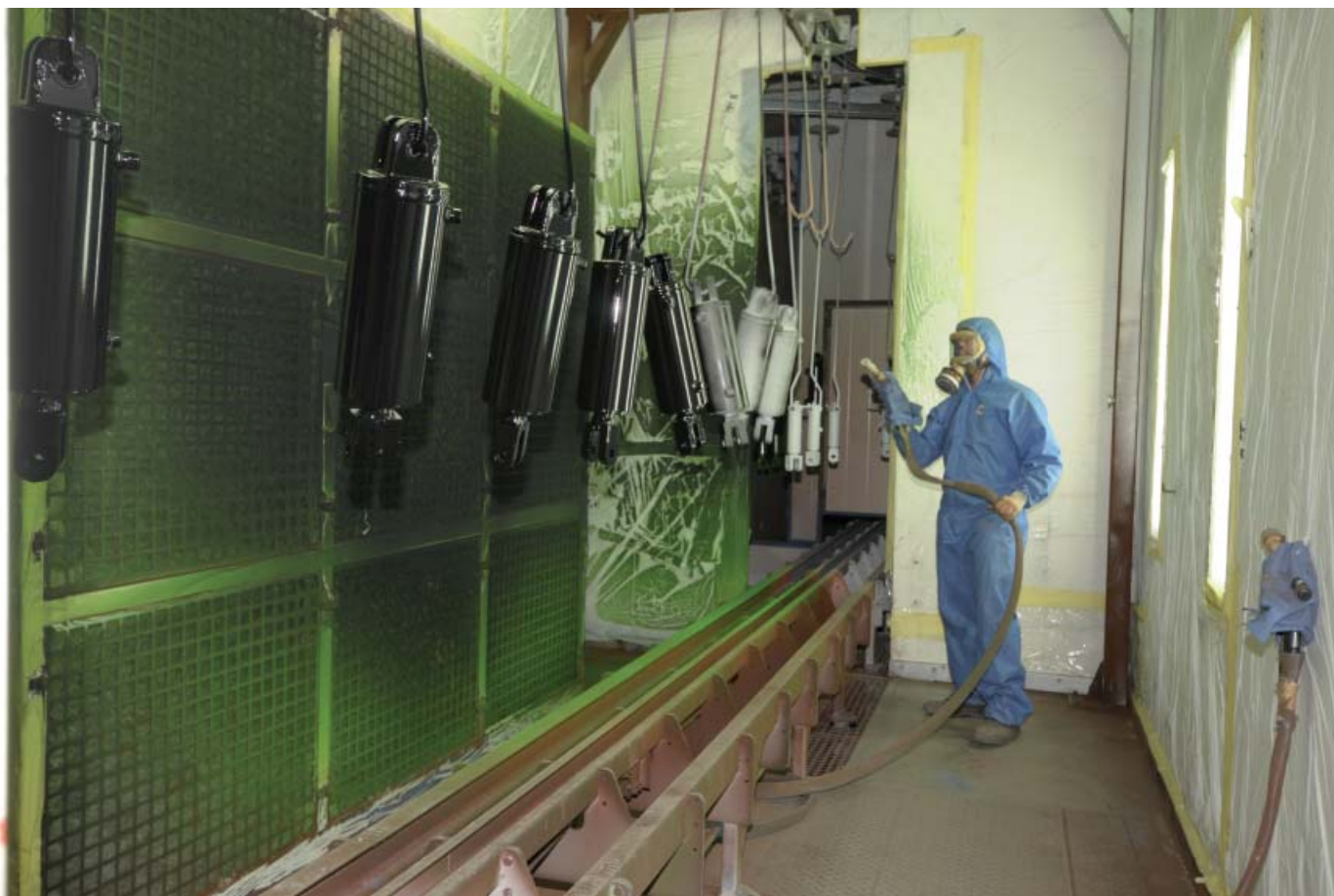
Lakiernik w kabinie podczas aplikacji farby nawierzchniowej- detale w czasie przesuwu obracają się wokół własnej osi
