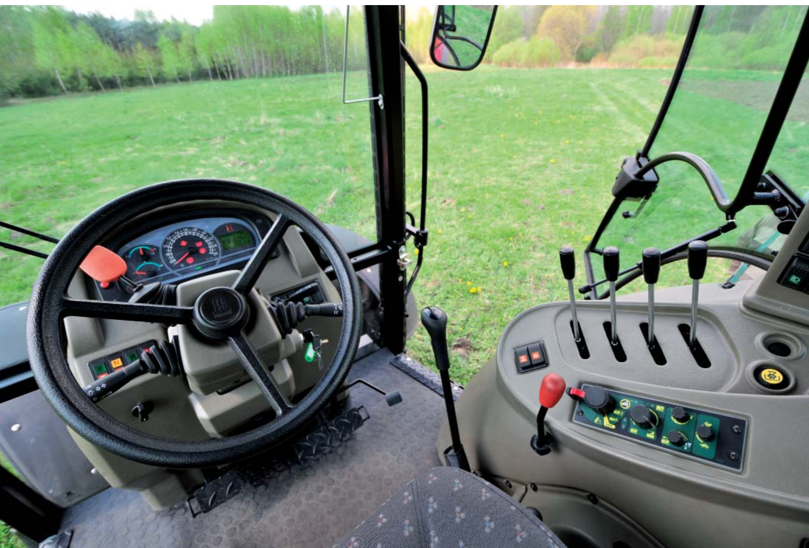
Zmiana kierunku jazdy realizowana jest za pomocą przełącznika pod kierownicą (pomarańczowa dźwignia z lewej strony). Umieszczenie tłumika w cieniu prawego słupka zwiększ widoczność
