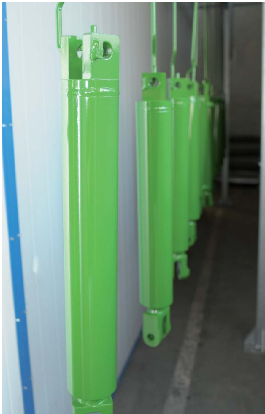
Polakierowane silowniki po wyjściu z suszarni
