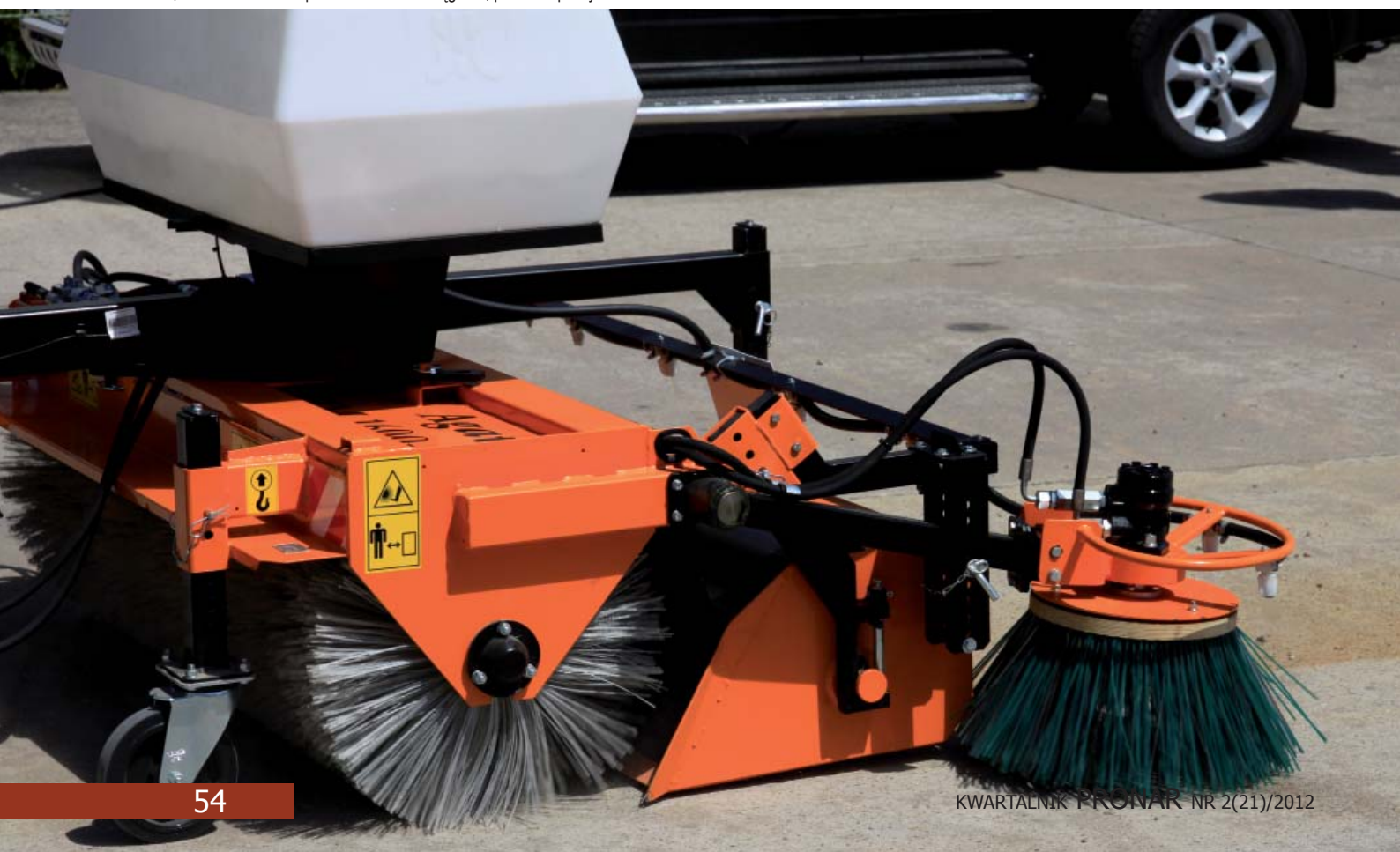
Zamiatarka ZM-1600, zamontowana na przednim TUZ-ie ciągnika, podczas pracy
