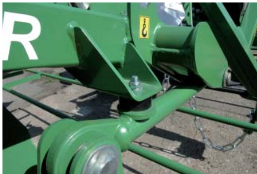
Amortyzatory metalowo-gumowe ograniczające ruch maszyny
