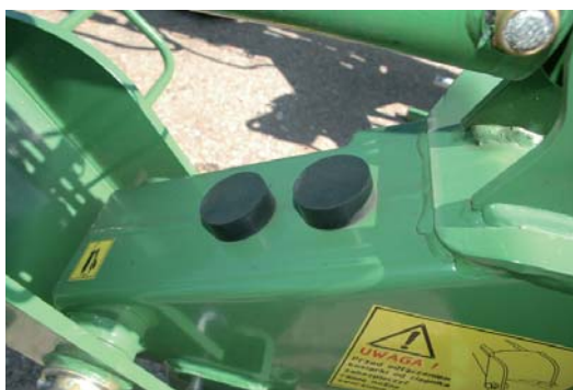
Amortyzatory metalowo-gumowe stanowią opór kosiarki podczas składania
