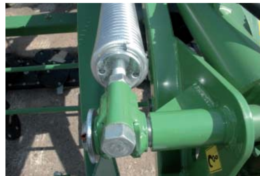
Regulacja naciągu ocynkowanych sprężyn odciążających
