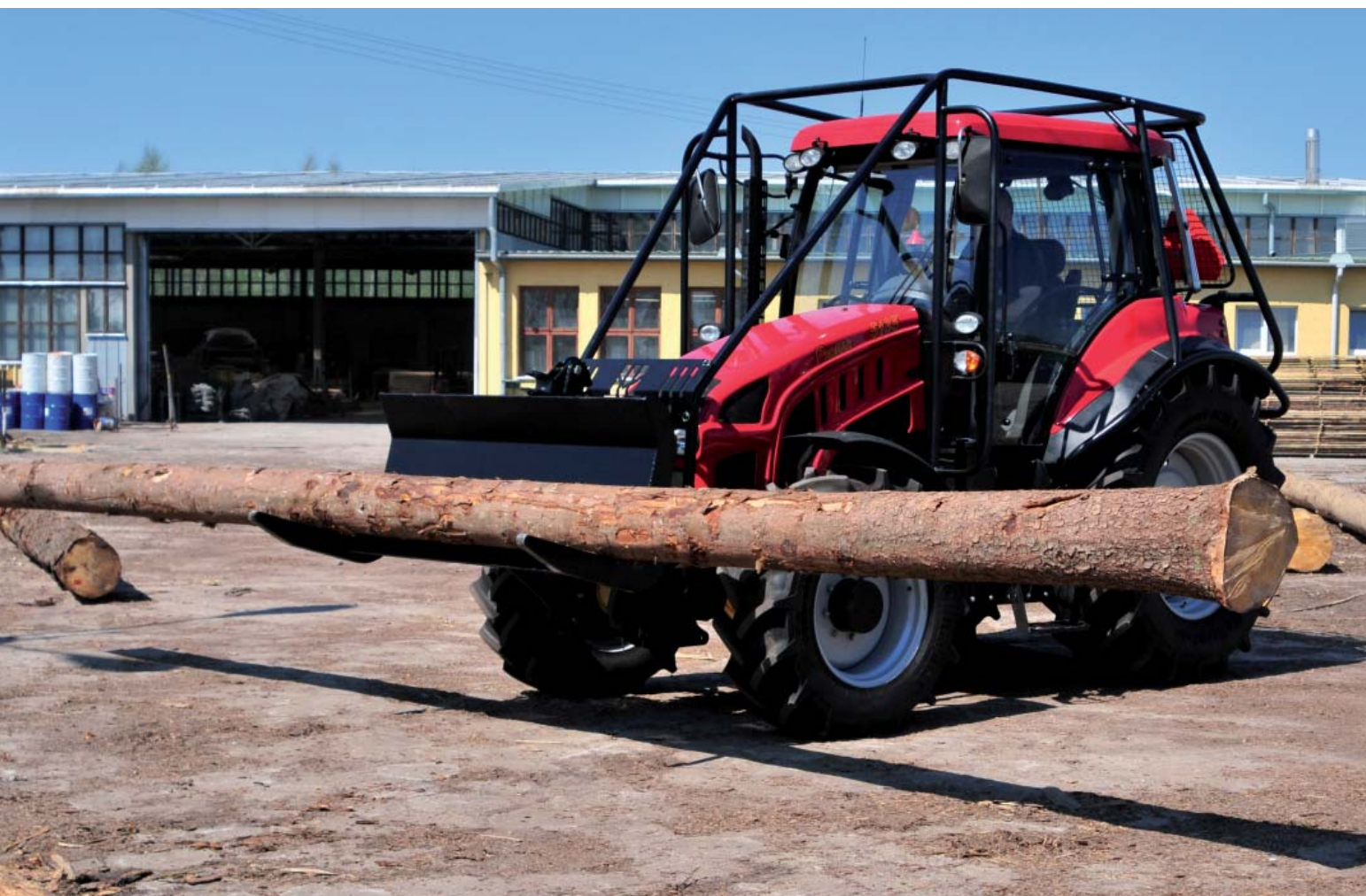
Ciągnik serii P5 z osprzętem LCL16 do układania drewna przed załadunkiem
