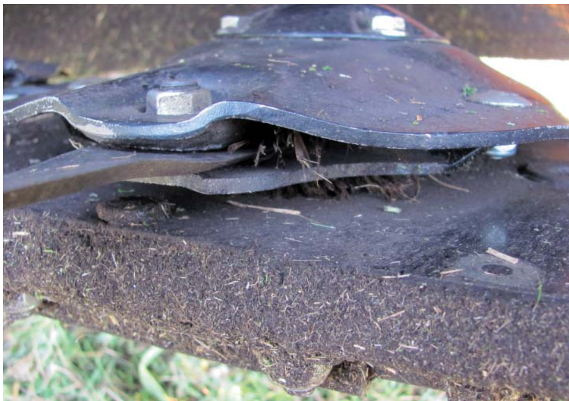
Zastosowana konstrukcja pozwala na szybką wymianę noży
