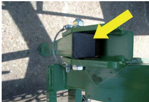
Na zdjęciach powyżej: plastikowe korki zamykające profile
