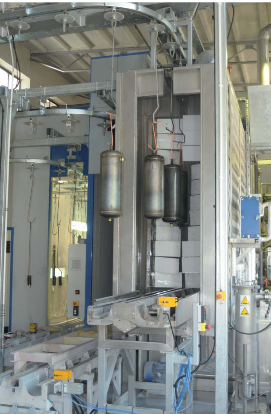
Zbiorniki ciśnieniowe pneumatycznych układów hamulcowych podczas rozpoczęcia procesu mycia w myjce przelotowej
