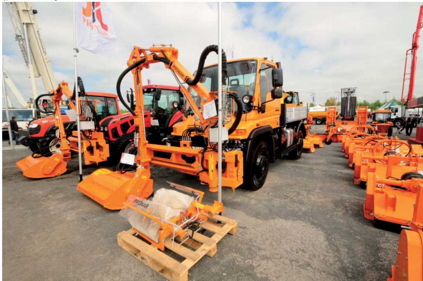
Wysięgnik wielofunkcyjny PRONAR WWP500 zagregowany na samochodzie typu Mercedes Unimog
