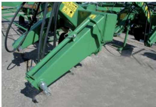
Klucz do wymiany noży zamontowany w poręcznym miejscu
