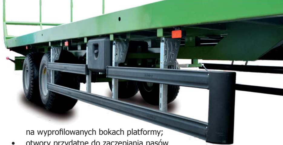
Boczne zabezpieczenie najazdowe i pojemna skrzynka narzędziowa
