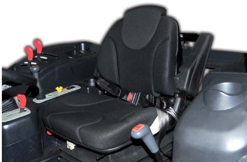
W pełni regulowany i amortyzowany fotel sprawia, że operator czuje się w ciągniku komfortowo bez względu na to, jaką pracę wykonuje. Fotel kierowcy wyposażony jest w zwijany pas bezpieczeństwa
