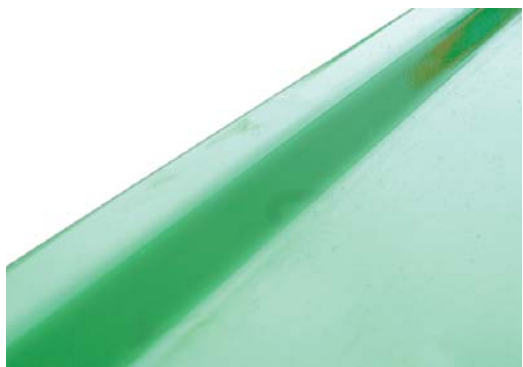
Wyprofilowane, zaokrąglone ranty boczne platformy zabezpieczają ładunek przed zsunięciem z przyczepy oraz eliminują ryzyko uszkodzenia folii bel podczas załadunku i transportu
