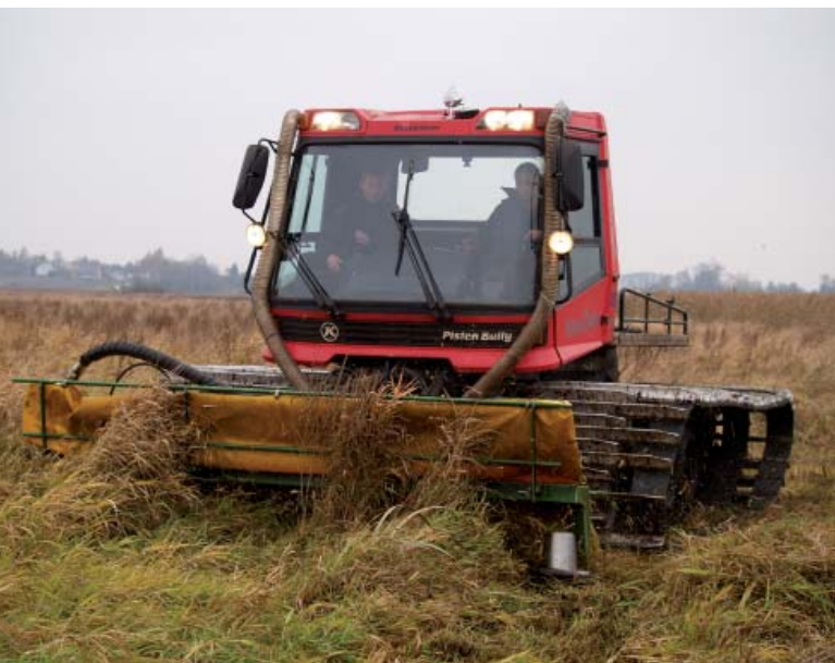
Kosiarka dyskowa Pronaru została przystosowana do pracy z ratakiem
