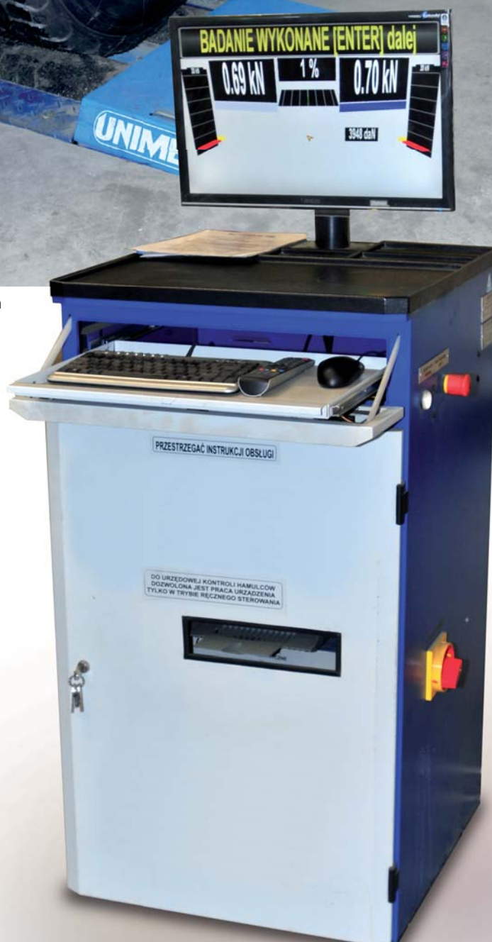
Rolkowe stanowisko diagnostyczne do pomiarów siły hamowania w warunkach dynamicznych (TRIDEM T682). Na zdjęciu obok: wyświetlone wyniki oporów toczenia obydwu kół badanej osi przyczepy
