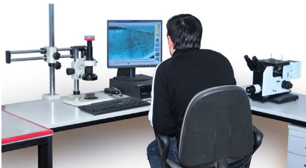
Stanowisko do badań makro- i mikroskopowych z zestawem do analizy obrazu
