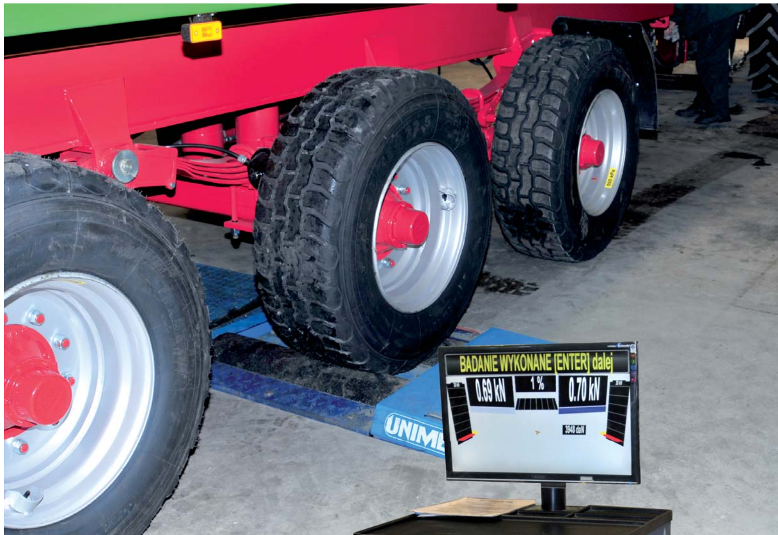
Rolkowe stanowisko diagnostyczne do pomiarów siły hamowania w warunkach dynamicznych (TRIDEM T682). Na zdjęciu obok: wyświetlone wyniki oporów toczenia obydwu kół badanej osi przyczepy
