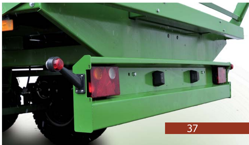
Tylne zabezpieczenie najazdowe zintegrowane z tylnym oświetleniem
