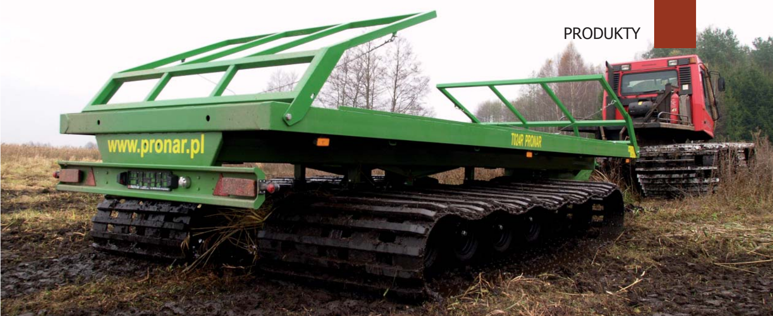
Ważąca 5 ton platforma T024R wjeżdża na bagna i - nawet obciążona - nie tonie
