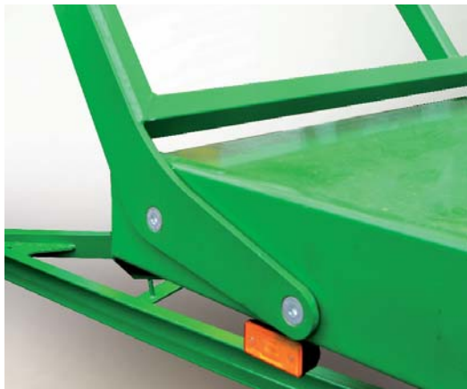
Dwupunktowy system mocowania drabinek, dający przy odpowiednim zamocowaniu ładunku możliwość rezygnacji z cięgien podtrzymujących
