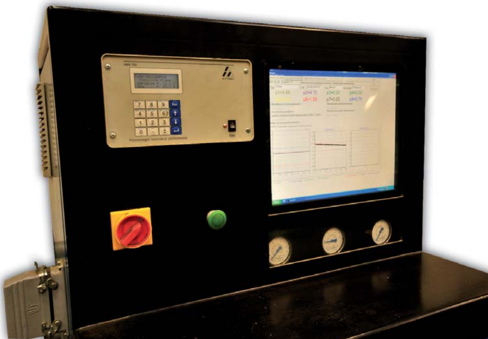
Pulpit Symulatora. Widoczne wykresy pomiarów oraz manometry wskazujące ciśnienie w poszczególnych punktach układu pneumatycznego przyczepy
