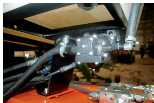
Pompa wody z regulacją wydatku
