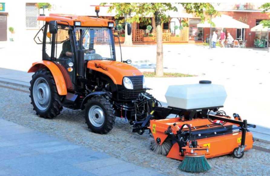
Zamiatarka ZM-1600 zawieszona na przednim TUZ-ie ciągnika komunalnego Zefir 40
