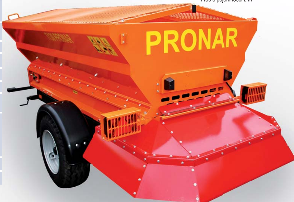
Ciągniona posypywarka piasku T130 o pojemności 2 m 3
