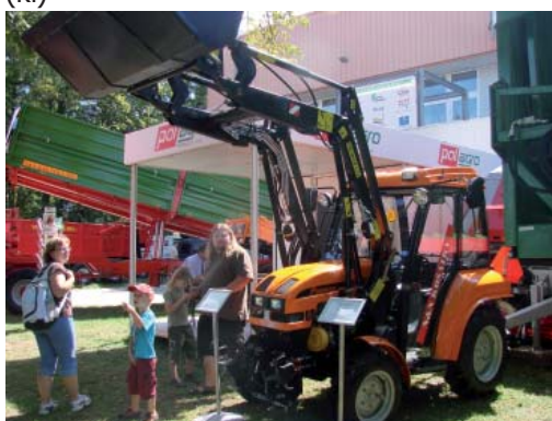
Ciągnik komunalny PRONAR 320AMK z ładowaczem czołowym LC2 i czerpakiem do materiałów sypkich
