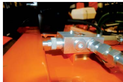
Rozdzielacz z regulacją prędkości obrotowej szczotek
