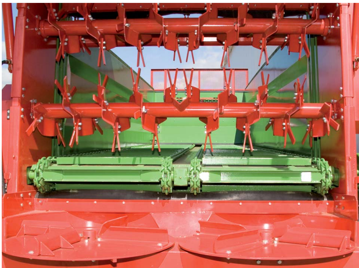
Adapter rozdrabniający dwuwalcowy poziomy oraz dwa talerze mechanizmu szerokiego rozrzutu rozrzutnika N262
