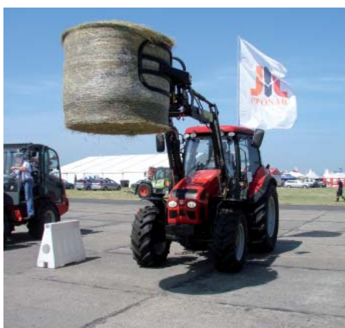
Ciągnik PRONAR 5135 z ładowaczem czołowym LC3
