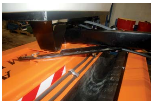
Listwa regulująca kąt pracy zmiatarki
