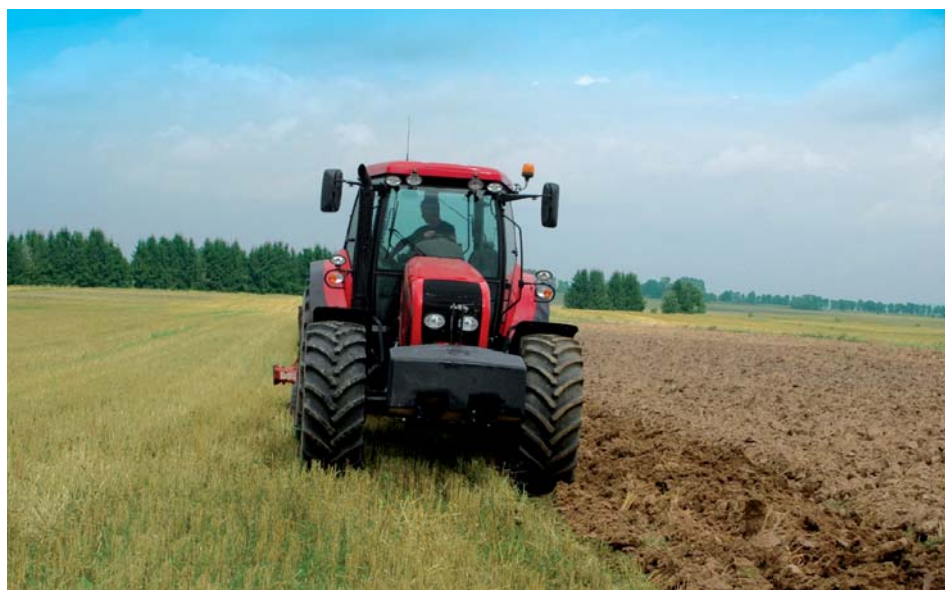
Ciągnik PRONAR 6180 serii P10 z przednim TUZ-em i dodatkowym dociążeniem przedniej osi
