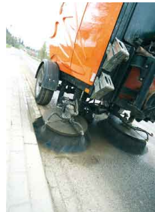
Zespół zmiatający zmiatarki ZMC 2.0 składający się z systemu zraszającego, szczotek talerzowych oraz ssawy
