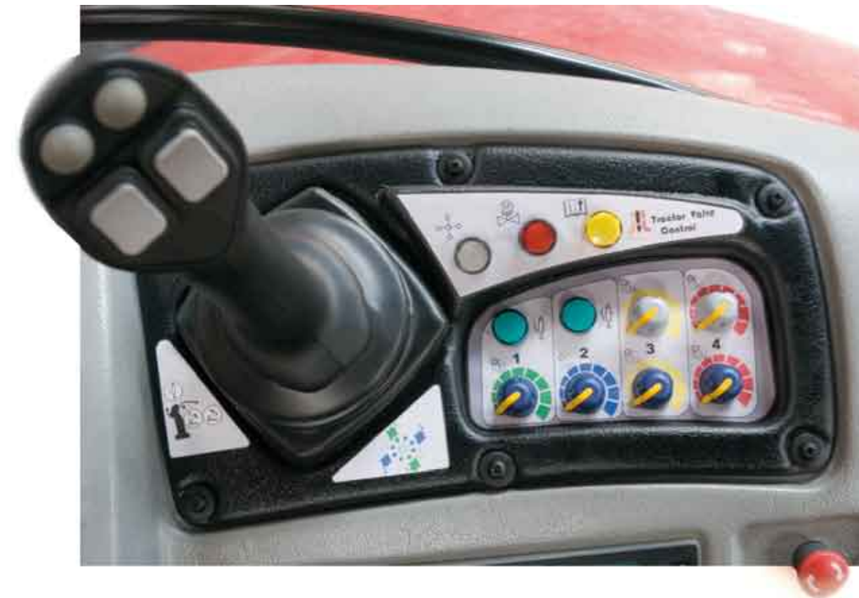
Oznaczenia elementów sterujących systemem elektrohydrauliki
