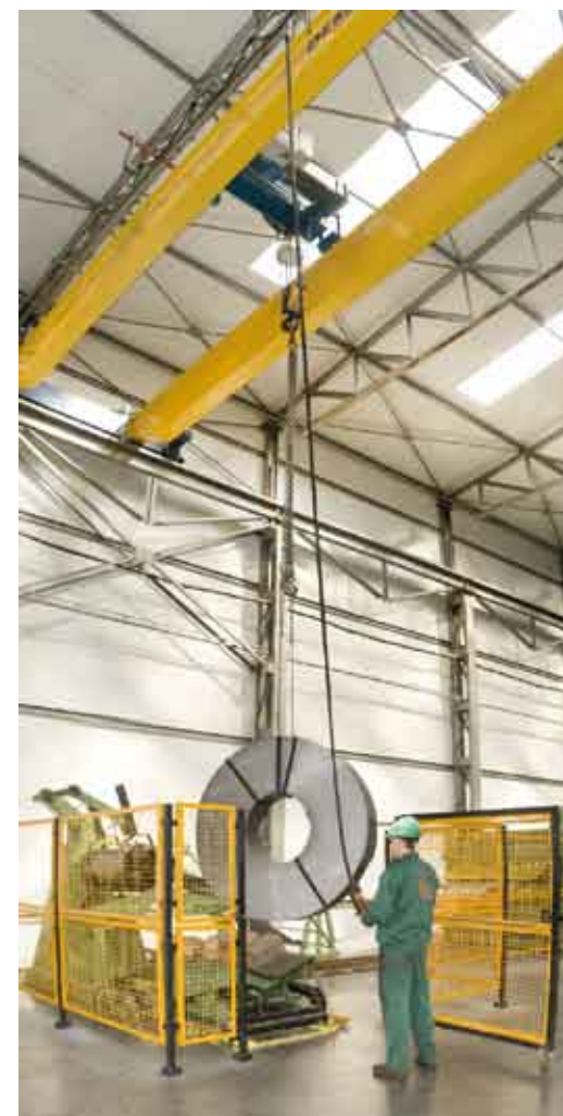
Ładunek nowej beli blachy na trzpień „rozwijarki”
