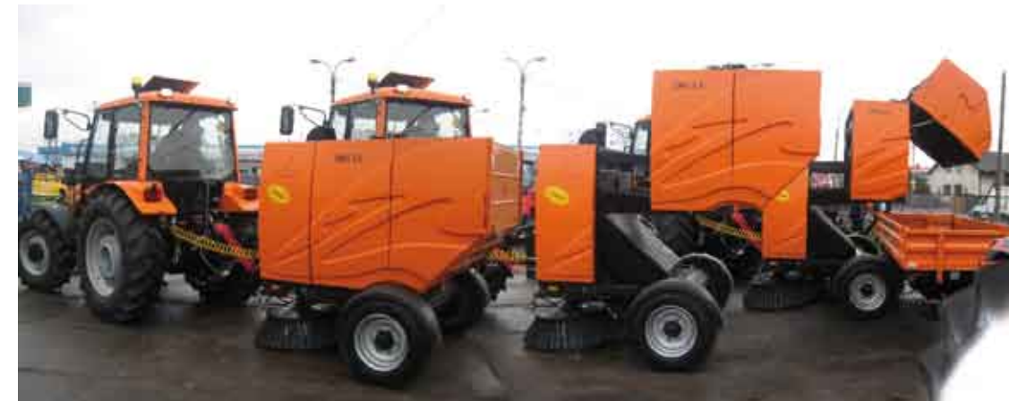
ZMC 2.0 z hydraulicznie unoszonym zbiornikiem o pojemności 2,1 m³ z możliwością opróżniania do kontenera lub na przyczepę
