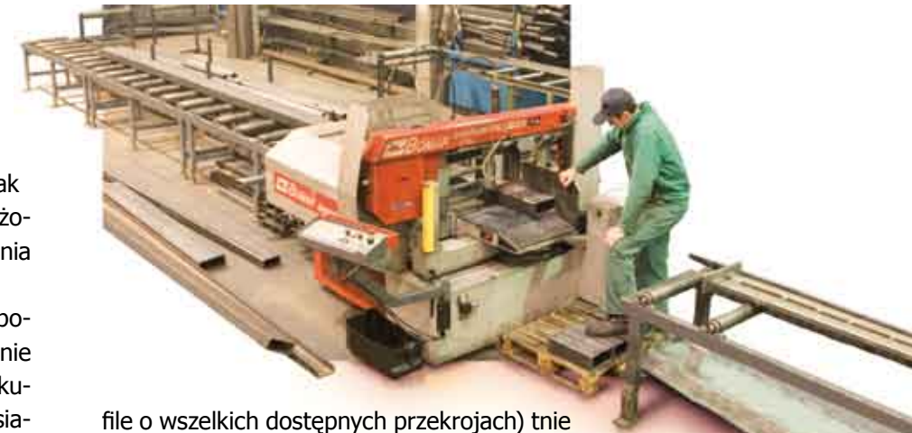
Podawanie długich elementów umożliwiają stoły z rolotokami
