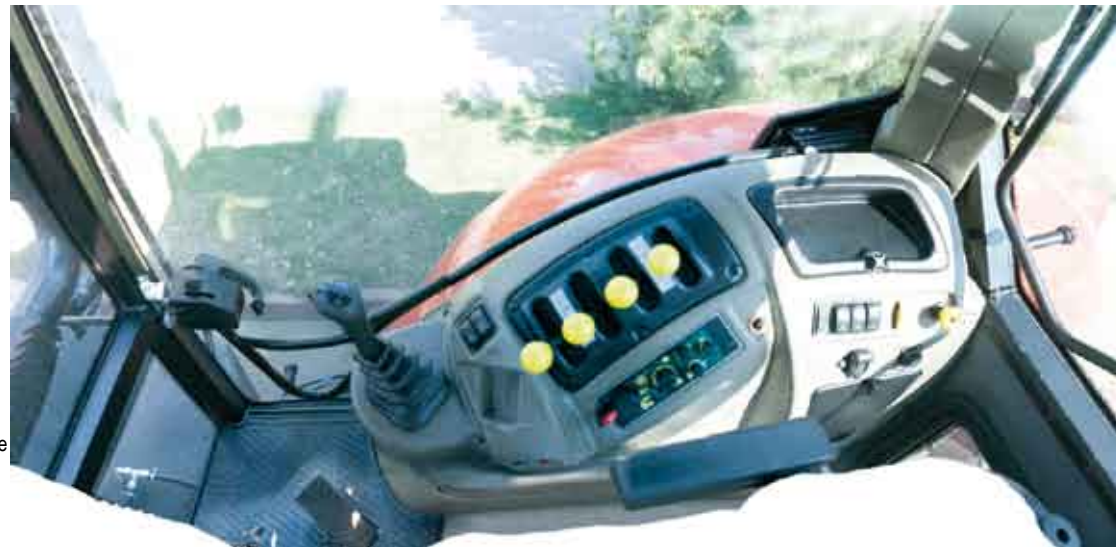
Komfort sterowania ww. elementami zapewnia ergonomiczne rozmieszczenie dźwigni rozdzielacza oraz pulpitu sterowania EHR - z prawej strony siedziska w zasięgu ręki operatora
