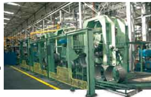
Nowoczesna, w pełni zautomatyzowana, linia MP5 do profilowania obręczy
