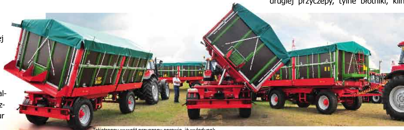
Trójstronny wywrót przyczepy sprawia, iż wyładunek ładunku nie stwarza żadnych trudności, bez względu na warunki pracy
