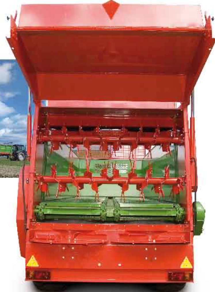
Zespół bębnowy ślimakowych dokładnie rozdrabnia podawany materiał
