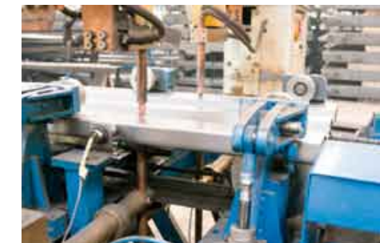
Proces zgrzewania zwarciovego stosuje się podczas łączenia długich elementów
