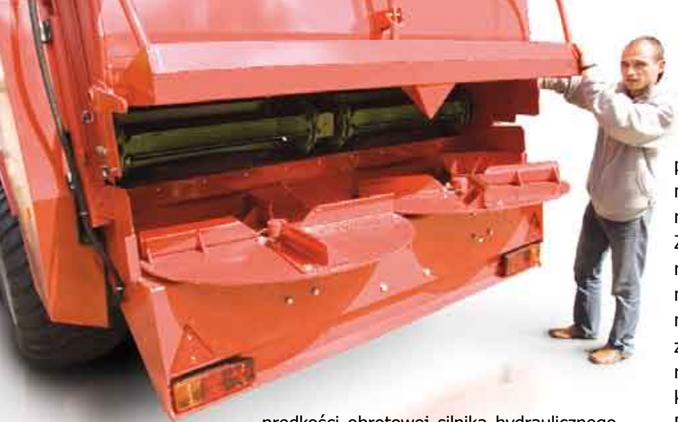
Dzięki talerzom z regulowanymi łopatkami można zawsze uzyskać optymalną szerokość rozrzutu
