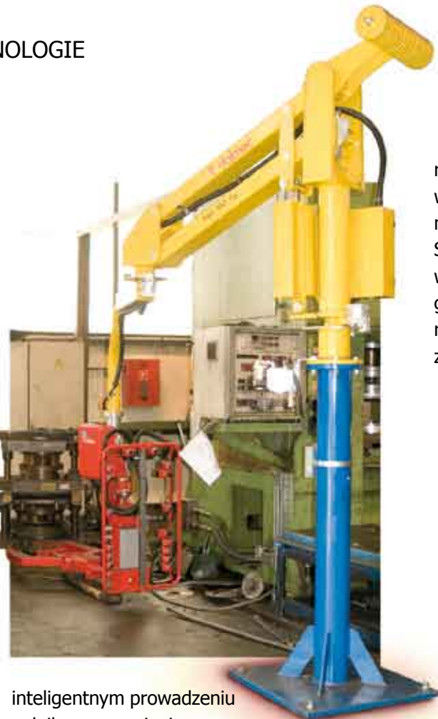
Manipulator wspomagający przenoszenie ładunków. Tutaj - przystosowany do załadunku prasy hydraulicznej
