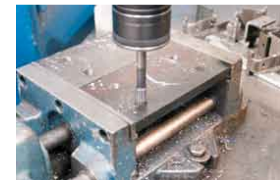
Specjalistyczne urządzenia do gwintowania pozwalają na szybkie gwintowanie otworów przelotowych bądź nieprzelotowych
