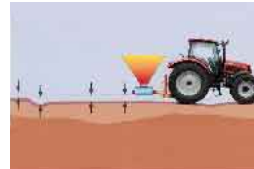
Rys. 5a. Regulacja pozycyjna. Układ utrzymuje stały odstęp maszyny od podłoża. Zapewnia to równomierne rozłożenie materiału siewnego lub nawozu na polu
