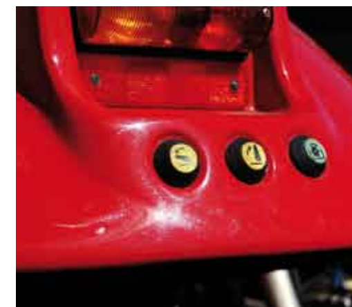
Przyciski sterowania podnośnikiem na lewym błotniku na zewnątrz ciągnika
