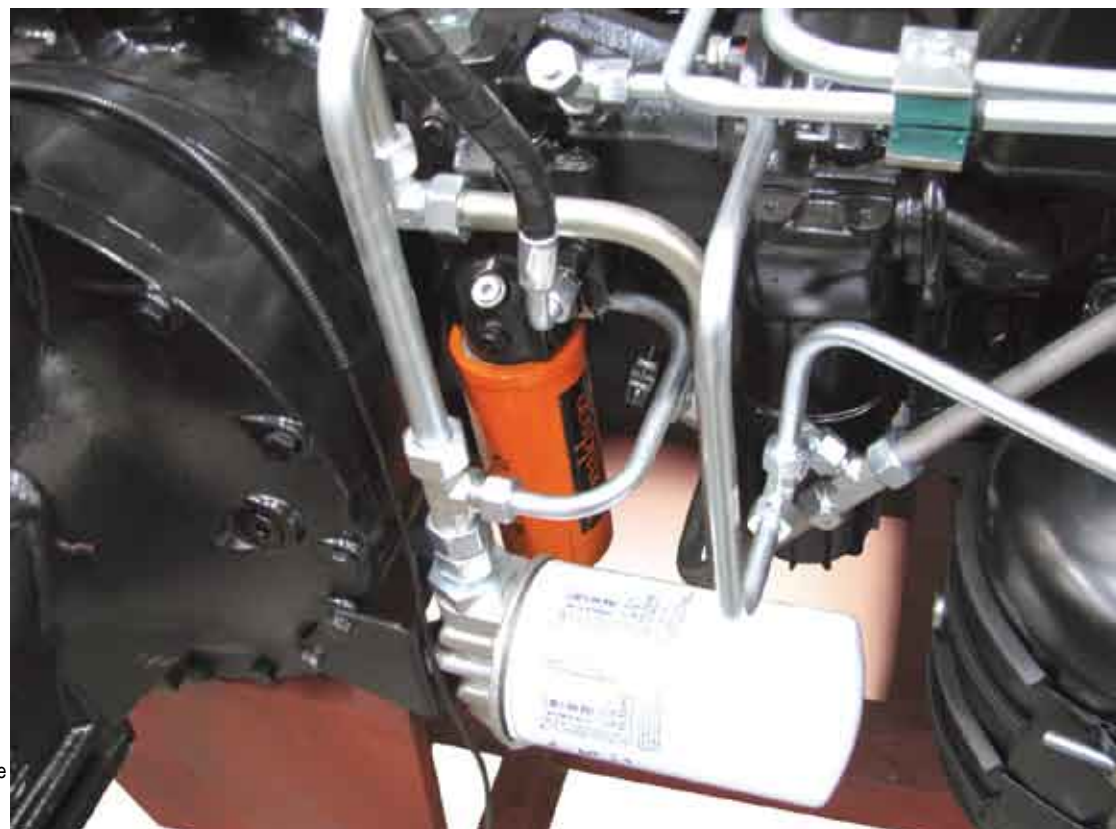
Rozmieszczenie filtrów w układzie hydraulicznym ciągnika P6
