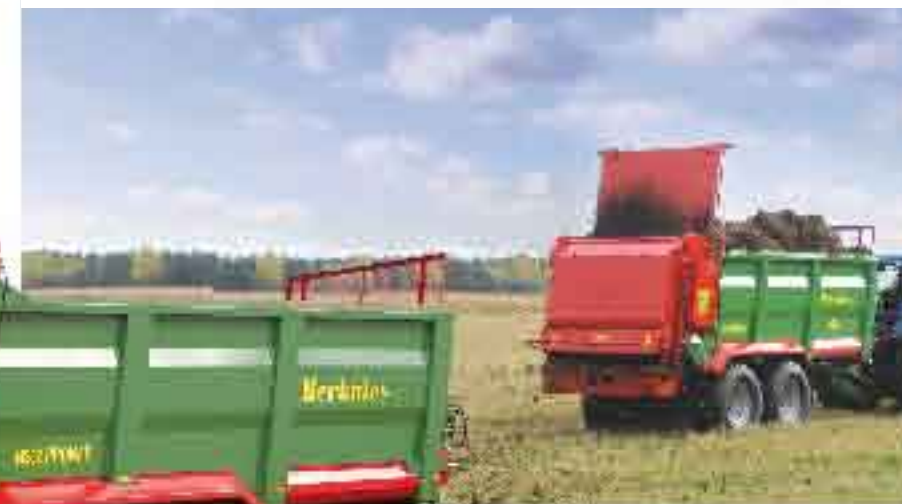
Adapter rozrzucający precyzyjnie i równomiernie rozrzuca różnego rodzaju nawozy na szerokość od 12 do 25 metrów
