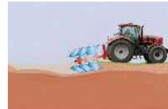
Rys. 5b. Regulacja siłowa. Układ utrzymuje stałą siłę uciagu traktora, zagłębiając lub unosząc maszynę. Pozwala to optymalnie wykorzystać moc
