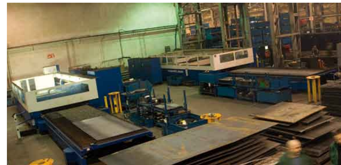
Najwyższą dokładność oraz szybkość wykonania detali uzyskujemy w procesie wypalania laserowego
