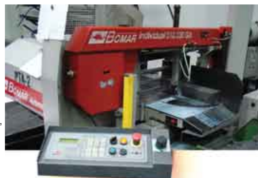
Półautomatyczne i automatyczne przecinarki taśmowe umożliwiające cięcie pakietowe, prowadzące do usprawnienia procesu cięcia
