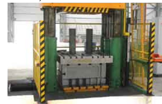
Certyfikowane laboratorium badawcze - stanowisko do badania wytrzymałości kół tarczowych. W tle skład kół przed malarnią
