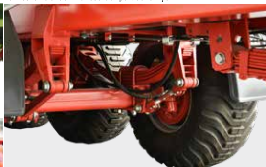
Zawieszenie tridem na resorach parabolicznych
