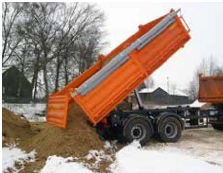
PC2100- rozładunek przyczepy. Burtę tylną uchylną otwierano automatycznie w momencie wywrotu.
