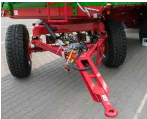
Dyszel typu Y z zaczepem sztywnym z okiem ø40mm
