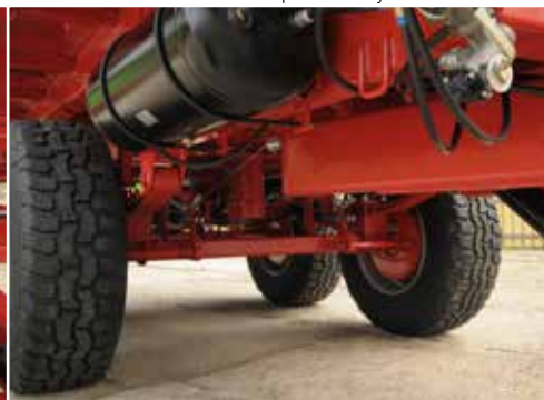
Zawieszenie tandem na resorach parabolicznych
