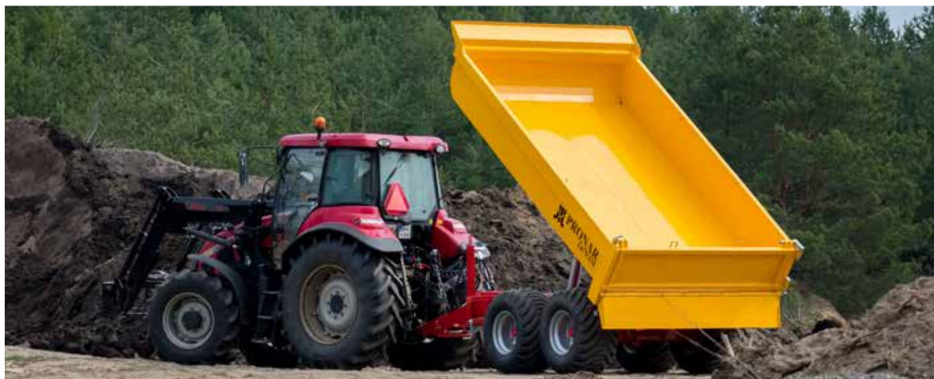
T679/4M - Skrzynia ładunkowa o budowie skorupowej (wersja budowlana); ściana boczna i podłoga podłogi wykonane z jednego arkusza blachy
