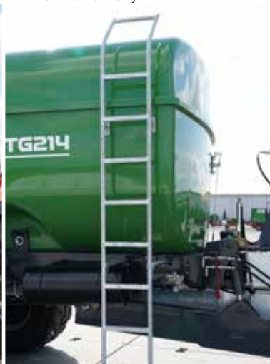
Drabinka i właz kontrolny
