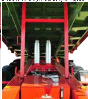
Dwa siłowniki wywrotu do tyłu - kąt 50°
