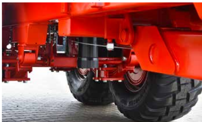
Zawieszenie tandem na resorach parabolicznych
