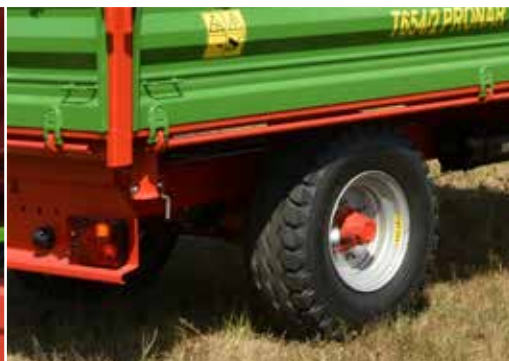
Łatwiejszy załadunek dzięki nisko położonej skrzyni ładunkowej
