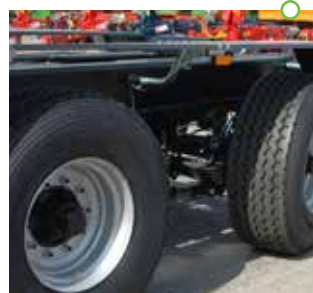
Zawieszenie z tylną osią skrętną kierowaną biernie
