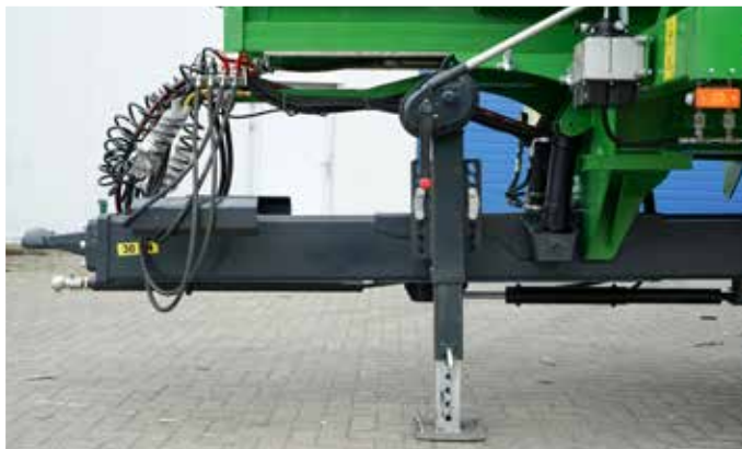
Dyszel uniwersalny sztywny amortyzowany hydraulicznie
