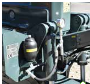
Dyszel amortyzowany hydraulicznie
