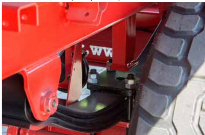
Zawieszenie na resorach parabolicznych z odbojnikiem stalowym
