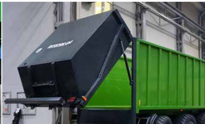
Hydraulicznie podnoszona kłapa tylna z automatycznym dociskiem i ryglowaniem
