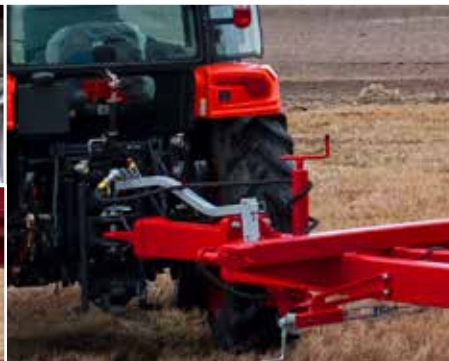
T654/2 - Dyszel sztywny do łączenia z górnym zaczepem ciągnika
