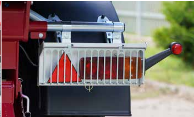
Tylne lampy oświetleniowe z kratkami zabezpieczającymi przed uszkodzeniem
