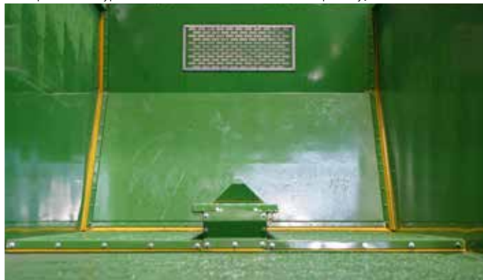
Ściana przesuwana wyposażona w elastomerowe uszczelniacze zapewniające szczelność
