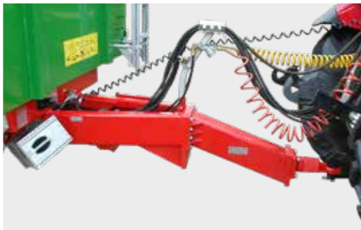
Uniwersalny dyszel umożliwiający łączenie z dolnym lub górnym zaczepem transportowym ciągnika
