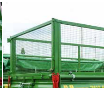
Nadstawy siatkowe o wysokości 1000mm
