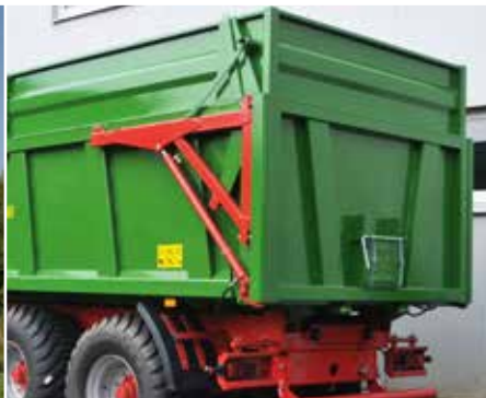
Hydrauliczny system unoszenia kłapy tylnej
