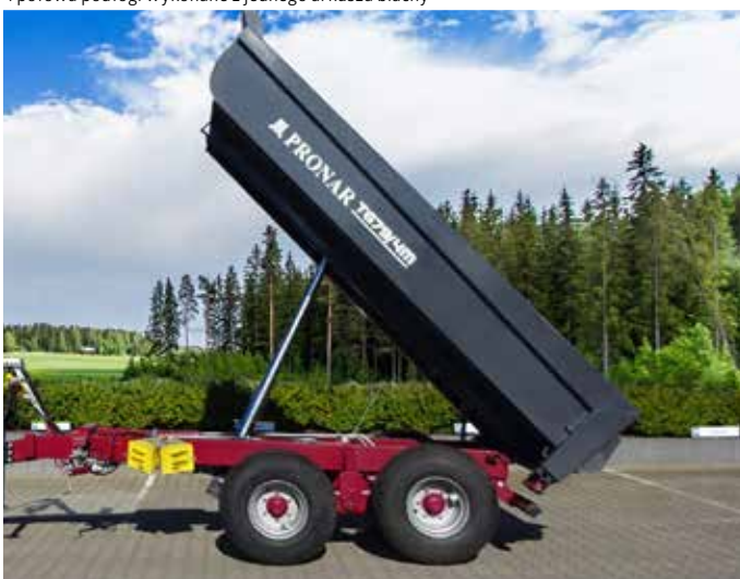
Hydrauliczna kłapa tylna uchylana do dołu
