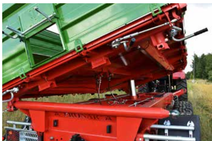
System wywrotu trzystronnego z przegubami kulowymi tylnymi amortyzowanymi
