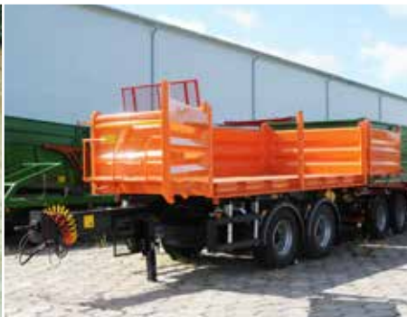
PC2100- lewa burtę uchylną i otwierano na boki
