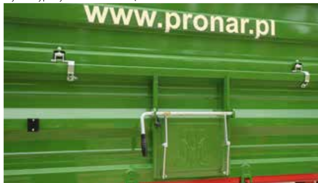
Szyber zsypany do ziarna z blokadą
