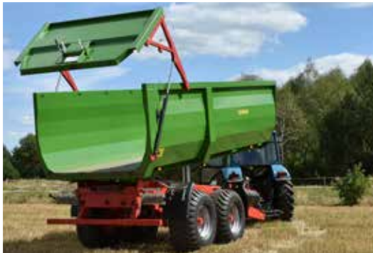
T700 - Skrzynia ładunkowa z profilowanymi ścianami z pionowym żebrzem wzmacniającymi po bokach, ze ścianą tylną podnoszoną hydraulicznie
