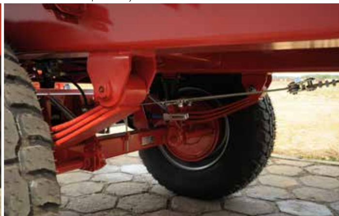
Solidne osie na resorach parabolicznych
