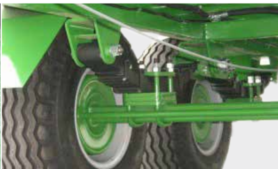
Zawieszenie tandem na resorach piórowych w T046/1
