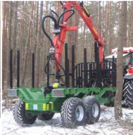
Mocne supki i przednia bariera zabezpieczająca
