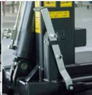
Manualne przełączenie funkcji hakowic-wywrotka
