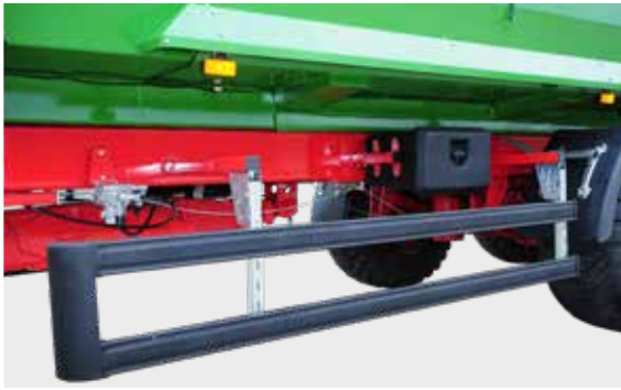
T700M - Boczne zabezpieczenia
