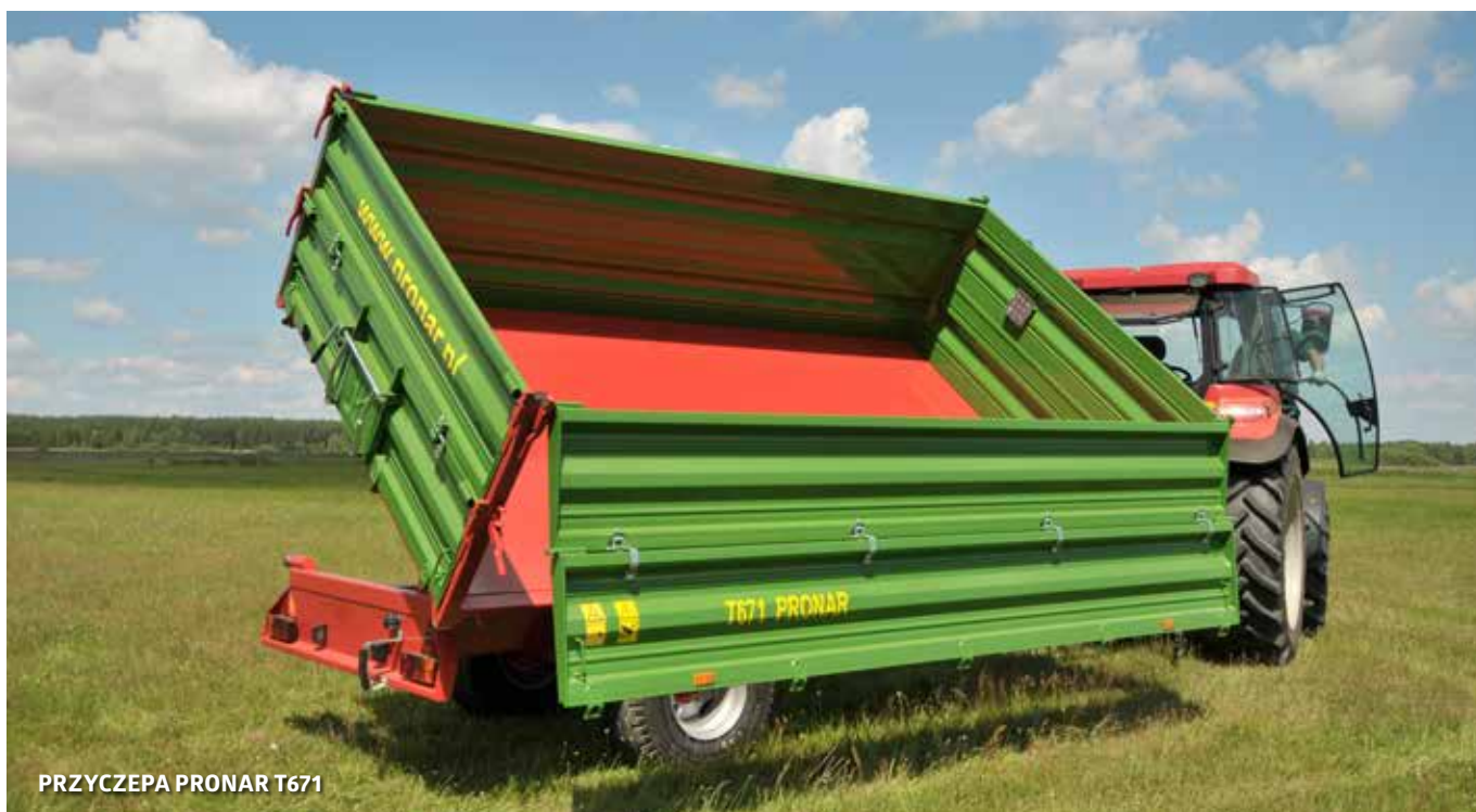
System wywrotu trzysstronnego z siłownikiem teleskopowym, z zawieszem przegubowym
