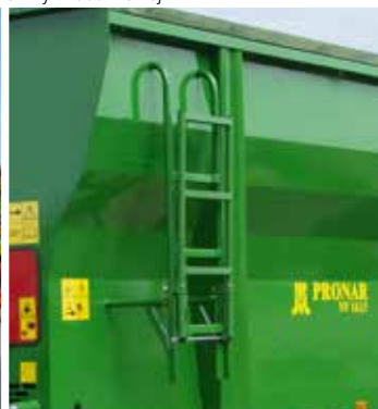
Składana drabinka ułatwiająca dostęp do skrzyni ładunkowej
