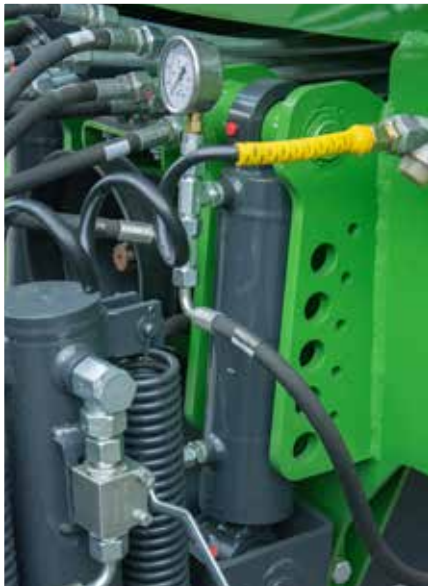
Regulowany hydraulicznie dyszeldoskonale amortyzuje maszynie
