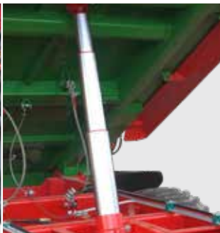
Teleskopowy siłownik wywrotu skrzyni ładunkowej z zawieszem przegubowym
