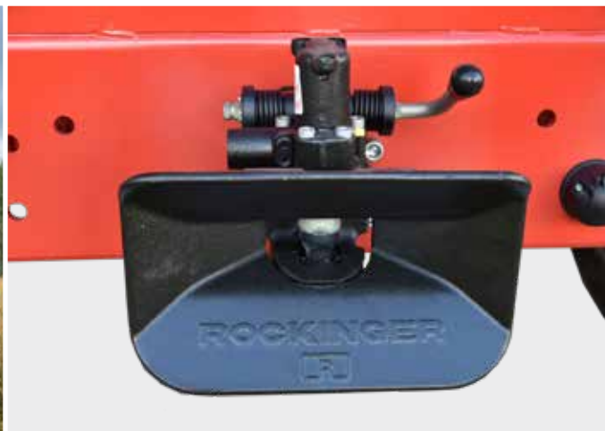
Zaczepek tylny automatyczny rockinger
