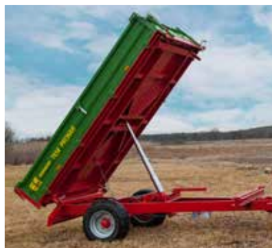
System wywrotu trzysstronnego z siłownikiem teleskopowym, z zawieszem przegubowym
