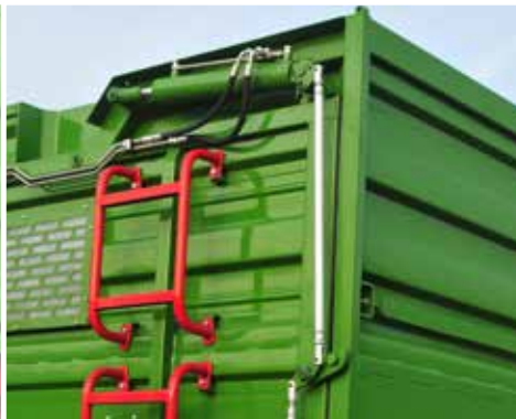
Hydrauliczny system ryglowania i podnoszenia ściany bocznej (T683H)
