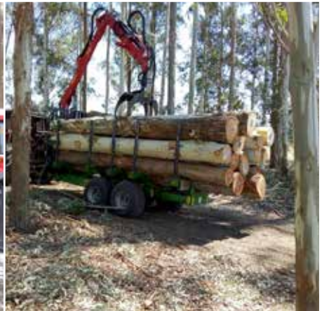
Wysuwana hydraulicznie tylna rama z poprzeczką i kłonicami
