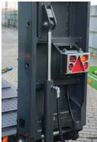
Mechaniczny system opuszczania/podnoszenia najazdów
