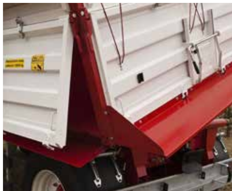
Hydrauliczne sterowanie i ryglowanie ściany bocznej unoszonej (T680H)
