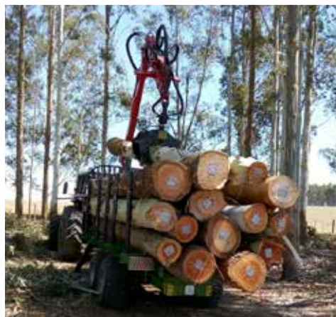
Żuraw na teleskopowych podporach z chwytakiem obrotowym
