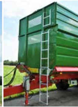
T700M - Drabinka ułatwiająca dostęp do skrzyni ładunkowej
