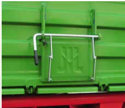
Szyber zsypany do ziarna, z blokadą, w ścianie tylnej
