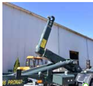
Podnoszenie realizowane dwoma siłownikami hydraulicznymi
