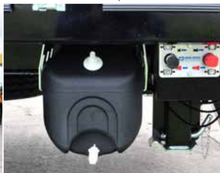
PC2200 - pneumatyczna instalacja hamulcowa z EBS Knorr-Bremse i zbiornik na wodę
