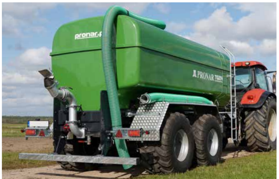
Wóz asenizacyjny TG 214 z rozlewaczem udarowym.
