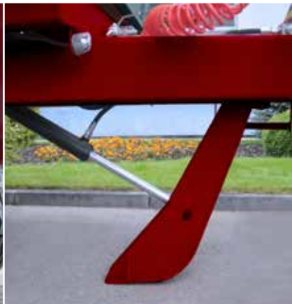
Hydrauliczna, nożycowa noga podporowa
