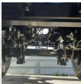
Zawieszenie typu tandem na 4 resorach parabolicznych
