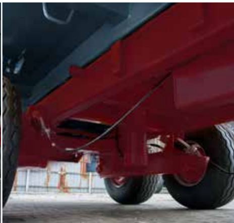
Zawieszenie tandem z resorami parabolicznymi wT679/2 i T701
