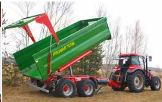
Skrzynia ładunkowa o budowie skorupowej z profilowanymi ścianami ze wzmocnionym obrzeżem górnym (T679M)
