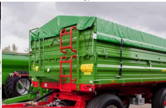
Plandeka rolowana ze stelażem, balkon do obsługi plandeki
