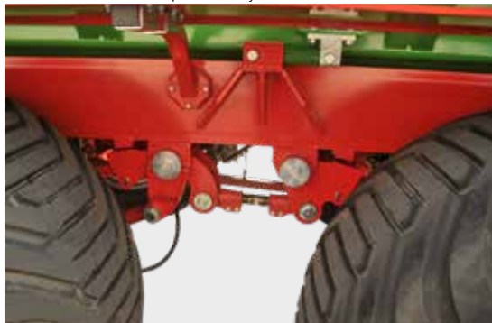
Zawieszenie na resorach parabolicznych
