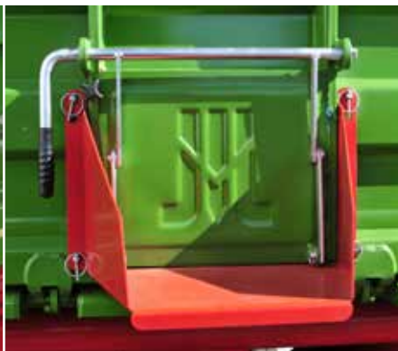
Blokada burty portalowej zabezpieczająca przed samoczynnym zamykaniem i uszkodzeniem
