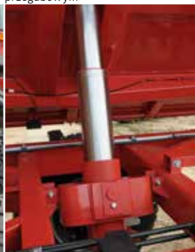
Teleskopowy siłownik wywrotu skrzyni ładunkowej z zawiesiem przegubowym
