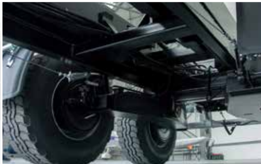
Zawieszenie tandem sztywne typu boogie
