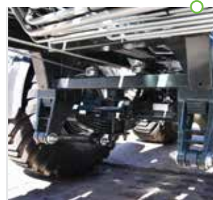
Zawieszenie tandem na resorach parabolicznych
