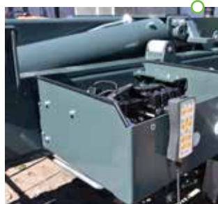
Centralny układ hydrauliczny sterowany elektrycznie
