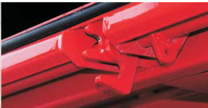
Solidny system ryglowania ścian przy podłodze
