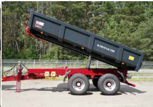
Hydraulicznie otwierana klapa tylna (T701)
