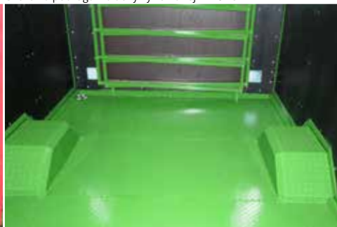
Szczelna podłoga z blachy ryflowanej w T046
