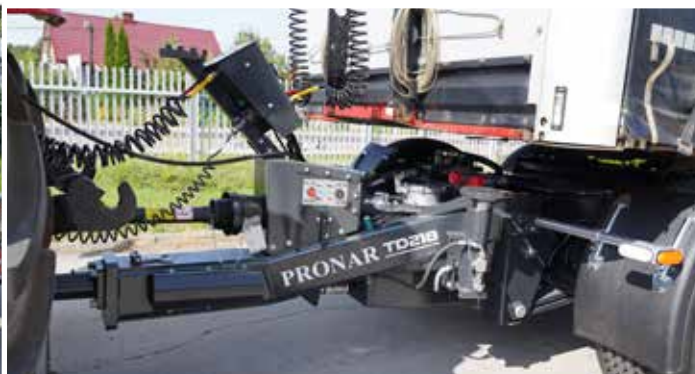
Dyszel przyłączeniowy dolny typu „Y”
