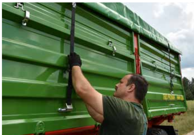
Rolowana plandeka z mocnymi napinaczami pasów
