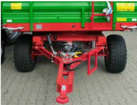
Dyszel typu Y z okiem 40mm
