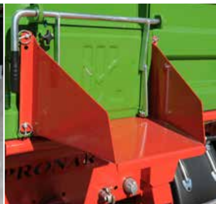
Szyber zsypany do ziarna, z blokadą, w ścianie tylnej
