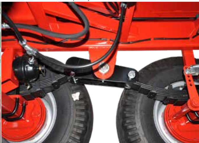
Zawieszenie tandem na 4 resorach piórowych
