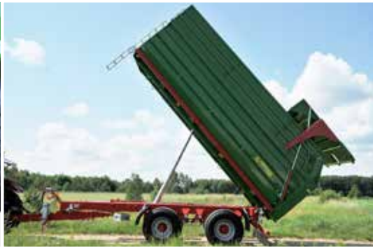
T700M - Kąt wychylenia skrzyni ładunkowej - do tyłu 55°
