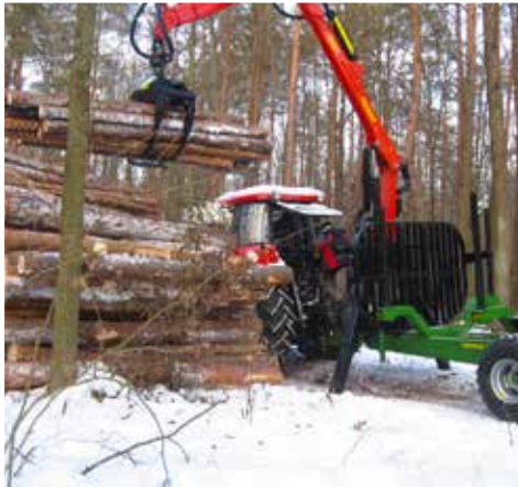
Hydrauliczne teleskopowe podpory ładowacza
