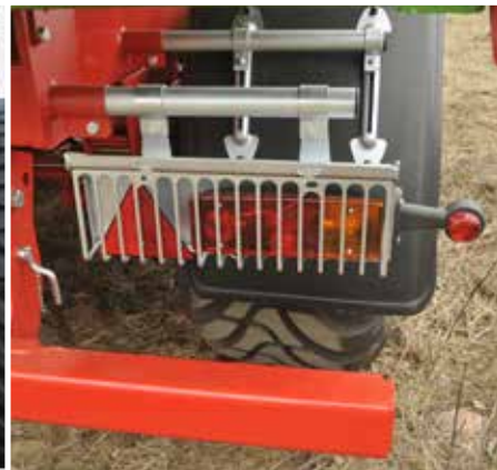
Tylnie oświetlenie przyczepy jest zabezpieczone przed uszkodzeniami specjalnymi kratkami
