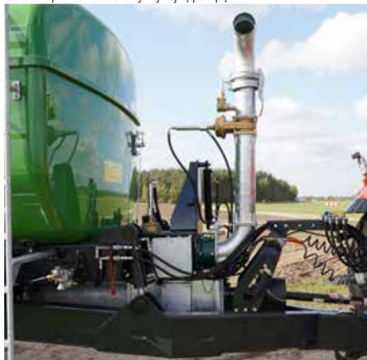
Układ napełniania zasilany wydajną pompą
