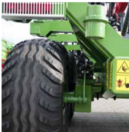
Zawieszenie tandem z 2 wahaczami podłużnymi
