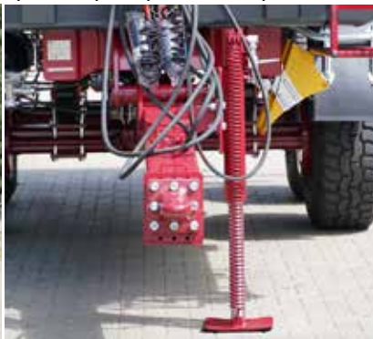
Dyszel amortyzowany resorem stalowym (T701)
