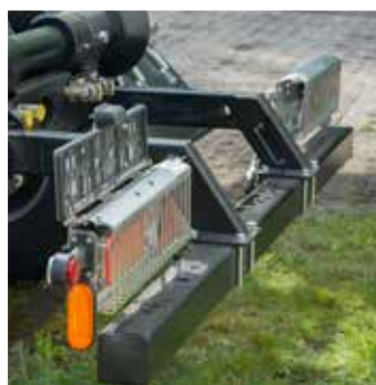
Zderzak tylny wysuwany ze światłami
