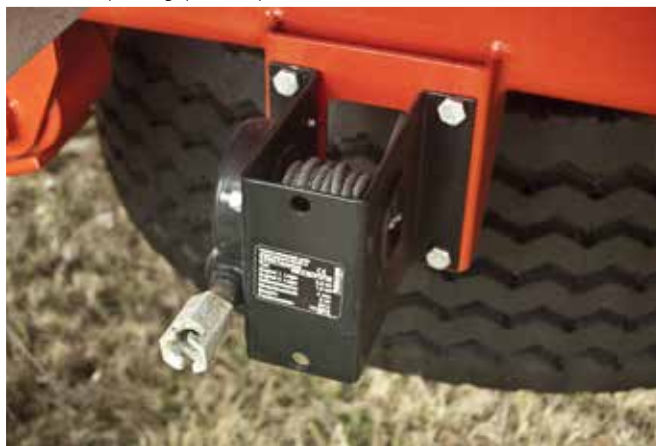
Winda koła zapasowego pod ramą podwozia
