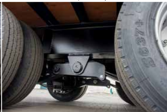
Zawieszenie tandem na resorach parabolicznych
