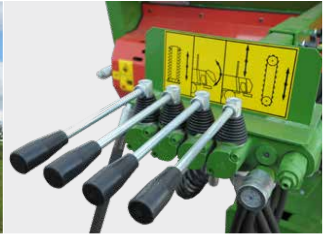
Rozrzuтник PRONAR N262/1 - hydrauliczny napęd przenośnika
