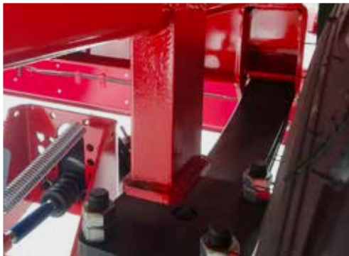
Zawieszenie na resorach parabolicznych z odbojnikiem stalowym
