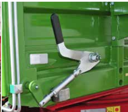
Blokada burty portalowej zabezpieczająca przed samoczynnym zamykaniem i uszkodzeniem
