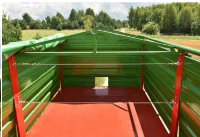
Ściany z linką spinającą z wysokiej jakości, mocnych, spawanych laserowo profili Plandeka rolowana ze stelażem z odkładaną rurą centralną i bocznymi rurami podpierającymi
