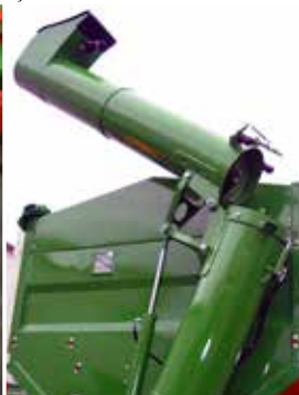
Dwusegmentowy przenośnik ślimakowy przedni rozkładany hydraulicznie
