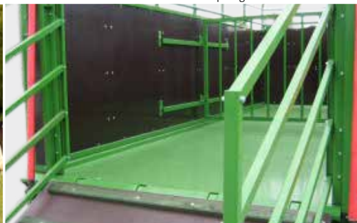
Platforma załadunkowa z barierkami oraz przegroda wewnętrzna
