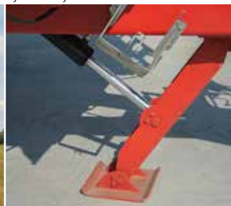
Hydrauliczna nożycowa podpora dyszla z ruchomą stopą i zabezpieczającym zamkiem hydraulicznym
