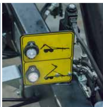
Automatyczne przełączenie funkcji hakowiec-wywrotka
