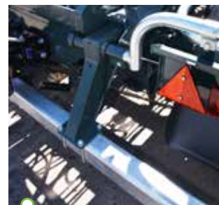
Zderzak tylny wysuwany hydraulicznie
