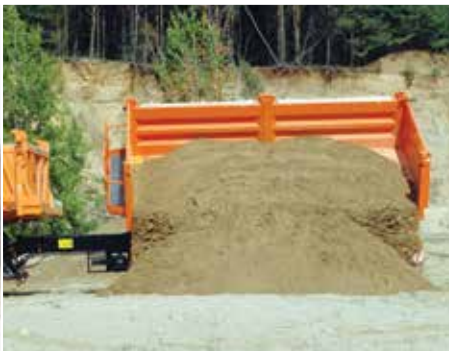
PC2100/1- rozładunek przyczepy. Burtę boczną lewą otwierano i zamykano za pomocą siłowników hydraulicznych
