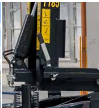
Manualne przełączenie funkcji hakowiec-wywrotka
