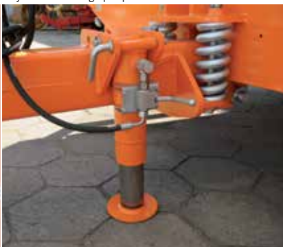
Amortyzowany mechanicznie dyszel i hydrauliczna noga podporowa
