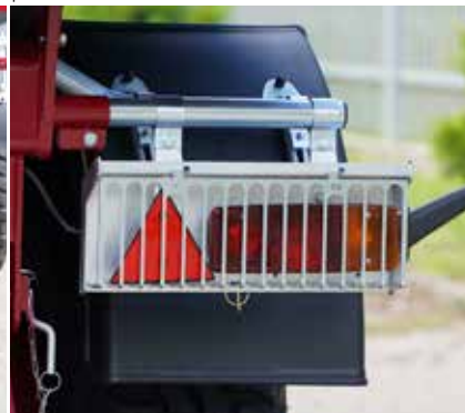
Tylny lampy oświetleniowe z kratkami zabezpieczającymi przed uszkodzeniem
