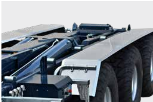
Stabilna rama z dwoma siłownikami hydraulicznymi
