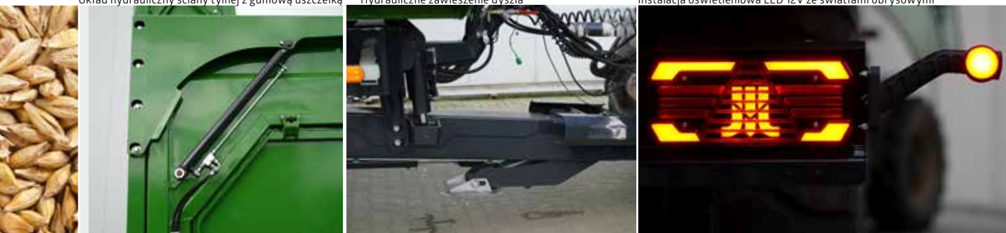
Układ hydrauliczny ściany tylnej z gumową uszczelką
