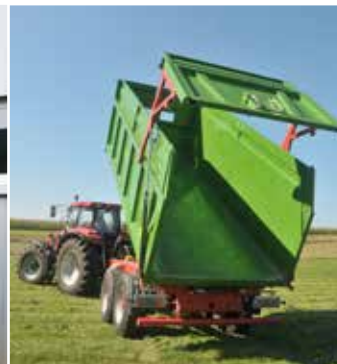
Wywrót do tyłu pod kątem 50°
