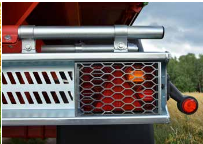
Lampy tylne LED, kratki zabezpieczające szybkodemontowalne
