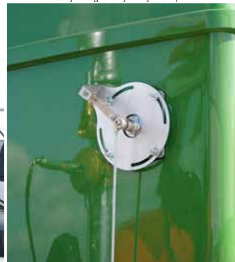
Układ hamulcowy zintegrowany z czujnikiem poziomu
