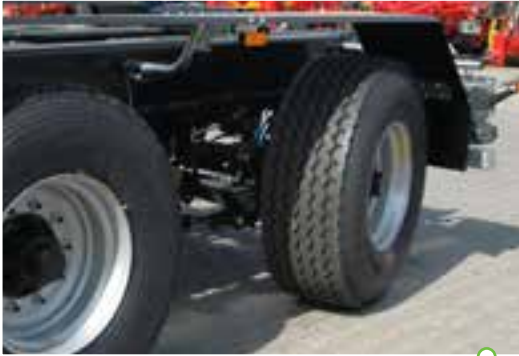
7. Zawieszenie tandem sztywne typu boogie
