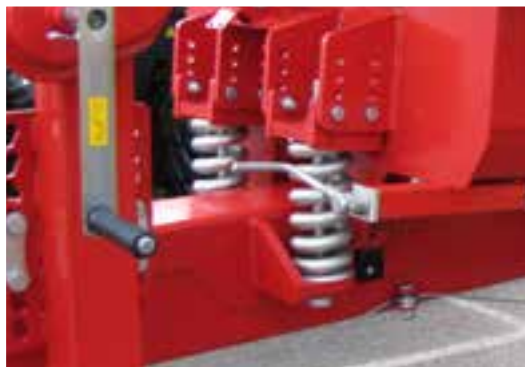
T700XL - dyszel amortyzowany sprężynami stalowymi
