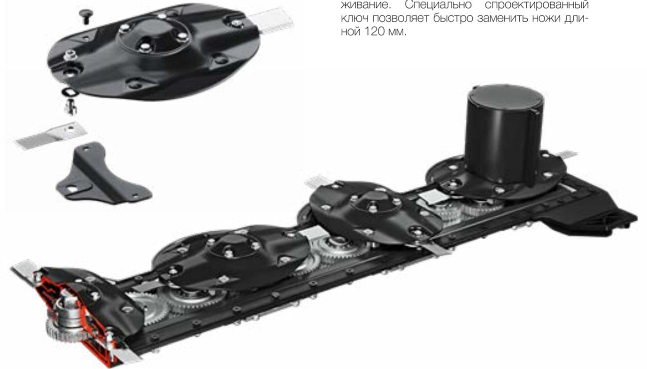
Благодаря скручиваемой конструкции бруса и модульному строению облегчается доступ ко внутренним элементам. Это сокращает потенциальные простои и облегчает обслуживание. Специально спроектированный ключ позволяет быстро заменить ножи длиной 120 мм.
