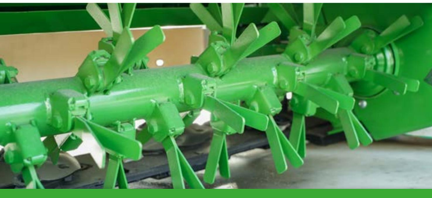
Вспушиватель повреждает и стирает слой воска с растений, что ускоряет высыхание, облегчает циркуляцию воздуха и укладывает свободный покос. Вспушивающие пальцы амортизируются резиновыми элементами. Металлические укладчики покоса облегчают направление потока скашиваемого материала.
