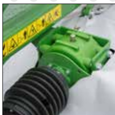
• napęd – 2 przekładnie kątowe
