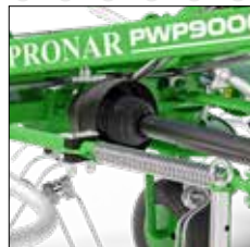
• amortyzator sprężynowy, stabilizujący maszynę
