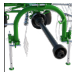
• 3-punktowy układ zawieszenia
