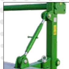
sztwna regulacja pochylenia listwy tnącej
