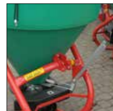
• dźwignia regulacji dawki i kierunku wysiewu
