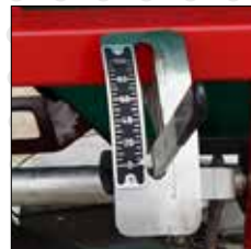
• dźwignia regulacji dawki i kierunku wysiewu
