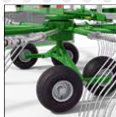
• 4-kołowe podwozie w systemie tandem – koła umiejscowione blisko palców grabiących
