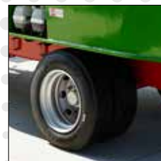
• wzmocniona oś na podwójnym ogumieniu
