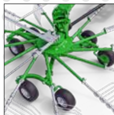
• układ jezdnny zespołu 6 kół skrętnych w układzie tandem
