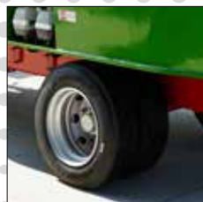
● essieu renforcé sur pneus doubles
