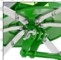
• 3 niveaux de réglage de l'angle de travail
