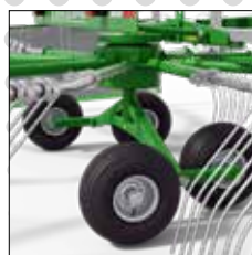
• châssis tandem à 4 roues roues positionnées près des doigts de ratissage
