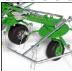
• pneus toupies centrales - 18,5x8,5 • toupies sur les côtés - 16x6,5
