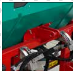
● système d'attelage sur le tracteur
