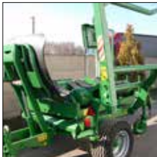
● système de chargement des balles latéral
