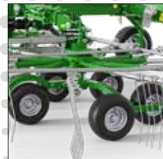
● 5 roues directrices dont 1 orientable à l'avant
