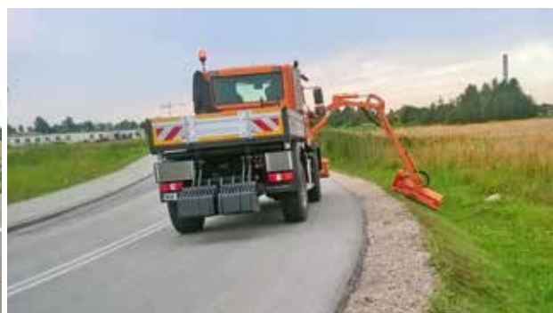
Wykazanie trudnodostępnego pobocza za pomocą wysięgnika WWP500U i głowicy GK 110
