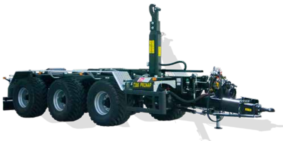
Hydrauliczny układ skrętu – siłowniki dwustronnego działania po prawej stronie dyszla
