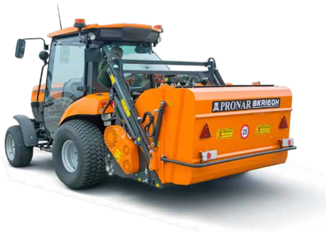
Wysoki wyładunek 2000 mm
