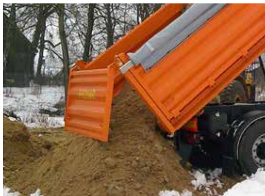
Burta tylna uchylna otwierana automatycznie w momencie wywrotu
