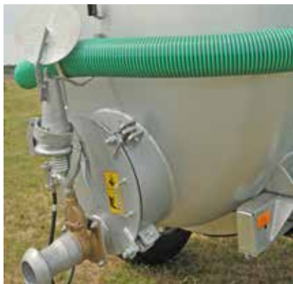
Króciec spustowy w najniższym punkcie zbiornika
