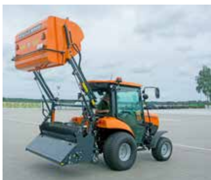
Wysoki wyładunek 2000 mm
