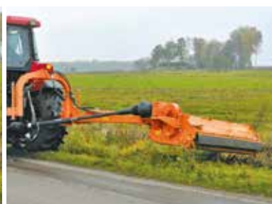
Przesuw hydrauliczny kosiarki 1820 mm pozwala całą szerokością pracować poza obrysem ciągnika
