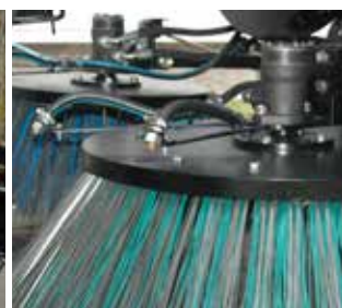
System zraszający przed szczotkami talerzowymi
