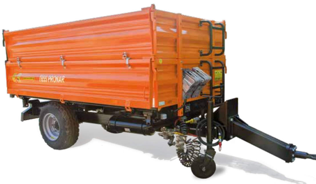
Siłownik teleskopowy trójstronnego wywrotu. Podpora serwisowa skrzyni ładunkowej
