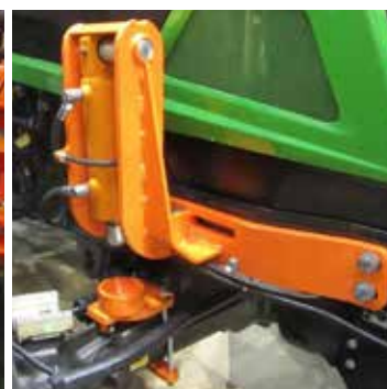
Blokada hydrauliczna przedniej osi
