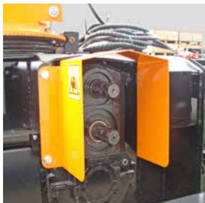
Przekładnia z dwoma końcówkami WOM (540/1000 obr./min)
