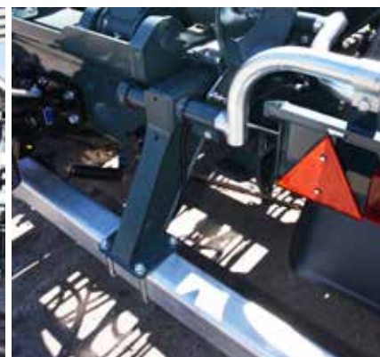
Zderzak tylny wysuwany hydraulicznie
