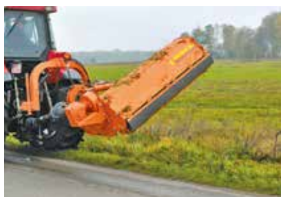
Możliwość regulacji kąta pracy w zakresie od -65° do +94
