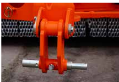
Zabezpieczenie mechaniczne kosiarki
