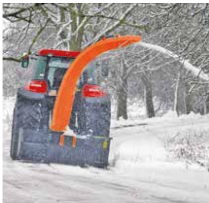
Komin wysokiego wyrzutu
