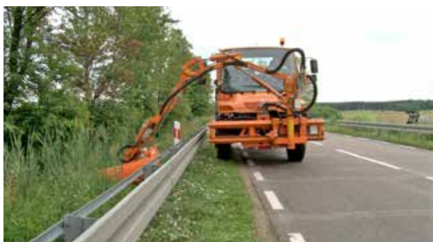
Wykazanie trudnodostępnego pobocza za pomocą wysięgnika WWP500U i głowicy GK 110
