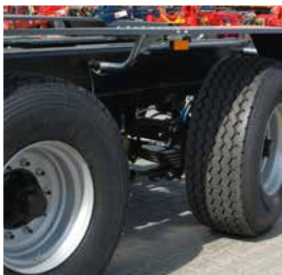
Zawieszenie z tylną osią skrętną kierowaną bierne
