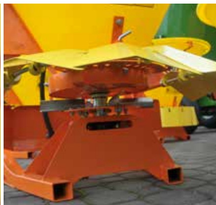
Talerz rozsypujący ze stali nierdzewnej
