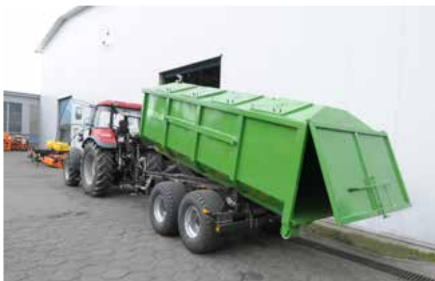
Kontener KP10 podczas załadunku na przyczepę hakową T-185
