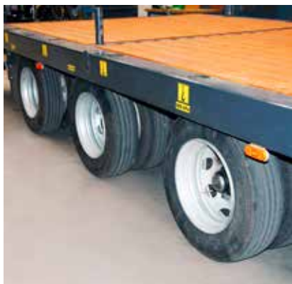
Zawieszenie trzyosiowe, mechaniczne na resorach parabolicznych
