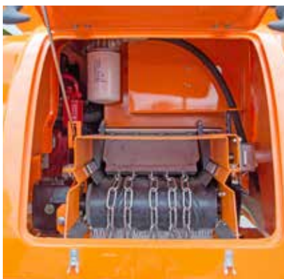
Materiał transportowany jest przenośnikiem taśmowym do układu zasypowego
