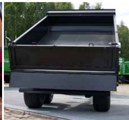
Kłapa tylna rozwierno-wahliwa Tylne zabezpieczenie, sztywne
