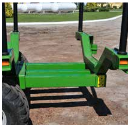
Wysuwana hydraulicznie tylna rama z poprzeczką i kłonicami
