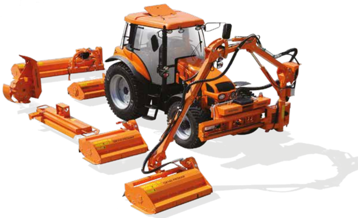
Przesuw hydrauliczny wysięgnika po prowadnicy umożliwiający dobór odpowiedniej pozycji roboczej
