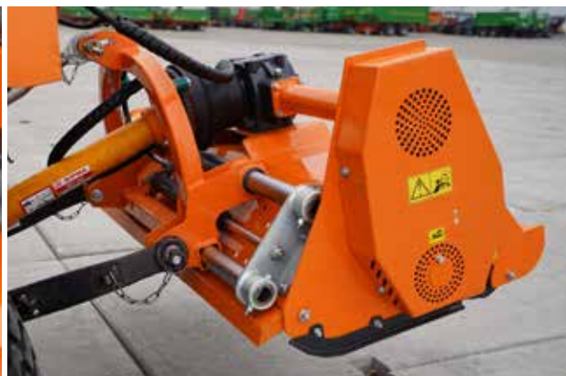
Układ zawieszenia ruchomy (przesuw hydrauliczny poprzeczny 350 mm)
