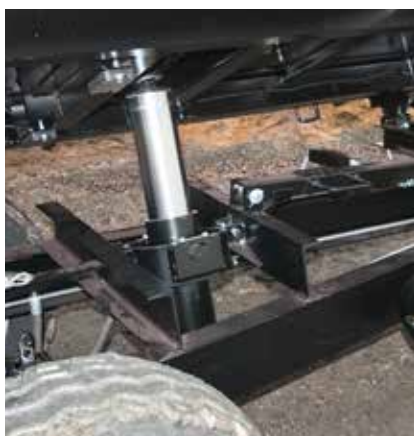
Siłownik teleskopowy trójstronnego wywrotu. Podpora serwisowa skrzyni ładunkowej
