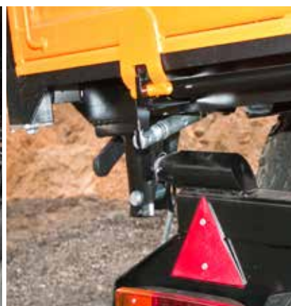
Wybór kierunku wywrotu za pomocą sworzni
