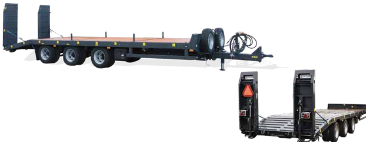
Zawieszenie trzyosiowe, mechaniczne na resorach parabolicznych
