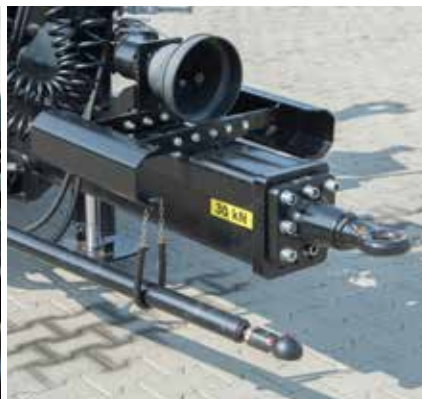
Hydrauliczny układ skrętu – siłowniki dwustronnego działania po prawej stronie dyszla
