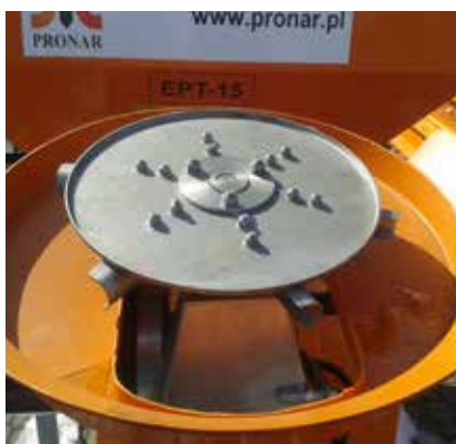
Tarcza rozsiewająca ze stali nierdzewnej
