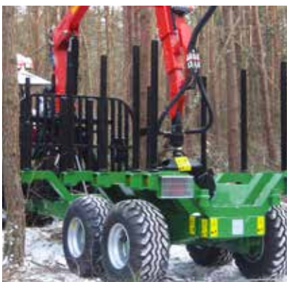
Mocne słupki i przednia bariera zabezpieczająca
