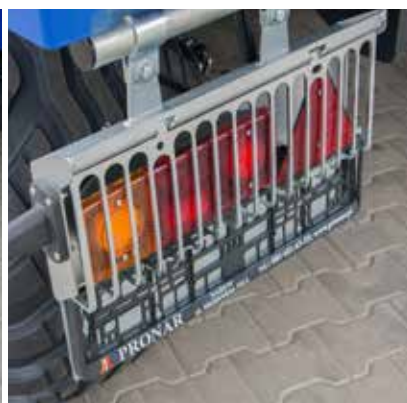
Tylne lampy oświetleniowe z kratkami zabezpieczającymi przed uszkodzeniem
