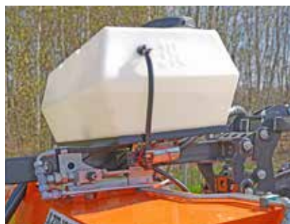
Zbiornik na wodę o pojemności 200 litrów
