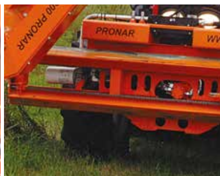
Przesuw hydrauliczny wysięgnika po prowadnicy umożliwiający dobór odpowiedniej pozycji roboczej
