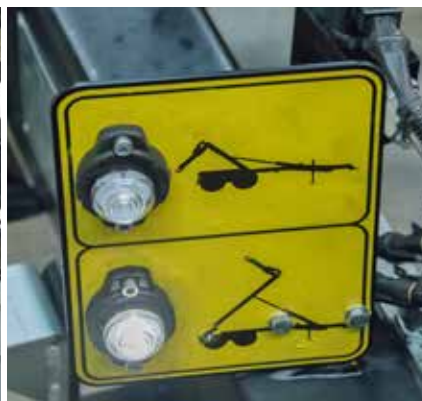
Informacja świetlna przełączania funkcji hakowiec-wywrotka (T185/1)
