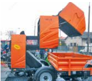
Hydrauliczny system opróżniania kosza
