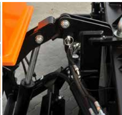
Siłownik hydrauliczny do podnoszenia / opuszczania
