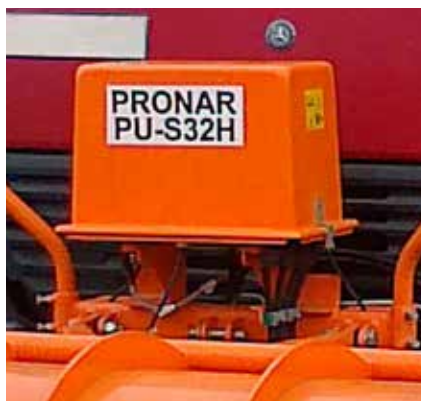
Zasilacz hydrauliczny (Power Pack)
