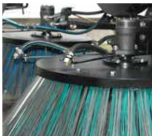
System zraszający przed szczotkami talerzowymi
