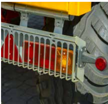
Tylne lampy oświetleniowe z kratkami zabezpieczającymi przed uszkodzeniem
