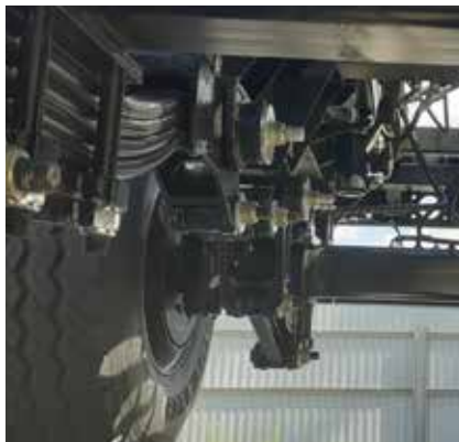
Zawieszenie typu tandem na 4 resorach parabolicznych
