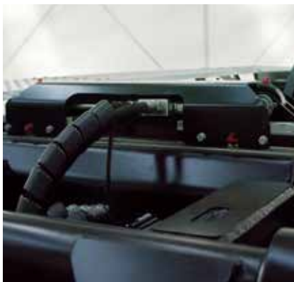
Hydrauliczna blokada kontenera
