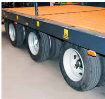
Zawieszenie trzyosiowe, mechaniczne na resorach parabolicznych
