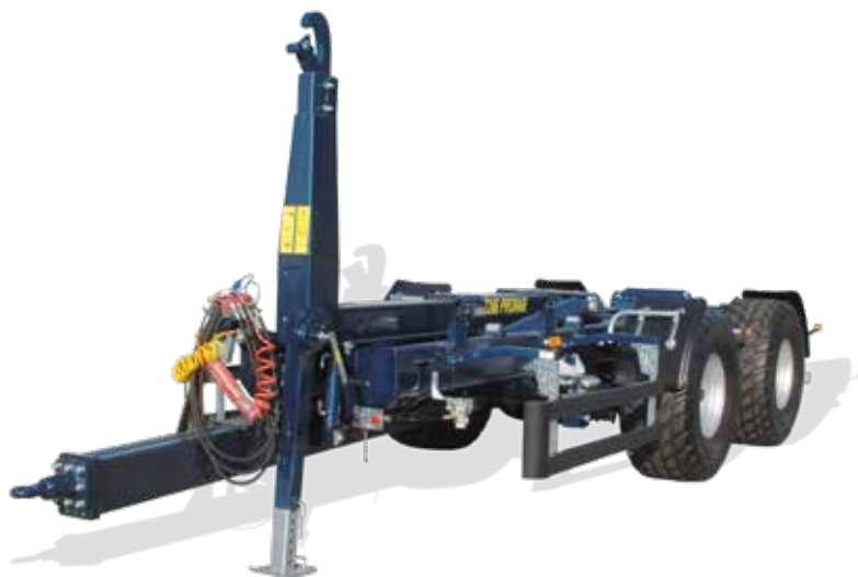
Zawieszenie z tylną osią skrętną kierowaną biernie
