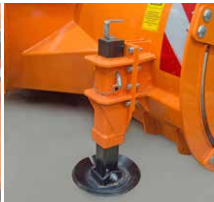
Ślizgi ze stali trudnościaralnej lub koła podporowe
