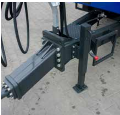
Mechaniczna teleskopowa podpora dyszla
