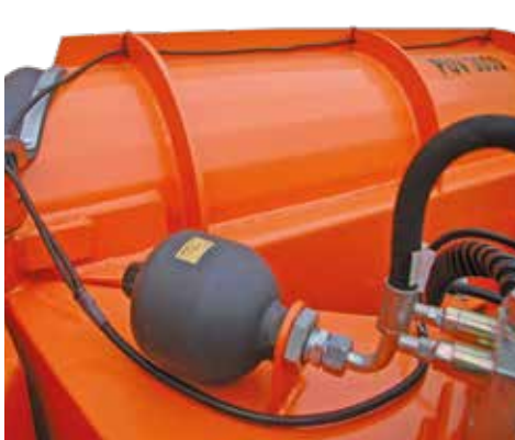
Amortyzacja hydrauliczna - opcja.
