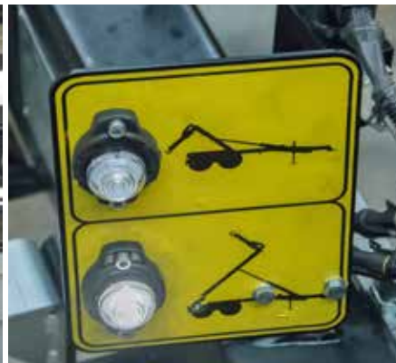
Informacja świetlna przetwarzania funkcji hakowiec-wywrotka (T185/1)
