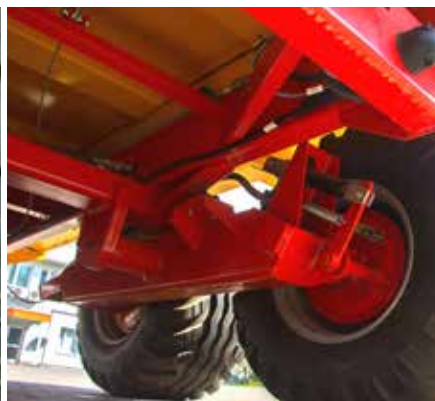
Zawieszenie tandem z wahaczami podłużnymi
