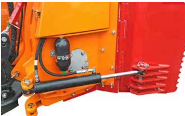
Sterowanie hydrauliczne poszerzeń
