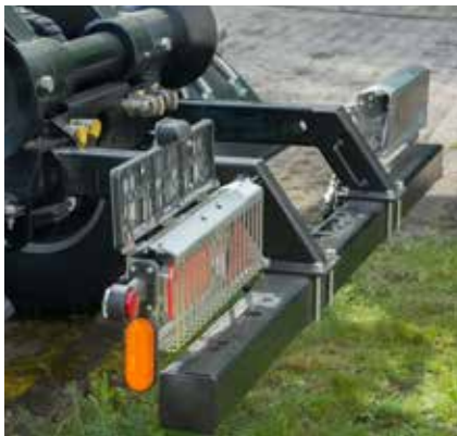
Zderzak tylny wysuwany ze światłami
