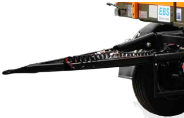
Zaczep dyszla: sztywny z okiem ø40 mm
