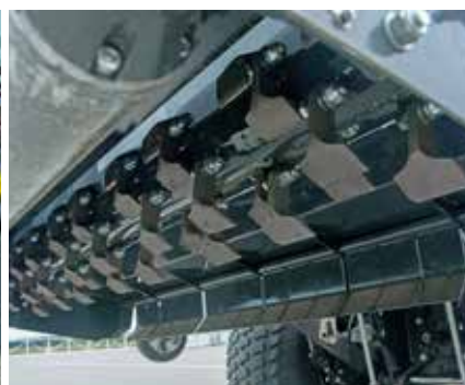
Wał tnący z wymiennymi nożami
