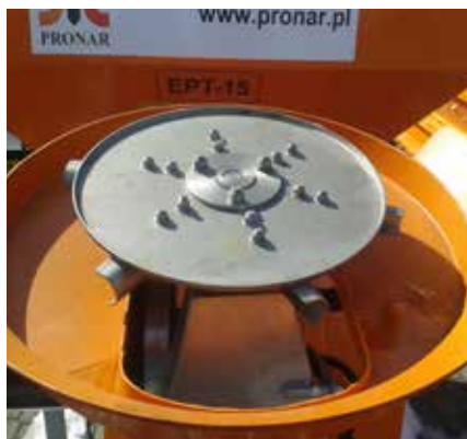
Tarcza rozsiewająca ze stali nierdzewnej
