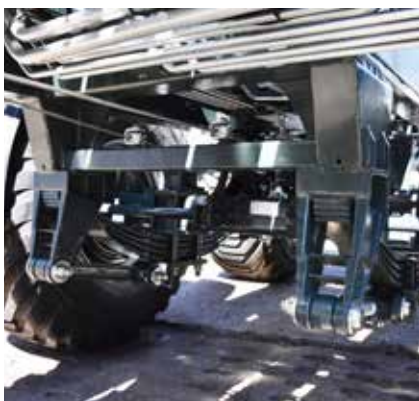
Zawieszenie tandem na resorach parabolicznych
