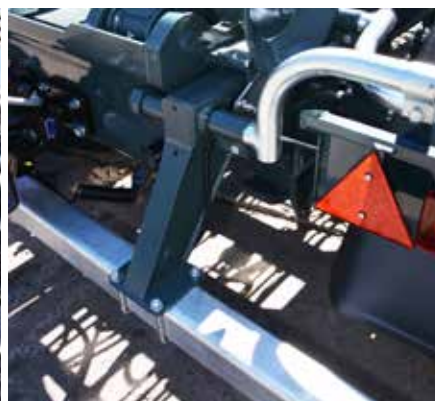
Zderzak tylny wysuwany hydraulicznie
