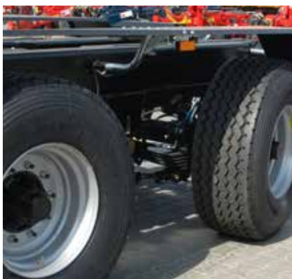
Zawieszenie z tylną osią skrętną kierowaną biernie
