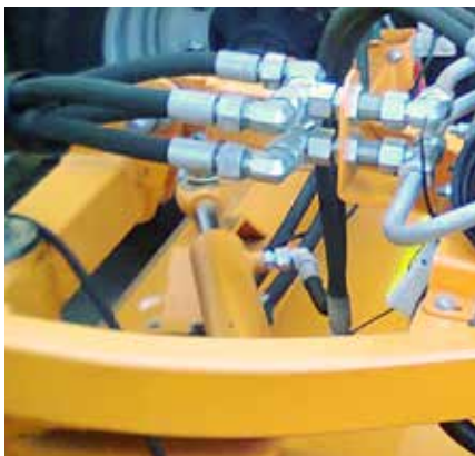
Hydrauliczny skręt szczotki \pm 30^\circ
