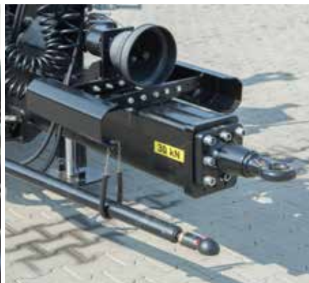
Hydrauliczny układ skretu – siłowniki dwustronnego działania po prawej stronie dyszla
