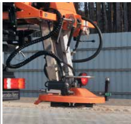
Regulowana wysokość adaptera rozsiewającego
