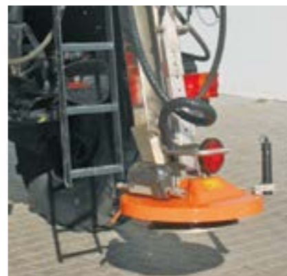
Regulowana wysokość adaptera rozsypującego
