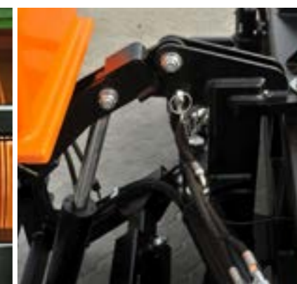
Siłownik hydrauliczny do podnoszenia / opuszczania
