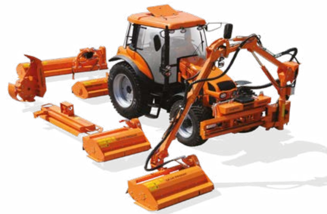
Przesuw hydrauliczny wysięgnika po prowadnicy umożliwiający dobór odpowiedniej pozycji roboczej
