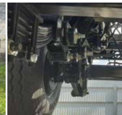
Zawieszenie typu tandem na 4 resorach parabolicznych
