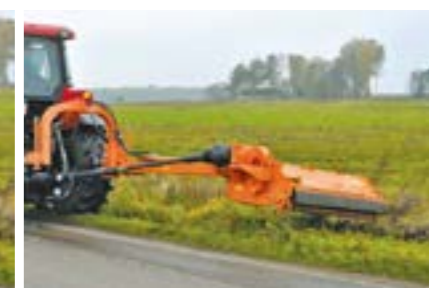
Przesuw hydrauliczny kosiarki 1820 mm pozwala całą szerokością pracować poza obrysem ciągnika
