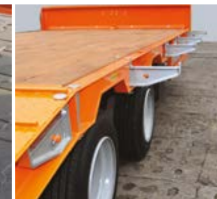
System poszerzania powierzchni ładunkowej (RC2100 i RC2100-1)
