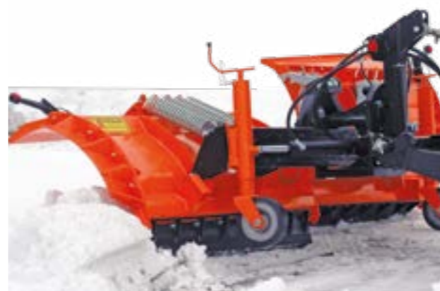
Łamana odkładnica z zabezpieczeniem sprężynowym
