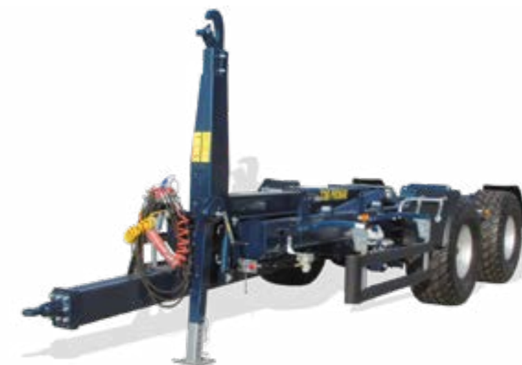
Zawieszenie z tylną osią skrętną kierowaną biernie
