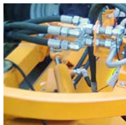
Hydrauliczny skręt szczotki \pm 30^\circ
