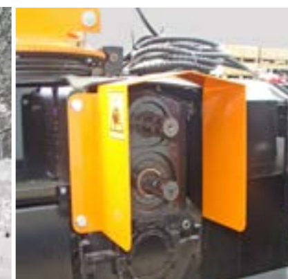
Przekładnia z dwoma końcówkami WOM (540/1000 obr/min)
