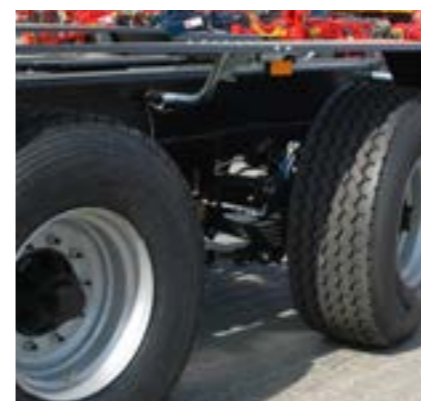
Zawieszenie z tylną osią skrętną kierowaną biernie
