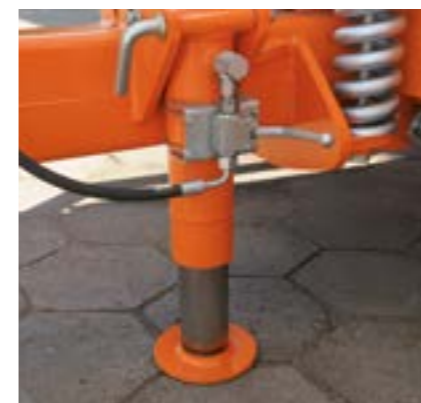
Amortyzowany mechanicznie dyszel i (opcjonalnie) hydrauliczna noga podporowa
