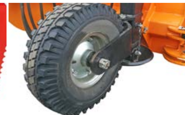
Ślizgi i kółka podporowe do utrzymania dystansu między powierzchnią, a lemieszami (do ograniczenia grubości odgarnianej warstwy)
