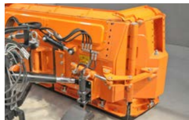
"Hydrauliczna regulacja położenia skrzydła w zakresie -60° do +90°"
