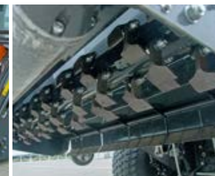
Wał tnący z wymiennymi nożami
