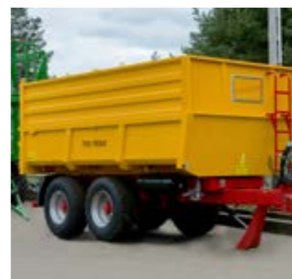
Nadstawy 800 mm powiększające pojemność przyczepy do 16,6 m 3
