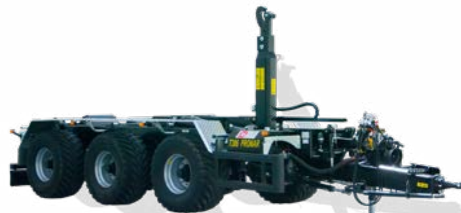
Hydrauliczny układ skrzętu – siłowniki dwustronnego działania po prawej stronie dyszla
