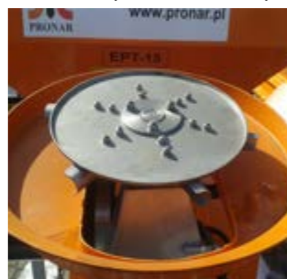
Tarcza rozsiewająca ze stali nierdzewnej
