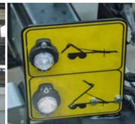
Informacja świetlna przełączania funkcji hakowiec-wywrotka (T185/1)
