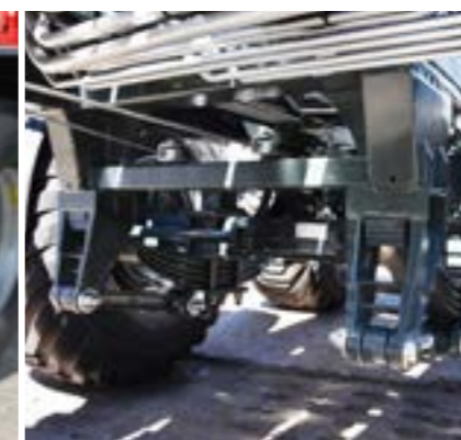
Zawieszenie tandem na resorach parabolicznych
