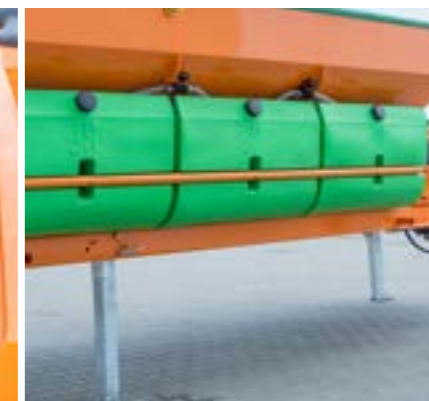
Nogi podporowe o regulowanej wysokości umożliwiające załadunek maszyny na wywrotkę bez użycia dodatkowych urządzeń (system RORO)
