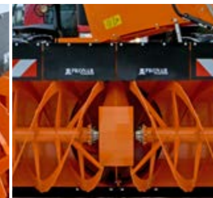
Ślimak frezowy do cięcia zamarzniętego śniegu i lodu. Wysokość robocza 1,2m
