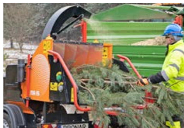
Rampa załadownicza i pałak bezpieczeństwa
