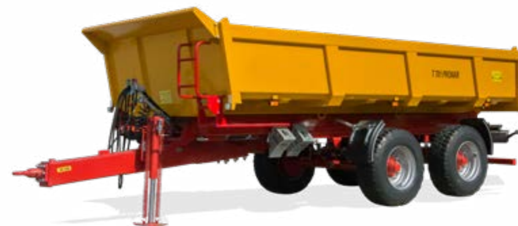
Nadstawy 800 mm powiększające pojemność przyczepy do 16,6 m 3
