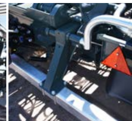
Zderzak tylny wysuwany hydraulicznie
