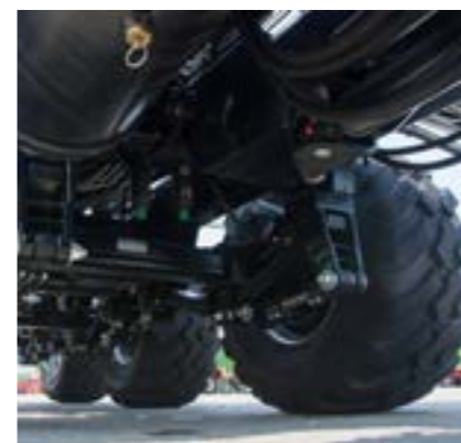
Zawieszenie tridem na resorach parabolicznych, z wahaczami wyrównawczymi
