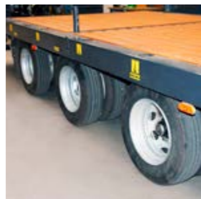
Zawieszenie trzyosiowe, mechaniczne na resorach parabolicznych
