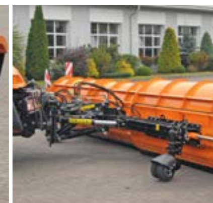
Sposób mocowania – Płyta komunalna DIN76060 typ A
