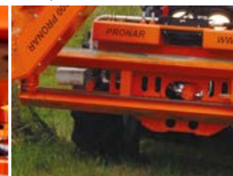
Przesuw hydrauliczny wysięgnika po prowadnicy umożliwiający dobór odpowiedniej pozycji roboczej
