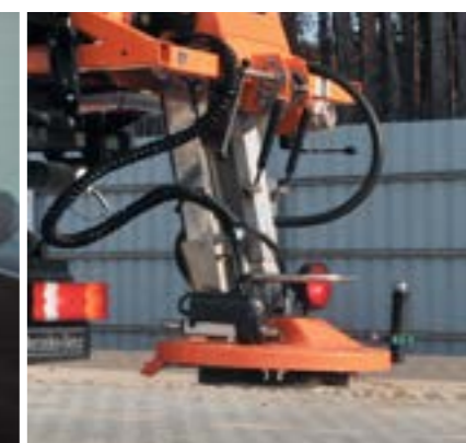
Regulowana wysokość adaptera rozsiewającego
