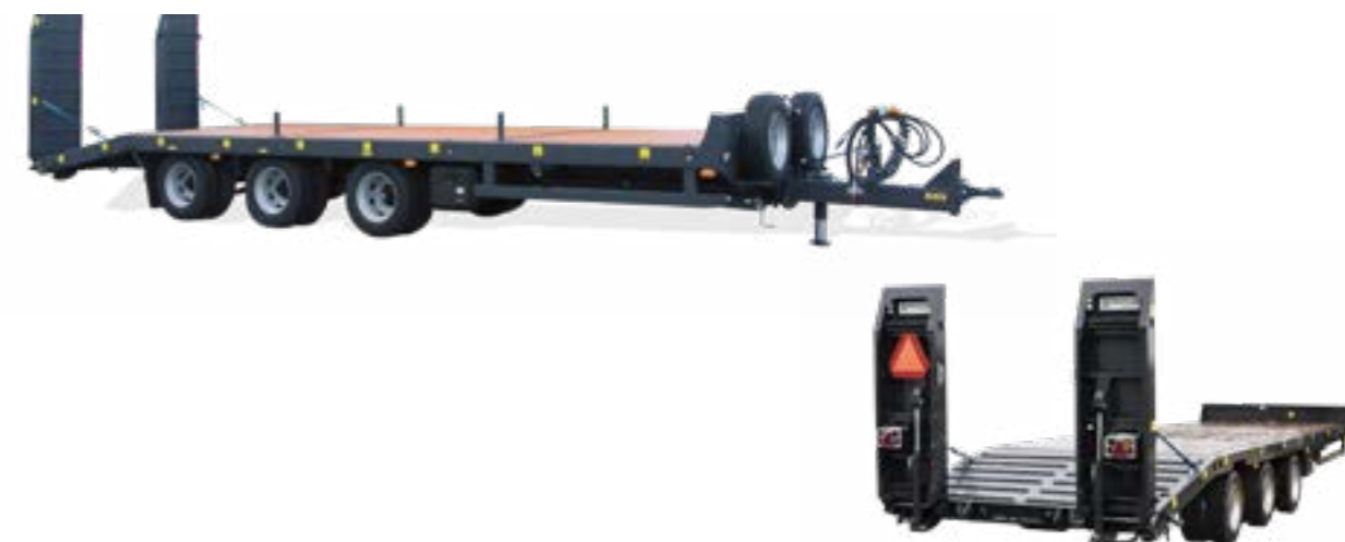
Zawieszenie trzyosiowe, mechaniczne na resorach parabolicznych
