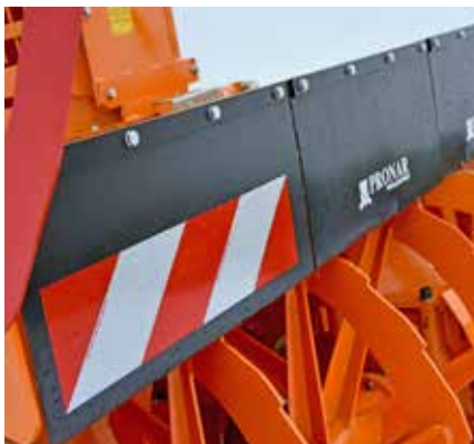
Gummischutzabdeckung als Schneestaub- schutz
