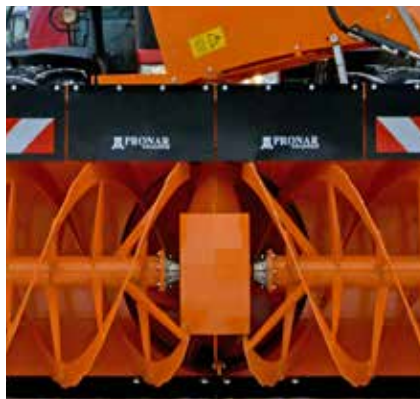
Die Fräseschnecke dient sowohl zur Räu- mung von Eis als auch Schnee
