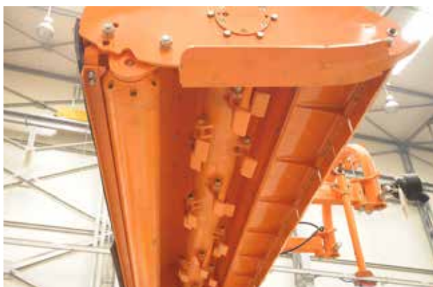
Arbeitswelle mit Hammerschlegeln
