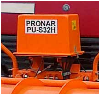
Powerpack und eigenes Fahrlicht
