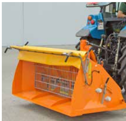
Das Schutzgitter sorgt für eine korrekte Größe des Streumaterials
