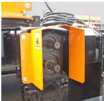
Getriebe mit zwei Zapfwellenbolzen (540/1000 U/min)
