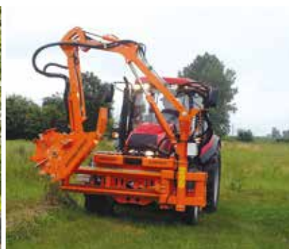
WWP-600 Frontausleger - Mit hydraulischer Armführungsschiene
