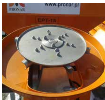
Streuteller aus rostfreiem Stahl
