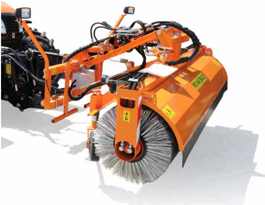
Hydraulische Winkeleinstellung \pm 30^\circ
