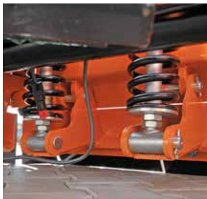
Federung der Räumleisten
