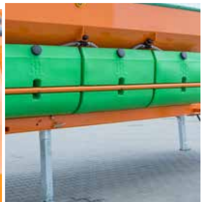
Höhenverstellbare Stützfüße zum Verladen der Maschine auf einen Kipper, ohne Einsatz von Zusatzgeräten (RO-RO-System)
