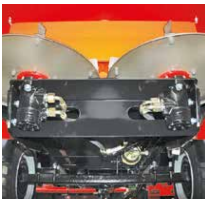
2 Streuadapter aus rostfreiem Stahl
