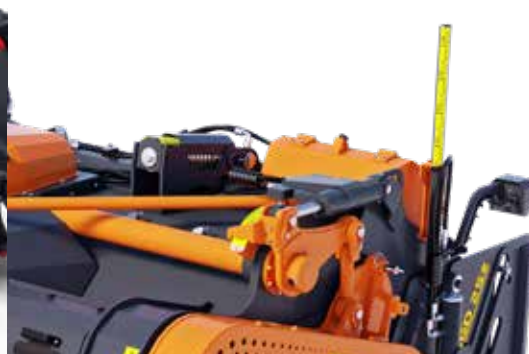
Hubmechanismus der Welle zur Veränderung des Mischkammervolumens
