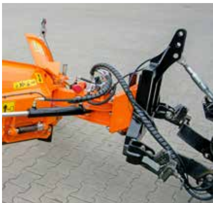
Befestigung an diversen Fahrzeugträger nach Kundenwunsch
