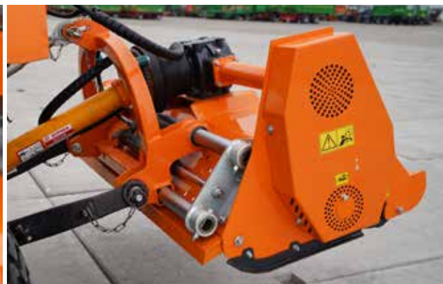
Mobiles Anhängesystem (350 mm hydraulischer seitlicher Versatz)
