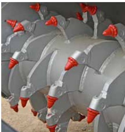
Zähne zur Bodenauflockerung
