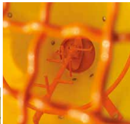
Sieb und Rührwerk im Trichter
