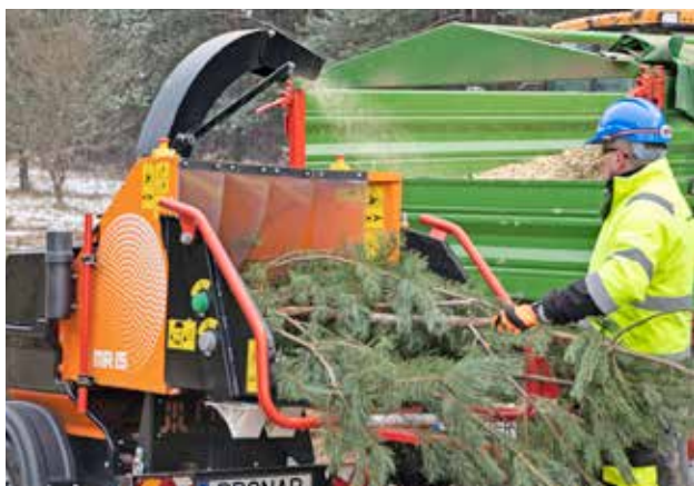
Einfülltrichter mit Sicherheitsbügel
