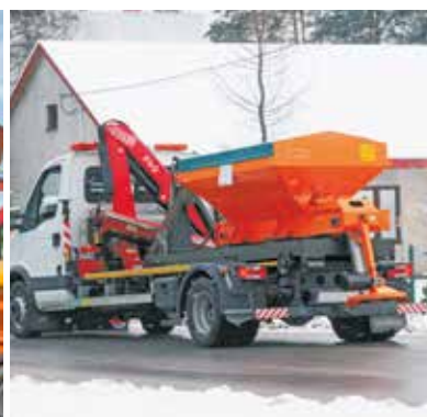
EPT Streuer koennen mit Abrollkippern betrieben werden
