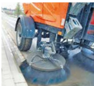
Wassersprüheinrichtung vor den Tellerbürsten
