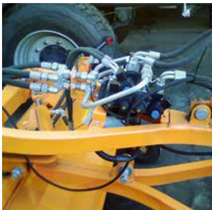
Hydraulische Winkeleinstellung \pm 30^\circ
