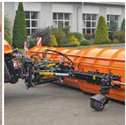
Anbauplatte nach DIN 76060 vom Typ A
