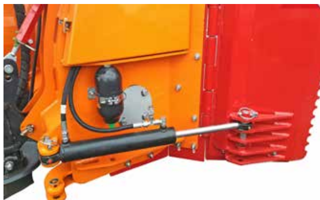
Hydraulische Steuerung der Verbreitung
