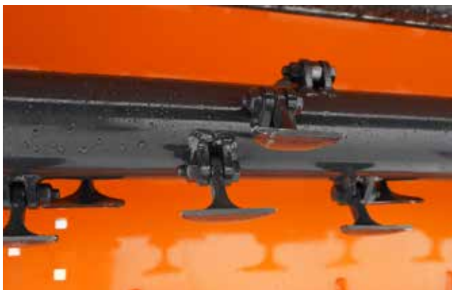
Schlegelrotor mit austauschbaren Blättern
