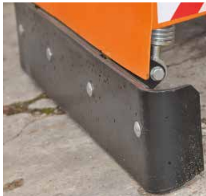
Metallschürfleiste mit Stoßdämpfung
