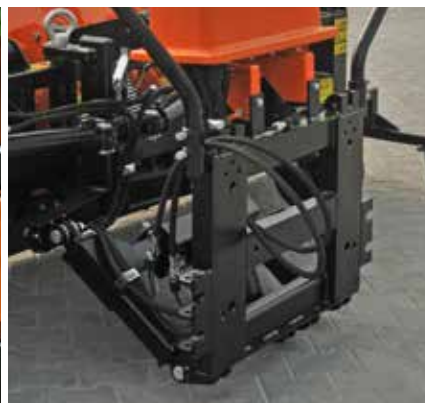
Montage - Kommunalplatte DIN Typ A
