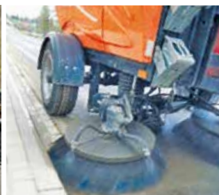
Wassersprüheinrichtung vor den Tellerbürsten
