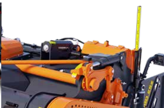
Hubmechanismus der Welle zur Veränderung des Mischkammervolumens
