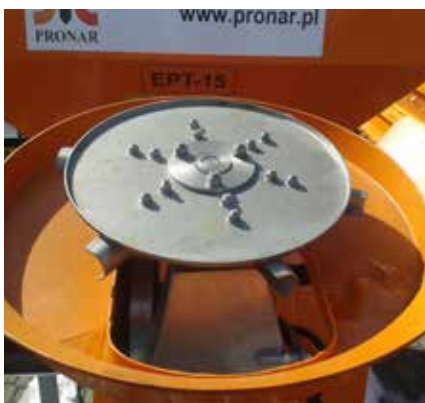
Streuteller aus rostfreiem Stahl
