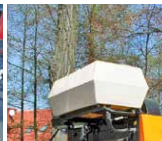
Zusätzlicher Wasserbehälter (200 dm³)
