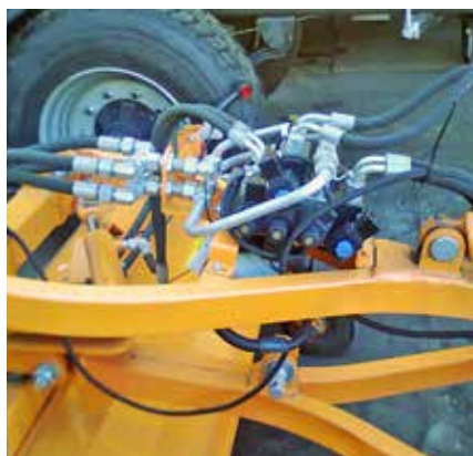
Hydraulische Winkeleinstellung \pm 30^\circ
