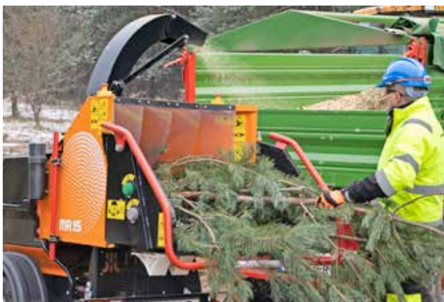
Einfülltrichter mit Sicherheitsbügel
