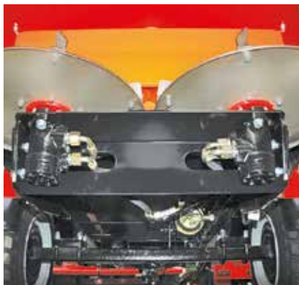
2 Streuadapter aus rostfreiem Stahl
