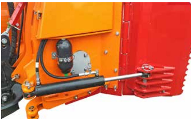
Hydraulische Steuerung der Verbreitung
