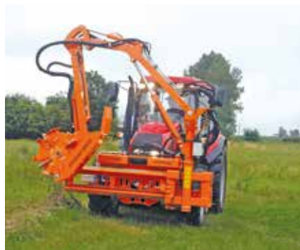
WWP-600 Frontausleger - Mit hydraulischer Armführungsschiene
