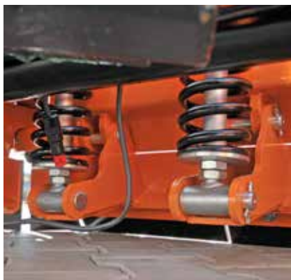
Federung der Räumleisten
