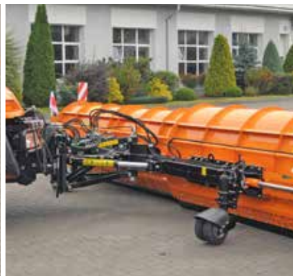
Anbauplatte nach DIN 76060 vom Typ A
