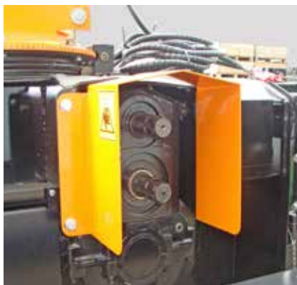
Getriebe mit zwei Zapfwellenbolzen (540/1000 U/min)
