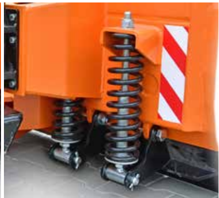
Federsicherung der Schürfleisten
