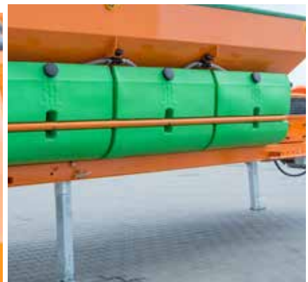
Höhenverstellbare Stützfüße zum Verladen der Maschine auf einen Kipper, ohne Einsatz von Zusatzgeräten (RORO-System)
