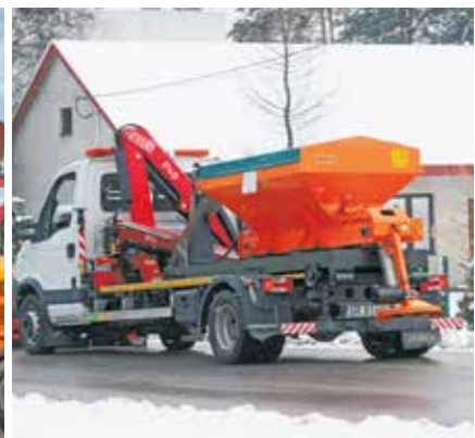
EPT Streuer koennen mit Abrollkippern betrieben werden
