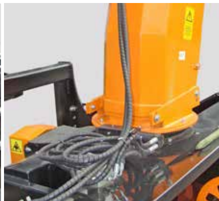
Hydraulische Drehung des Auswurfkamins und Regulierung der Auswurfweite
