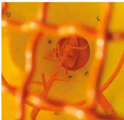
Sieb und Rührwerk im Trichter
