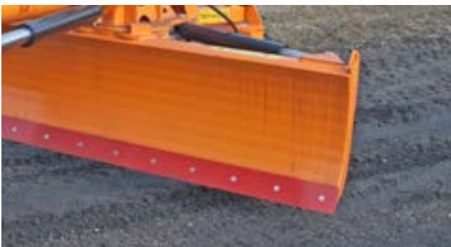
Straßengrader mit Schürfleiste aus verschleißfestsen Hardox-Stahl
