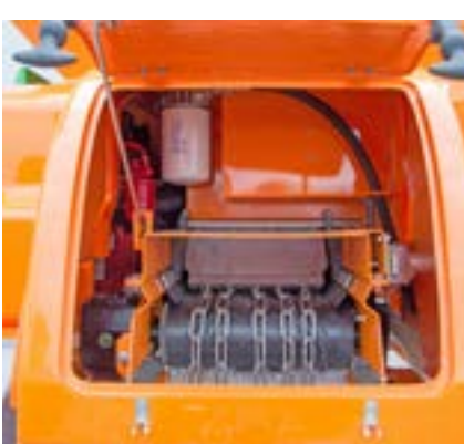
Material wird über ein Förderband zum Beschickungssystem transportiert
