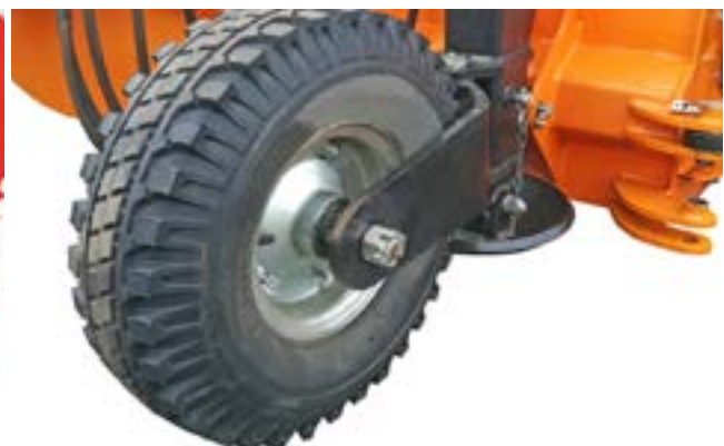
Gleitkufen und Stützräder garantieren ideale Arbeitsposition
