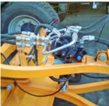
Hydraulische Winkeleinstellung \pm 30^\circ
