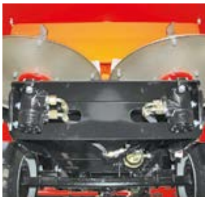
2 Streuadapter aus rostfreiem Stahl
