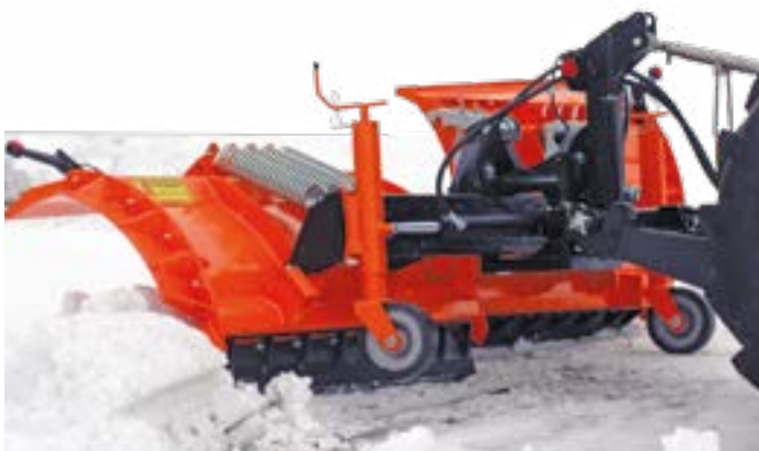
Geteilte Schürfleiste mit Federsicherung
