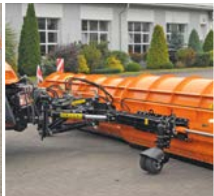
Anbauplatte nach DIN 76060 vom Typ A
