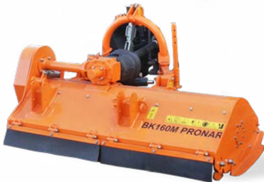
Arbeitswelle mit Hammerschlegeln
