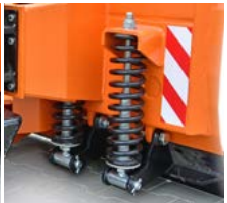
Federsicherung der Schürfleisten
