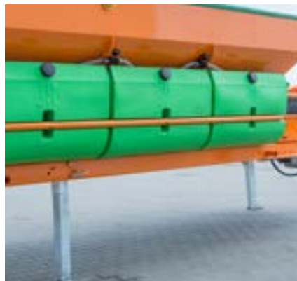
Höhenverstellbare Stützfüße zum Verladen der Maschine auf einen Kipper, ohne Einsatz von Zusatzgeräten (RORO-System)
