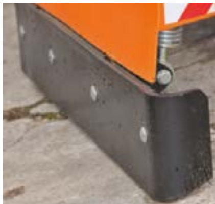
Metallschürfleiste mit Stoßdämpfung
