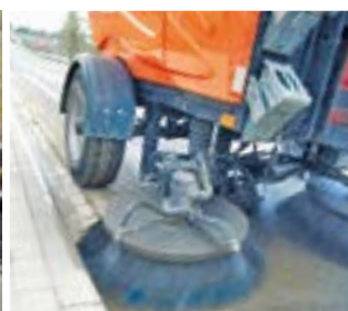
Wassersprüheinrichtung vor den Tellerbürsten
