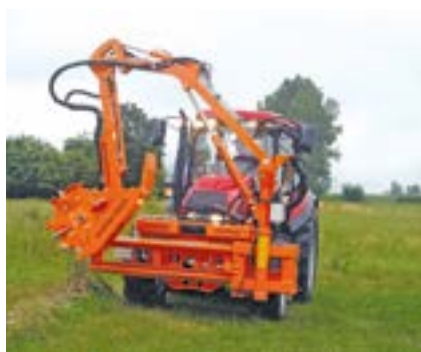
WWP-600 Frontausleger - Mit hydraulischer Armführungsschiene
