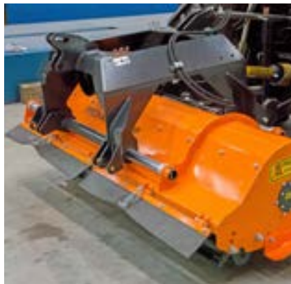
Dreipunktaufhängung der Kat. I oder II für Front- und Heckanbau)
