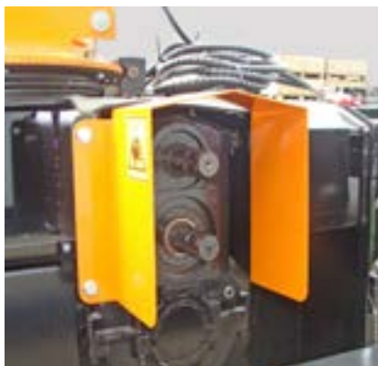
Getriebe mit zwei Zapfwellenbolzen (540/1000 U/min)
