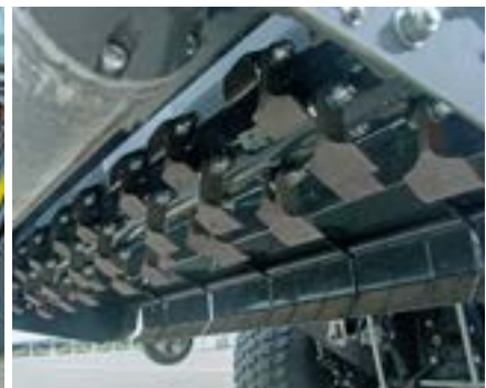
Schneideinheit - Schlegelwelle mit austauschbaren Messern
