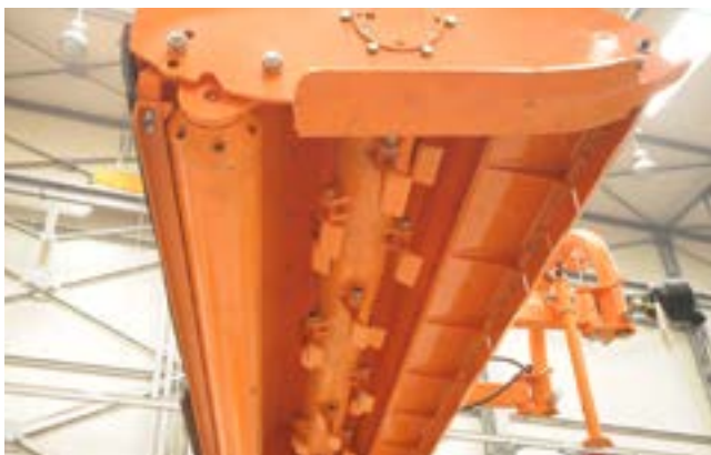
Arbeitswelle mit Hammerschlegeln
