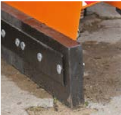
Gummisschürfleiste mit Stoßdämpfung
