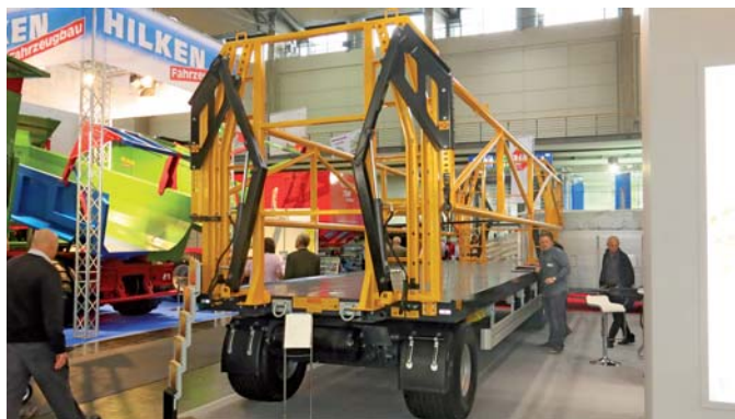
Wielton na swoim stoisku wystawił przyczepę do przewozu bel ze ścianami podnoszonymi i opuszczanymi hydraulicznie.
