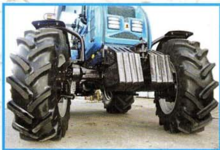
Przedni most napędowy typu belkowego z reduktorami planetarnymi.
