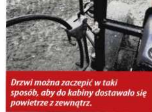
Drzwi można zaczeplić w taki sposób, aby do kabiny dostawało się powietrze z zewnątrz.
