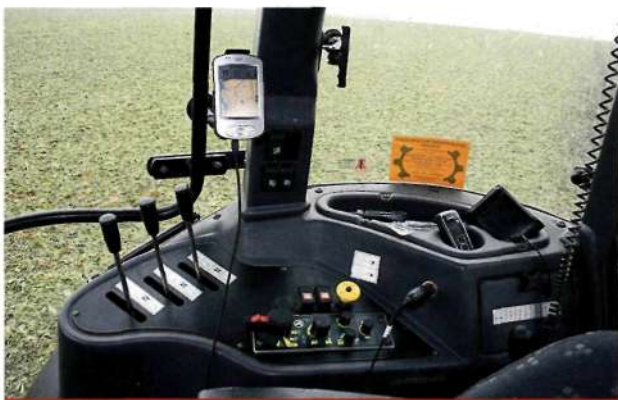
Obsługa tylnego TUZ-u w Pronarze 5135 nie jest męcząca, bo sterowanie tym podzespołem odbywa się z pomocą systemu EHR firmy Bosch.
