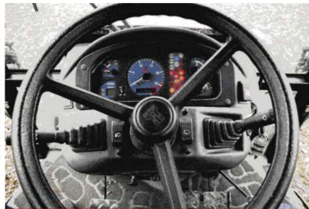
Na jednym z wyświetlaczy po przekręceniu kluczyka w stacyjce wyświetla się liczba motogodzin, a kiedy ruszymy, ukazuje się informacja o aktualnej prędkości jazdy.
