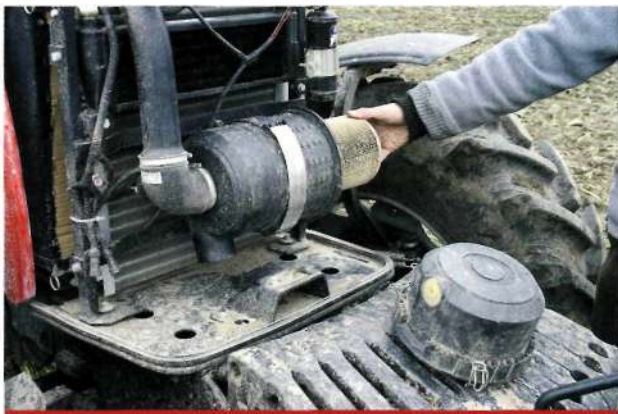
Dostęp do filtra powietrza również jest łatwy, ale Janusz Czekala umieściłby go wyżej, aby wciągnął mniej pyłu.
